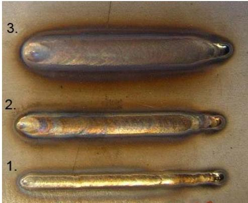
Tablica 15. prikazuje parametre navarivanja i izgled navara na ploči 4. Zaštitni plin mješavina argona i 7,5 % vodika (oznaka I4).
