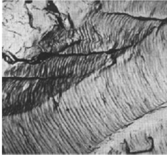
Slika 2.6 Brazde nastale kod zamornog loma
