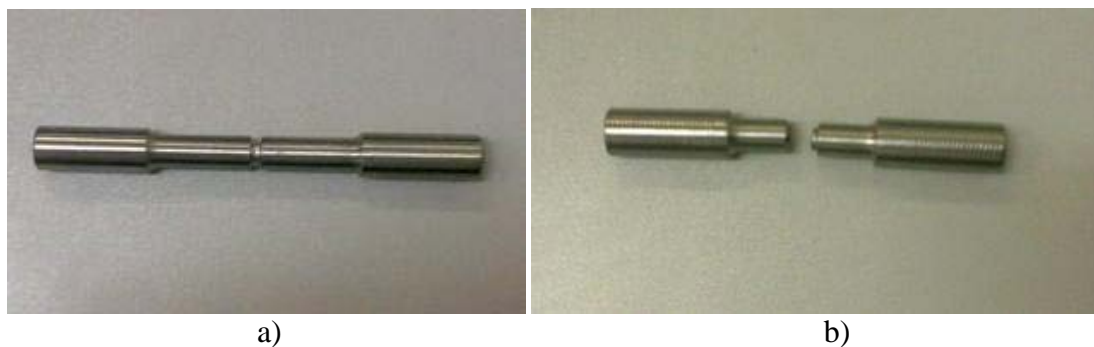
Slika 6.4 Napolirana epruveta a) prije ispitivanja, b) nakon ispitivanja
