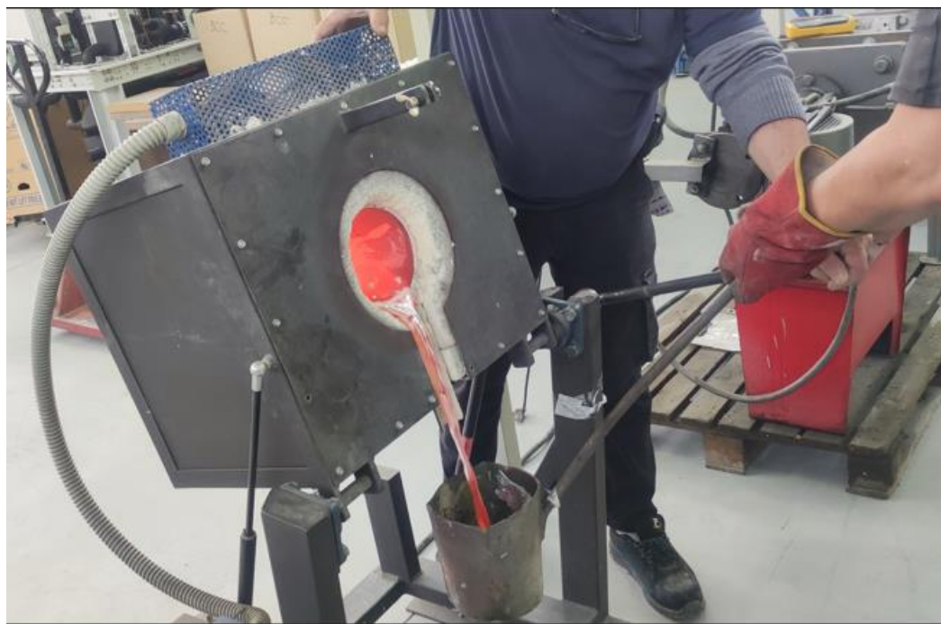
Slika 64. Ulijevanje u ljevački lonac
