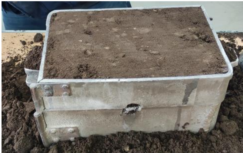
Slika 58. Poravnavanje kalupne mješavine u donjaku
