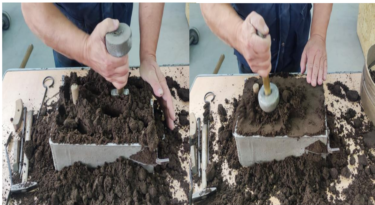
Slika 54. Sabijanje kalupne mješavine
