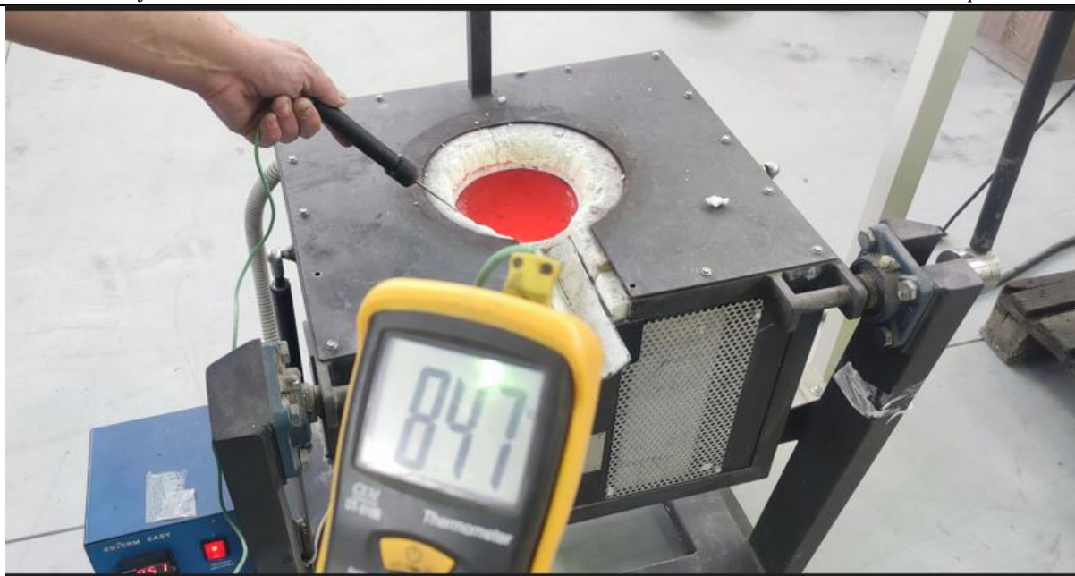
Slika 63. Mjerenje temperature taline
