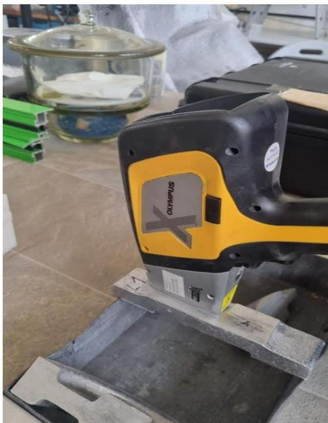
Slika 6.18 Određivanje kemijskog sastava odljevka XRF metodom
