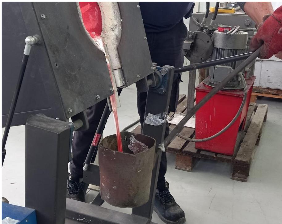
Slika 6.13 Izljevanje taljevine iz peći u uljevni lonac
