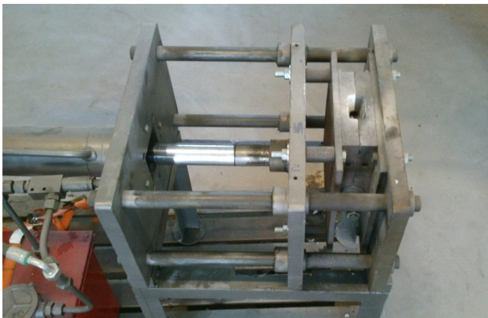
Slika 6.4 Hidraulički mehanizam za otvaranje i zatvaranje
