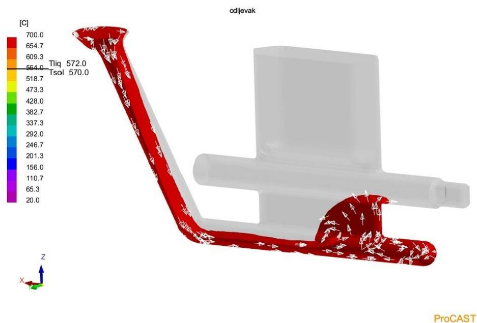
Slika 5.19 Početak ulijevanja taljevine s uključenim prikazom strujnica
