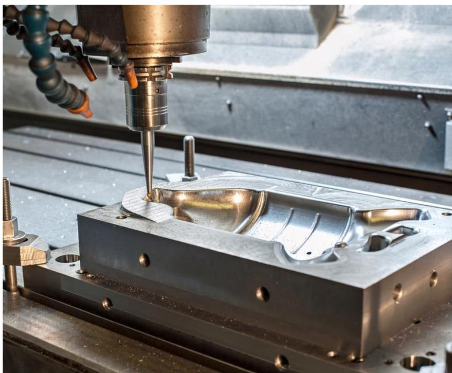
Slika 3.7 CNC obrada kalupne šupljine [18]
