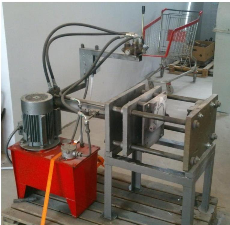
**Slika 6.3** Stroj za kokilno lijevanje, Laboratorij za ljevarstvo
