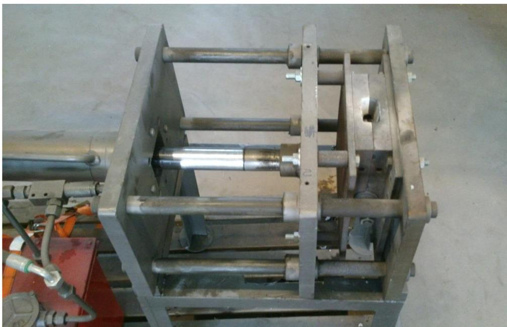
**Slika 6.4** Hidraulički mehanizam za otvaranje i zatvaranje
