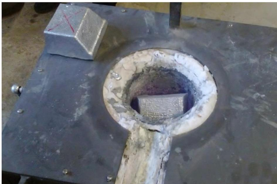
Slika 6.6 Taljenje aluminijskih ingota
