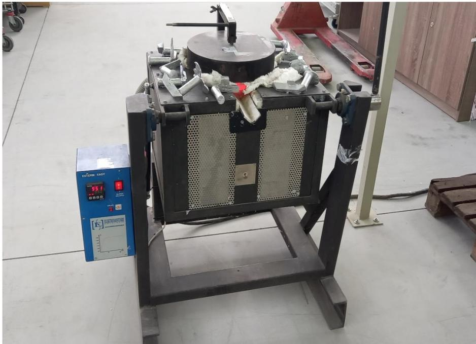
Slika 6.5 Elektrootporna peć
