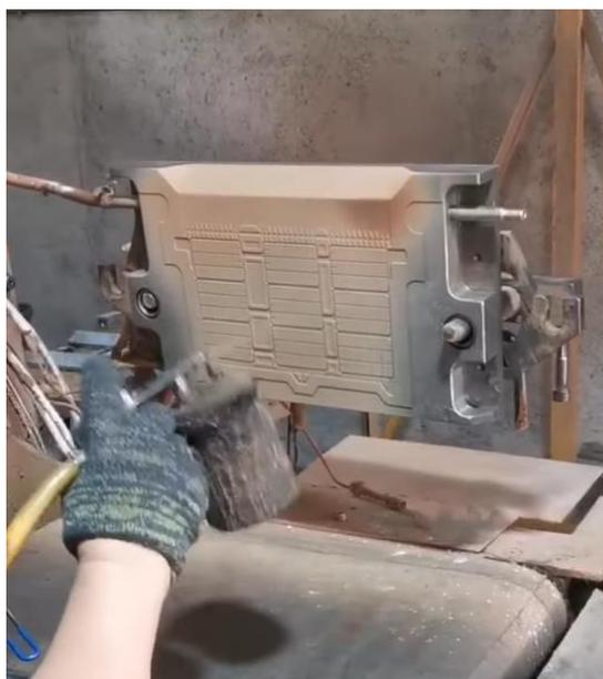
Slika 3.10 Nanošenje premaza zračnim prskanjem [17]
