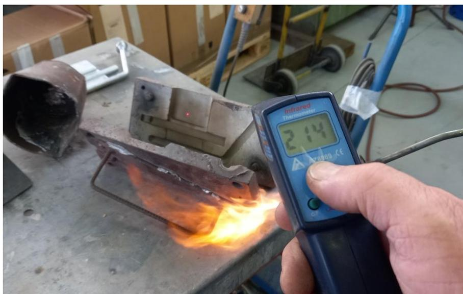
Slika 6.10 Mjerenje temperature (slikano za vrijeme zagrijavanja)
