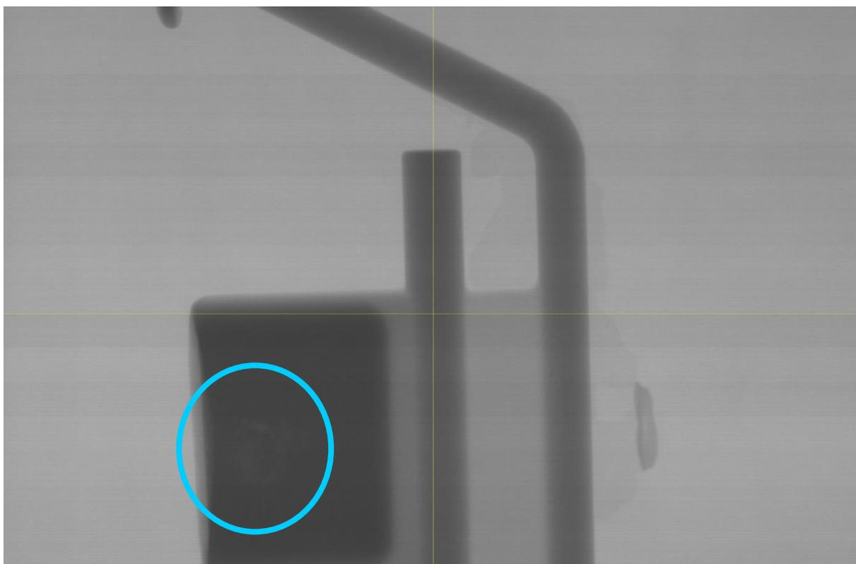
**Slika 6.17 Radiogram odljevka s uljevnim sustavom**
