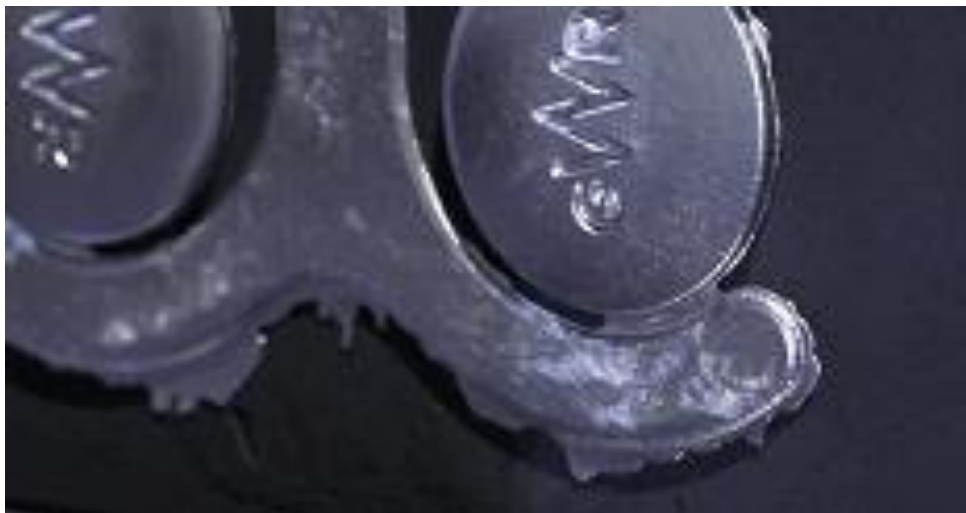
Slika 3.15 Srh na odljevku [21]
