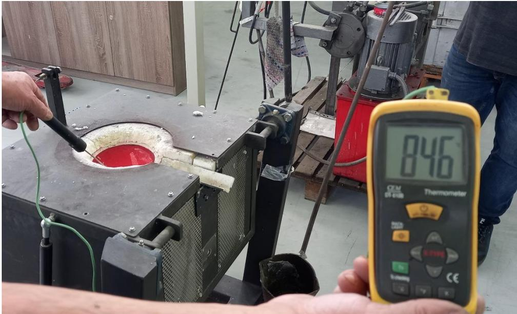
**Slika 6.7 Mjerenje temperature**
