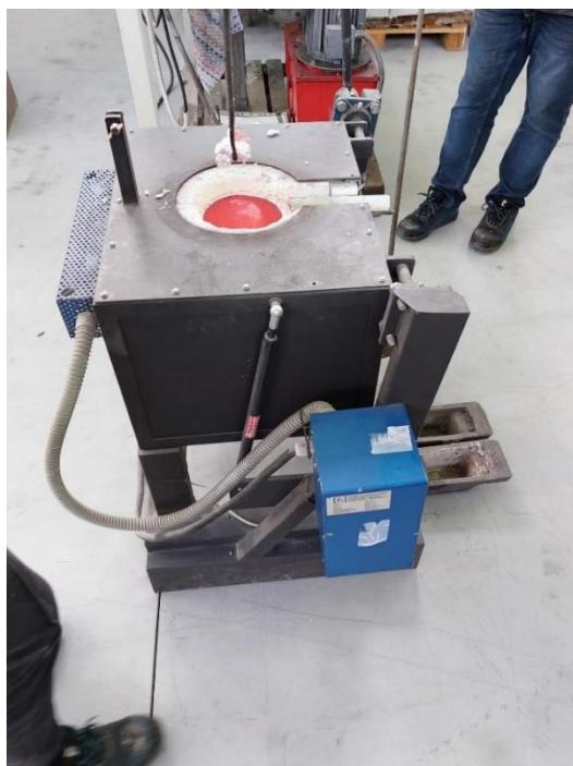
**Slika 41. Skidanje oksida i nečistoće s površine taline**
