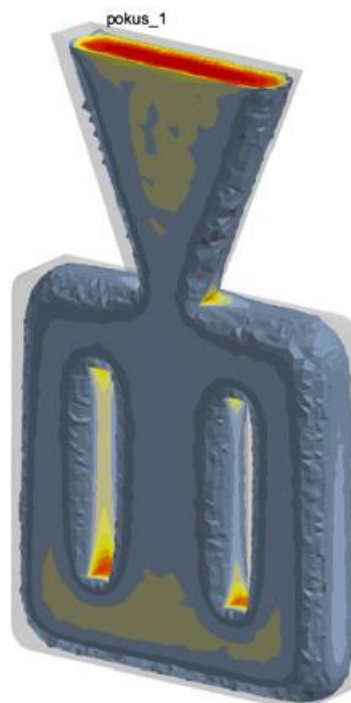
Slika 29. Potpuno skrućivanje rubnih dijelova taline
