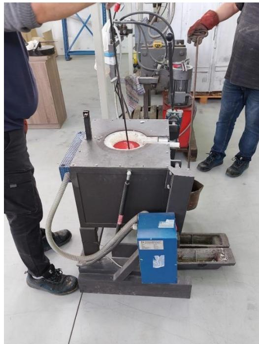
**Slika 40. Elekrootporna peć za taljenje metala**
