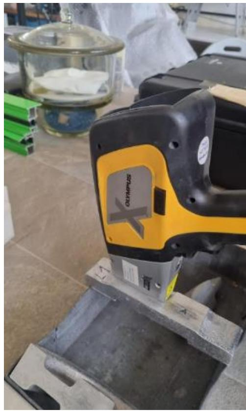
**Slika 50. Mjerenje kemijskog sastava odljevka XRF metodom**
