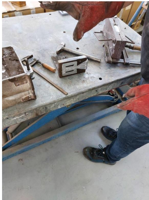
**Slika 48. Otvorena kokila s odljevkom**
