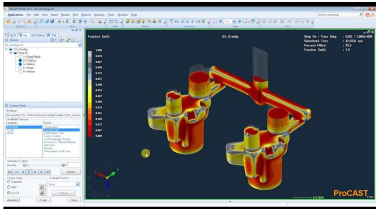
**Slika 15. Primjer simulacije gravitacijskog lijeva u softveru ProCast [35]**
