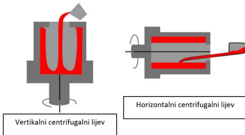
Slika 6. Centrifugalni lijev [14]
