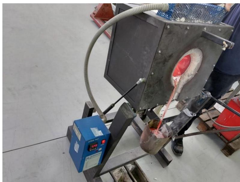
Slika 43. Ulijevanje taline iz peći u lonac za lijevanje
