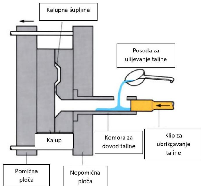
Slika 5. Tlačni lijev [12]
