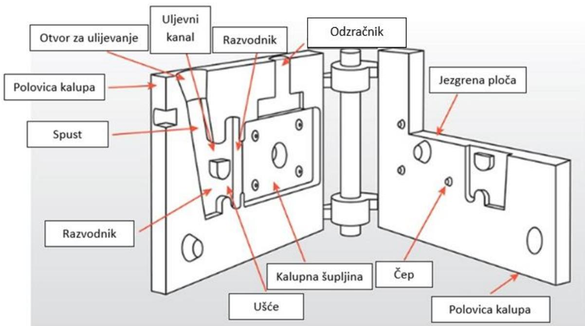
**Slika 9. Primjer kalupa za kokilni lijev [15]**
