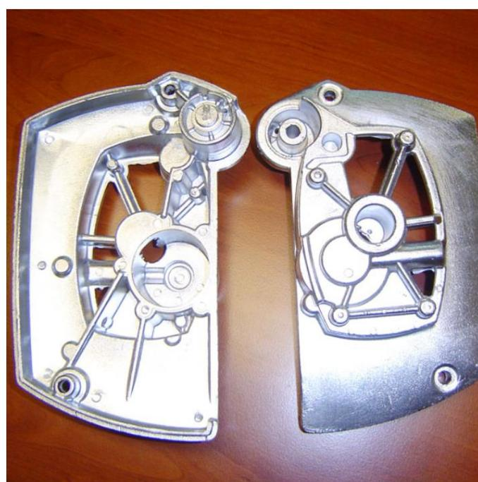
Slika 11. Odljevak od aluminijske legure AlSi12 [25]
