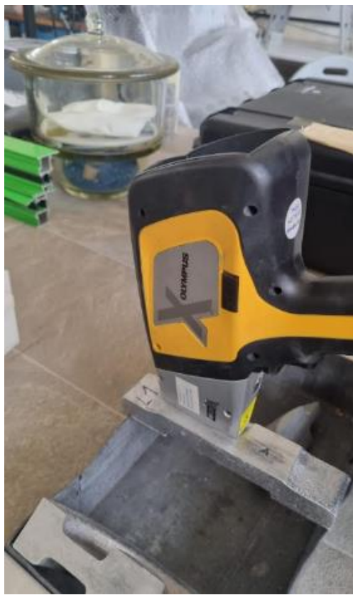
Slika 50. Mjerenje kemijskog sastava odljevka XRF metodom
