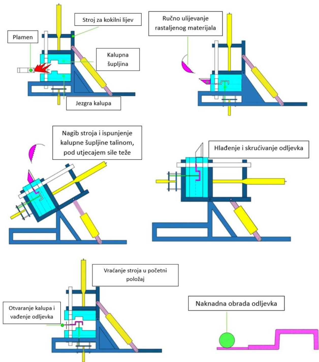
Slika 10. Koraci postupka lijevanja nagibnim kokilnim lijevom [21]
