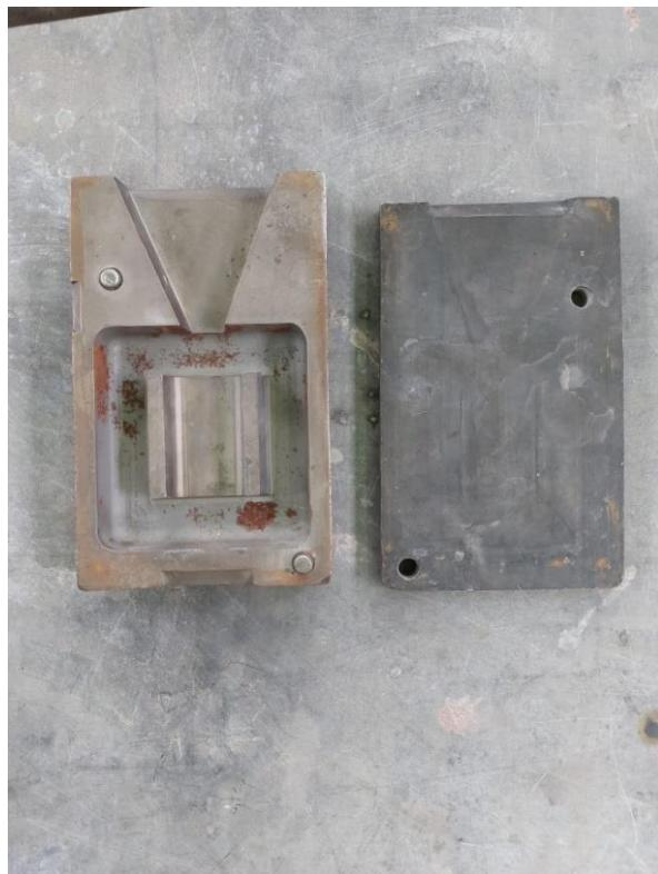
**Slika 37. Kokila korištena za lijevanje**
