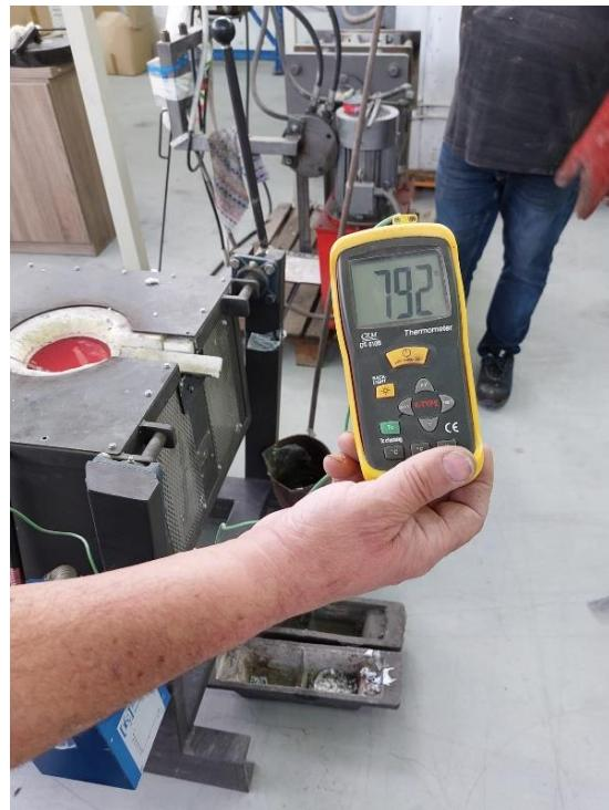
Slika 42. Postignuta temperatura taline u peći
