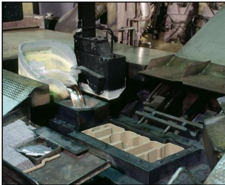
Slika 8. Automatizirano ulijevanje rastaljenog materijala u kalupnu šupljinu [17]
