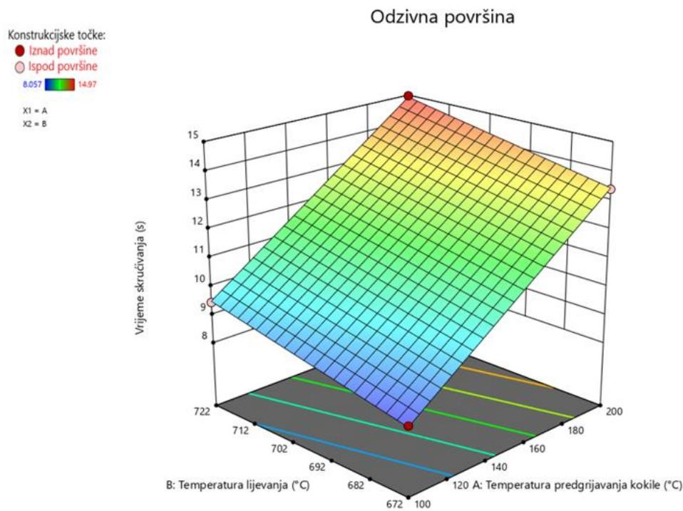
**Slika 33. Odzivna površina vremena do skrućivanja legure AlSi12 s faktorima A- Temperatura predgrijavanja kokile i B- Temperatura lijevanja**
