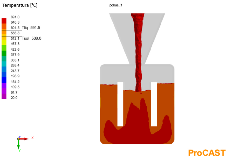
Slika 25. Nastavak punjenja kokile i početak hlađenja taline
