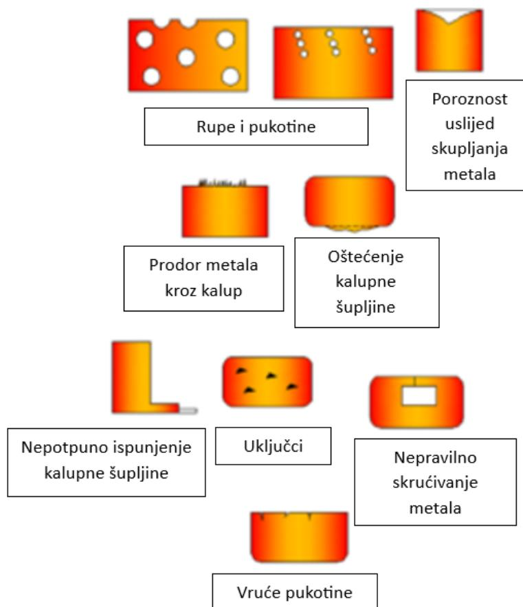
**Slika 13. Najčešće nepravilnosti kod procesa lijevanja [30]**
