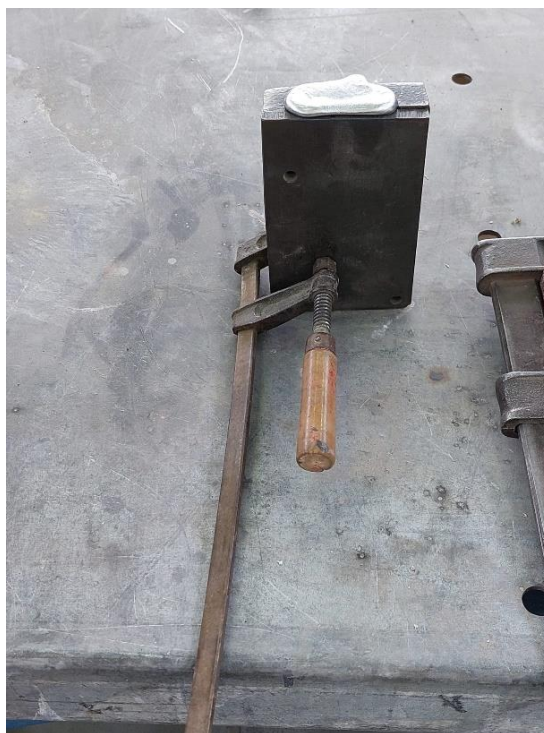
Slika 46. Skrućivanje i hlađenje taline unutar kokile
