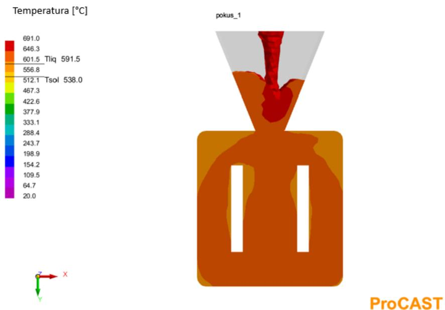
**Slika 26. Ispunjene kalupne šupljine i punjenje uljevnog sustava**
