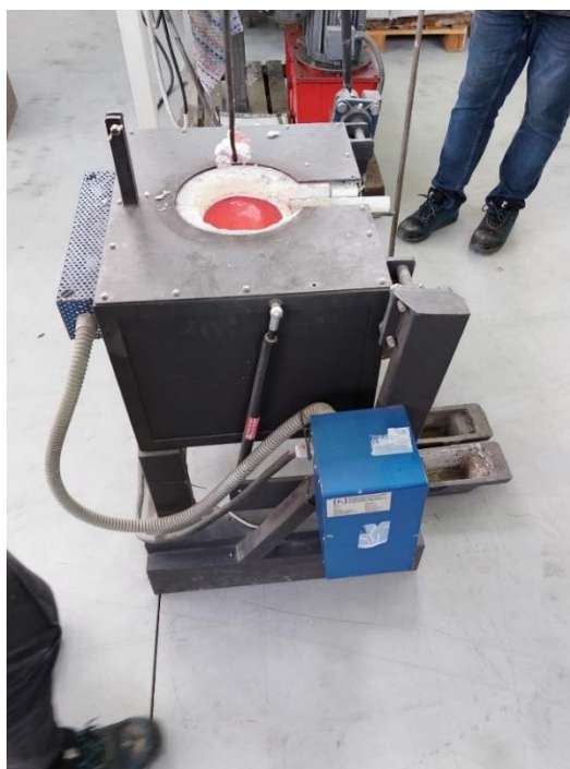
Slika 41. Skidanje oksida i nečistoće s površine taline
