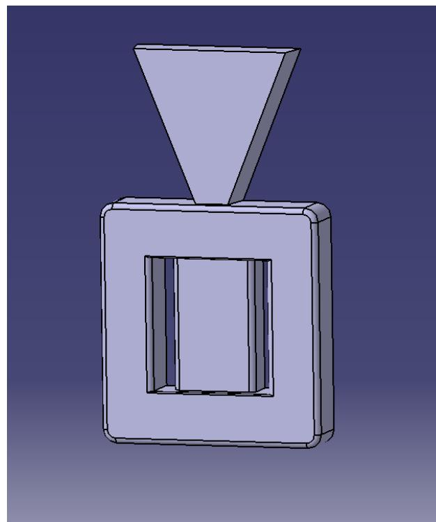
Slika 16. 3D model odljevka od aluminijske legure
