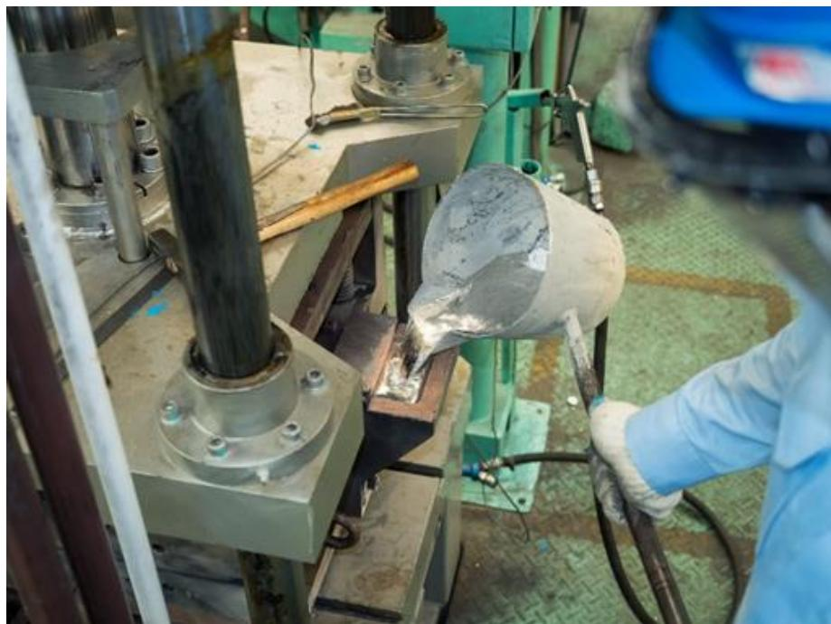
Slika 7. Ručno ulijevanje rastaljenog metala u kalupnu šupljinu [16]
