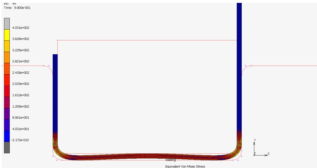
Slika 32. Naprezanja pri udaru lima u matricu
