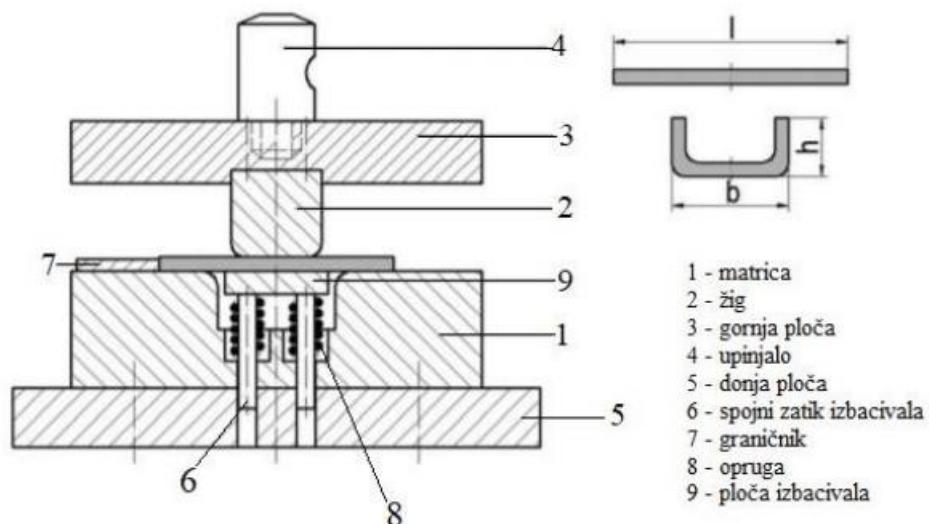
Slika 12. Izvedba alata za simetrične dvostrukе kutnike [11]
