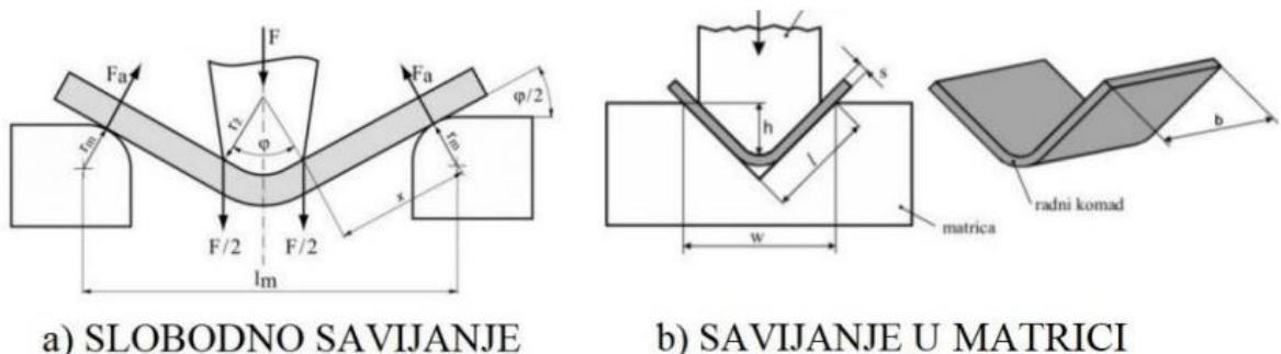
Slika 20. Savijanja V – profila, (a) slobodno savijanje, (b) savijanje u matrici [11]
