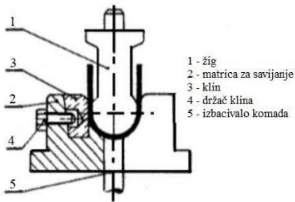
Slika 17. Izvedba alata za savijanje U – profila [1]
