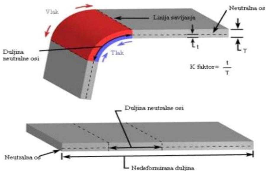
Slika 21. Naprezanja u limu tijekom savijanja [9]
