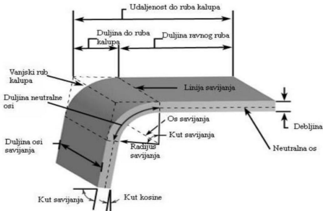
Slika 9. Parametri važni za obradu savijanjem [2]
