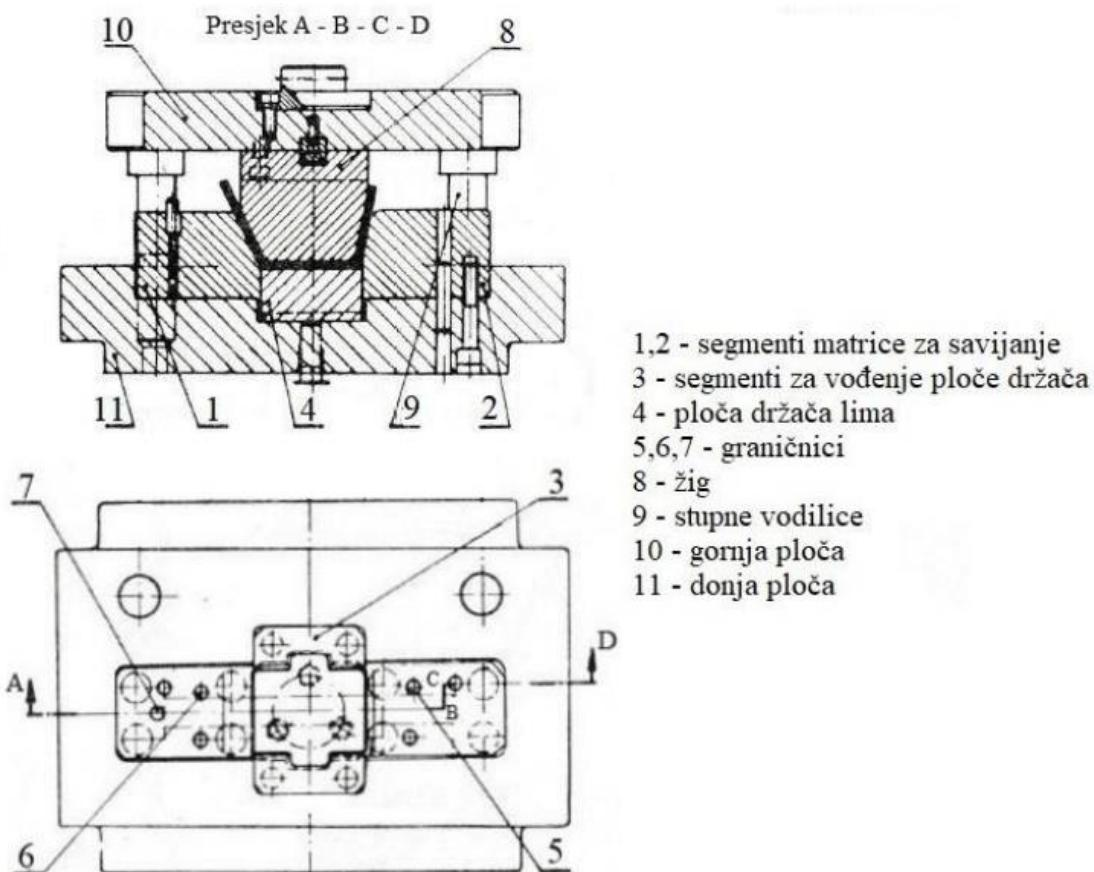
Slika 13. Izvedba alata za nesimetrične dvostrukе kutnike [1]
