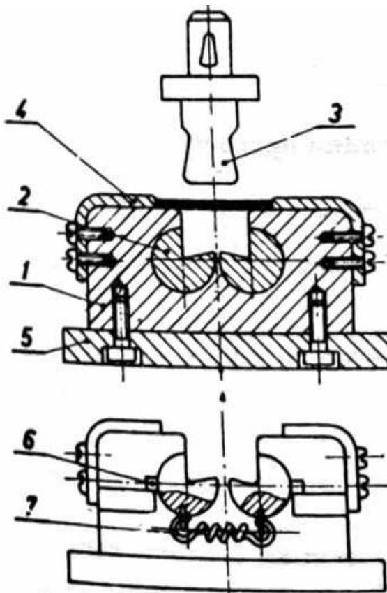
Slika 16. Izvedba alata za oštrotokutno savijanje s rotirajućim valjcima [1]
