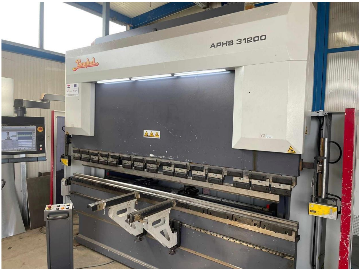
Slika 10.1 APKANT PREŠA BAYKAL APHS 31120 CNC
