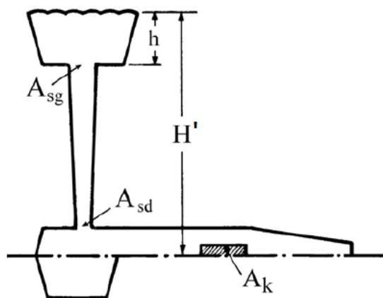
**Slika 46.** Prikaz spusta kod tlačnog uljevnog sustava [2]
