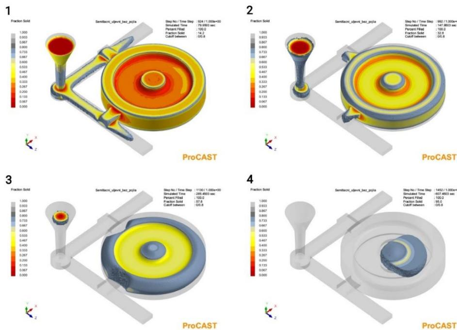
**Slika 58.** Simulacija skrućivanja kod semitlačnog uljevnog sustava bez pojila
