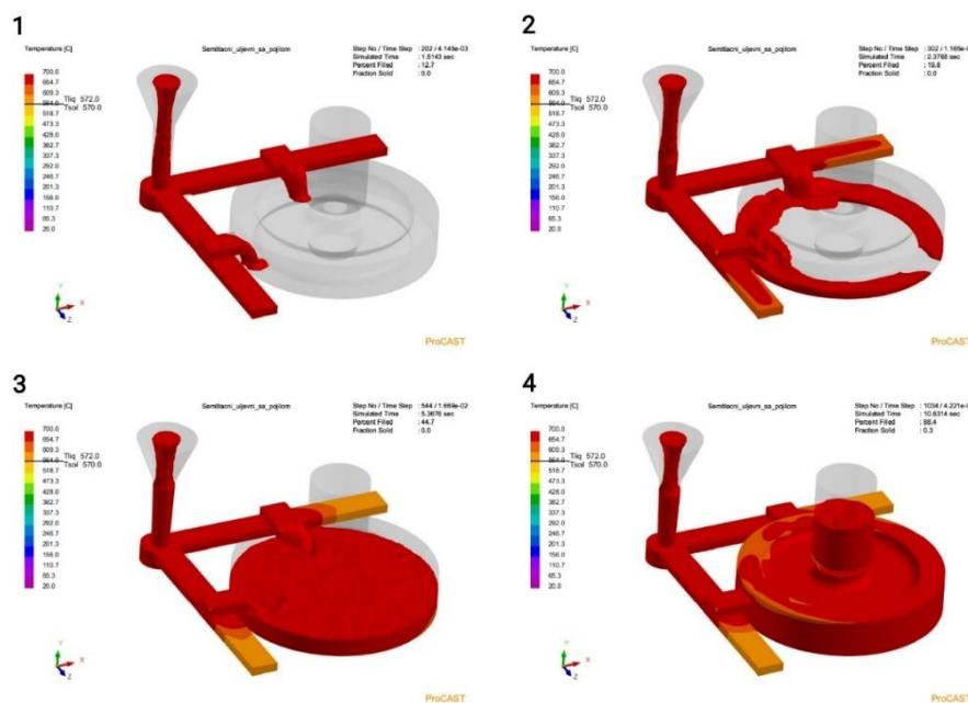
Slika 61. Tijek punjenja kod semitlačnog uljevnog sustava s pojilom
