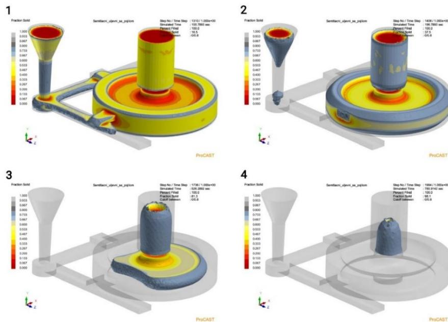
**Slika 62. Simulacija skrućivanja kod semitlačnog uljevnog sustava s pojilom u koracima**
