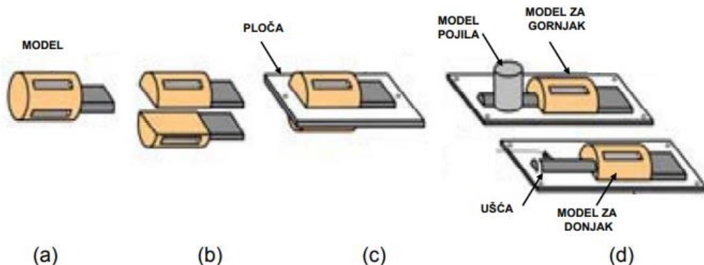
**Slika 3.** Vrste modela za pješčane kalupe: a) jednodijelni model, b) dvodijelni model, c) dvodijelni model na istoj modelnoj ploči za gornjak i donjak, d) model za gornjak na modelnoj ploči za gornjak i model za donjak na modelnoj ploči za donjak [5]
