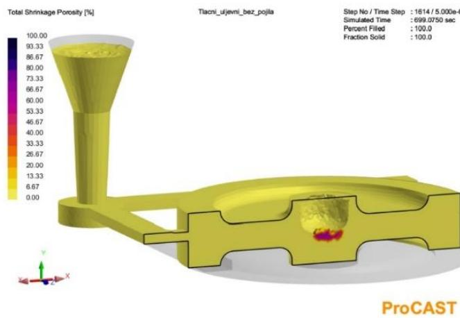
**Slika 51.** Presjek s najvećom poroznosti u odljevku
