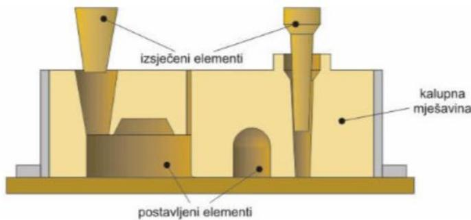
**Slika 7. Vađenje dijelova uljevnog sustava iz kalupa [8]**
