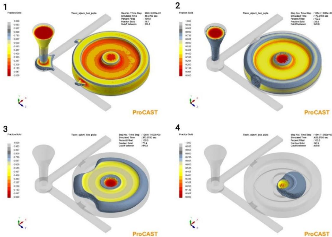
**Slika 50. Simulacija skrućivanja kod tlačnog uljevnog sustava bez pojila u koracima**
