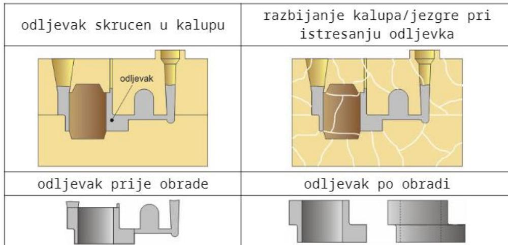
**Slika 10. Postupak dobivanja odljevka nakon skrućivanja metala [8]**
