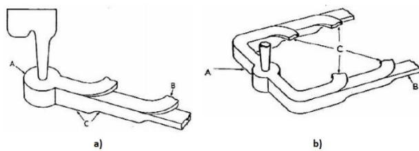
Slika 31. Uljevni sustav: a) s jednim razvodnikom, b) s dva razvodnika [1]
