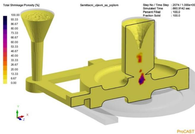
**Slika 64. Presjek najveće pojave poroznosti u modelu semitlačnog uljevnog sustava s pojilom**
