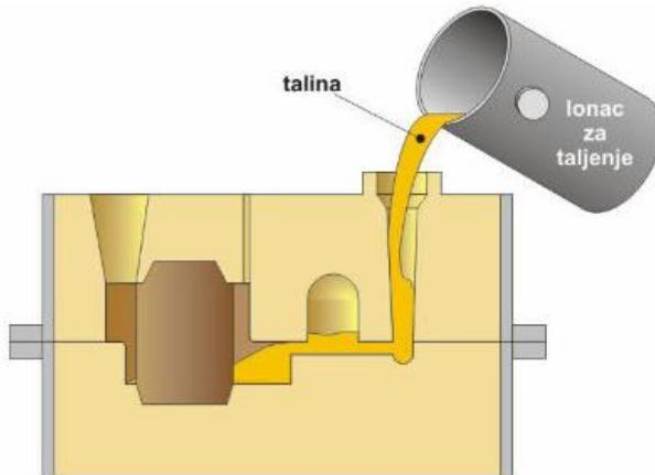
**Slika 9. Ulijevanje rastaljenog metala u kalup [8]**
