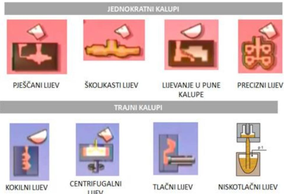
Slika 1. Podjela postupaka lijevanja prema vrsti kalupa [1]
