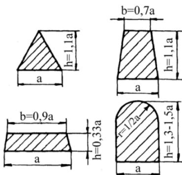
Slika 30. Različiti oblici poprečnog presjeka razvodnika [2]
