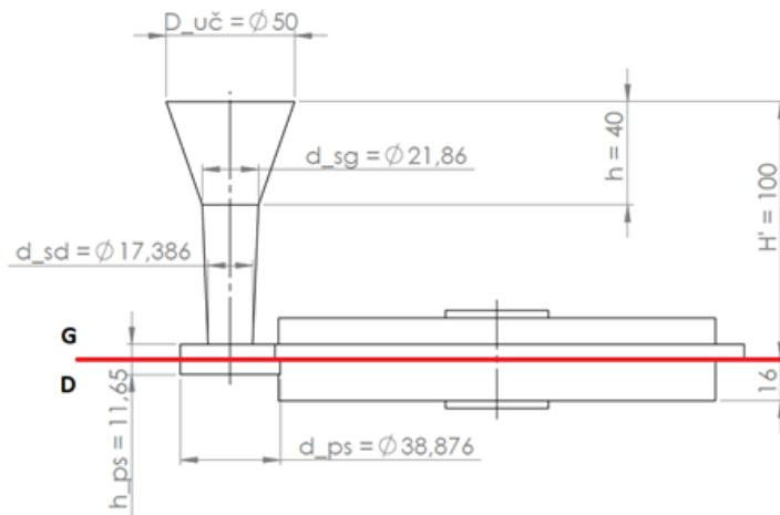
**Slika 47.** Prikaz glavnih kota pri konstruiranju tlačnog uljevnog sustava
