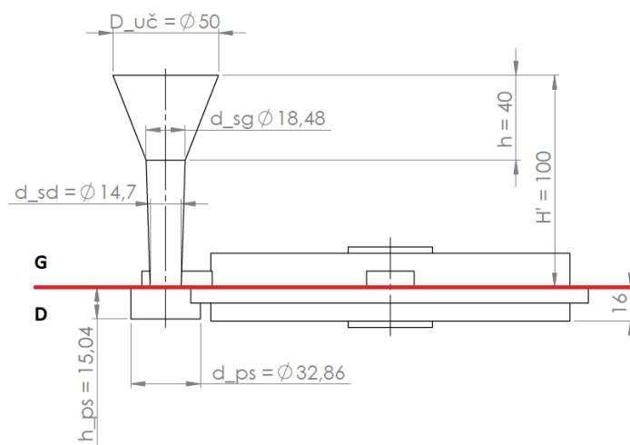
**Slika 48.** Prikaz glavnih kota pri konstruiranju semitlačnog uljevnog sustava
