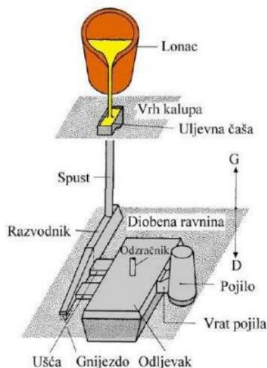
Slika 26. Dijelovi uljevnog sustava [1]
