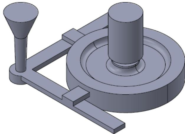
**Slika 57. Semitlačni uljevni sustav bez pojila**
