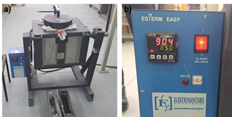
Slika 69. Taljenje: a) peć, b) temperatura peći
