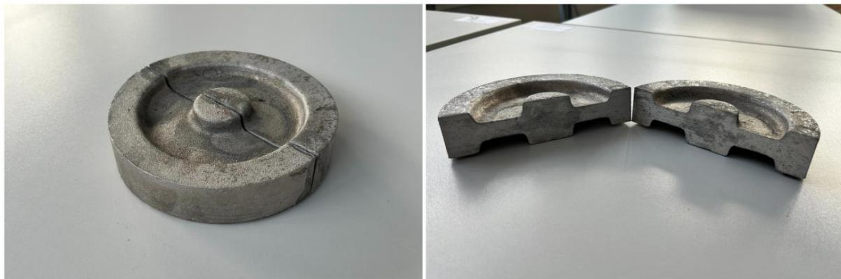
**Slika 75. Presjek odljevka**
