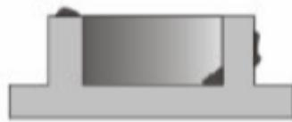
Slika 11. Metalne izrasline na odljevku [8]
