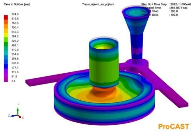
**Slika 55.** Vrijeme potrebno za skrućivanje dijelova modela tlačnog uljevnog sustava s pojilom
