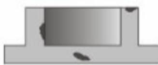
**Slika 17. Uključci i heterogenosti odljevka [8]**
