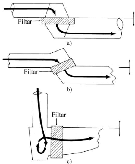
Slika 35. Položaji filtra u uljevnom sustavu: a) paralelno diobenoj ravnini kalupa, b) pod određenim kutom u odnosu na diobenu ravninu kalupa, c) pod kutom od  $90^\circ$  u odnosu na diobenu ravninu kalupa [2]
