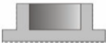
Slika 16. Netočnost mjera i oblika odljevka [8]
