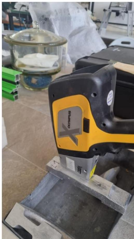
Slika 78. Određivanje kemijskog sastava odljevka XRF metodom
