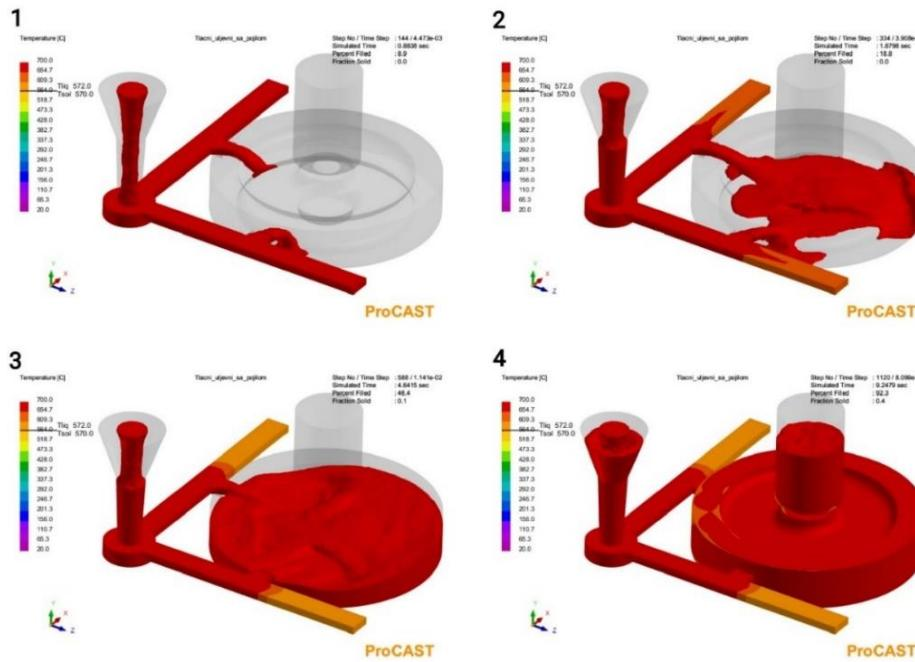
Slika 53. Tijek punjenja kod tlačnog uljevnog sustava s pojilom
