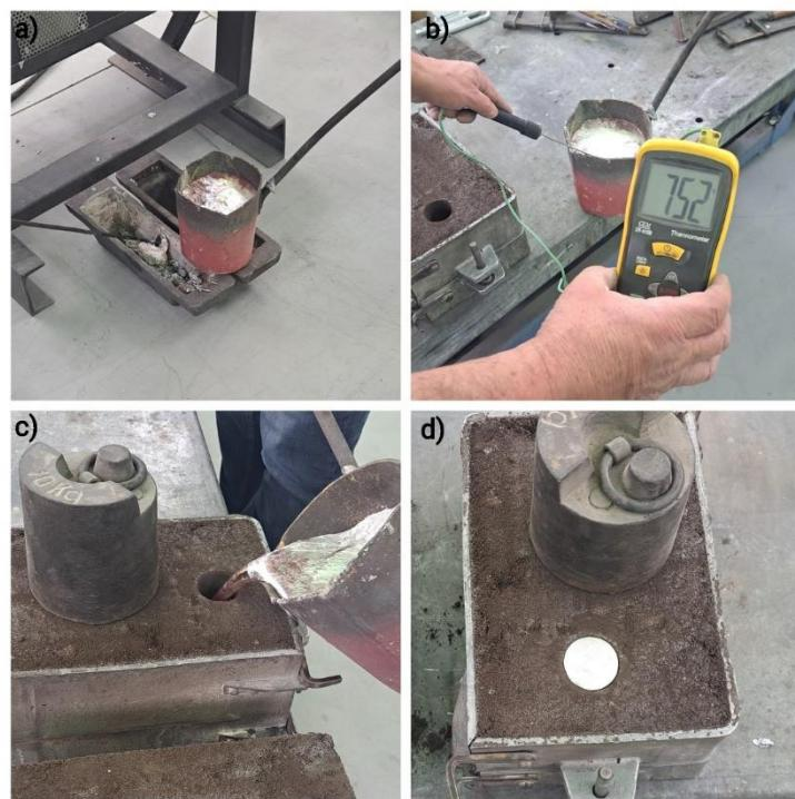
**Slika 71. Lijevanje: a) prijenos taljevine loncem, b) mjerjenje temperature taljevine, c) ulijevanje taljevine u uljevni sustav, d) hlađenje taljevine**
