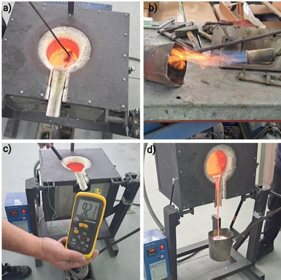
**Slika 70.** Priprema taljevine: a) čišćenje oksida iz taljevine, b) zagrijavanje lonca, c) mjerjenje temperature taljevine, d) punjenje lonca
