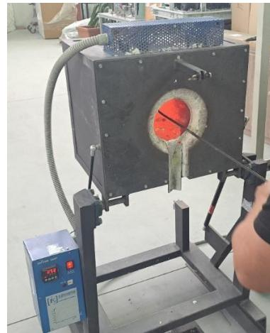
**Slika 72. Čišćenje peći**
