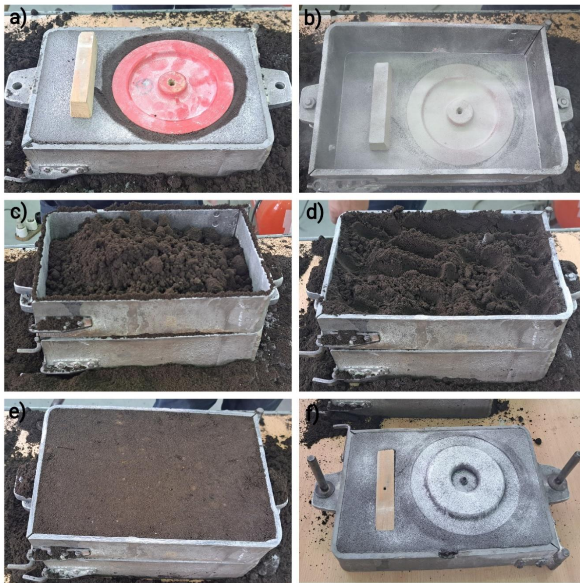
Slika 67. Donjak: a) postavljanje razvodnika, b) postavljanje kalupnika i posipavanje likapodijem, c) punjenje donjaka kalupnom mješavinom, d) sabijanje kalupne mješavine, e) poravnanje kalupne mješavine, f) okretanje donjaka
