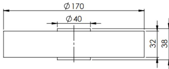
Slika 45. Nacrt odljevka
