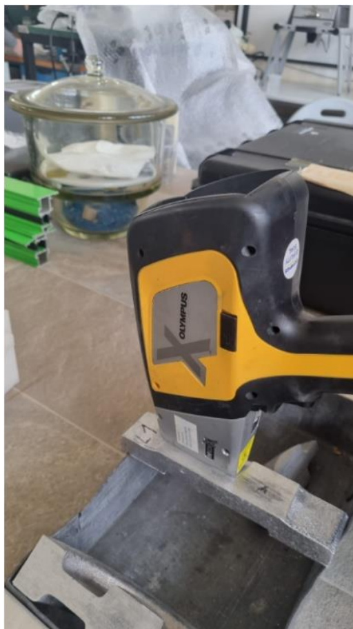
Slika 78. Određivanje kemijskog sastava odljevka XRF metodom
