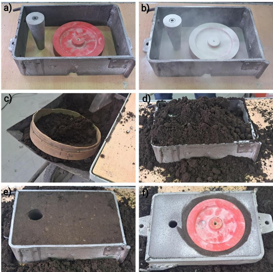
**Slika 66. Gornjak:** a) pozicioniranje modela i spusta, b) posipavanje likapodijem, c) punjenje sita kalupnom mješavinom, d) punjenje gornjaka kalupnom mješavinom, e) sabijanje i poravnavanje kalupne mješavine, f) okretanje gornjaka
