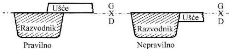
Slika 41. Pravilno i nepravilno konstruiranje razvodnika i ušća u semitlačnom uljevnom sustavu [1]
