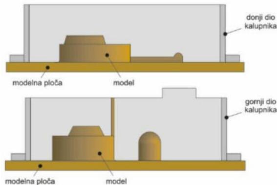
Slika 6. Prikaz dijelova kalupa na modelnim pločama [8]
