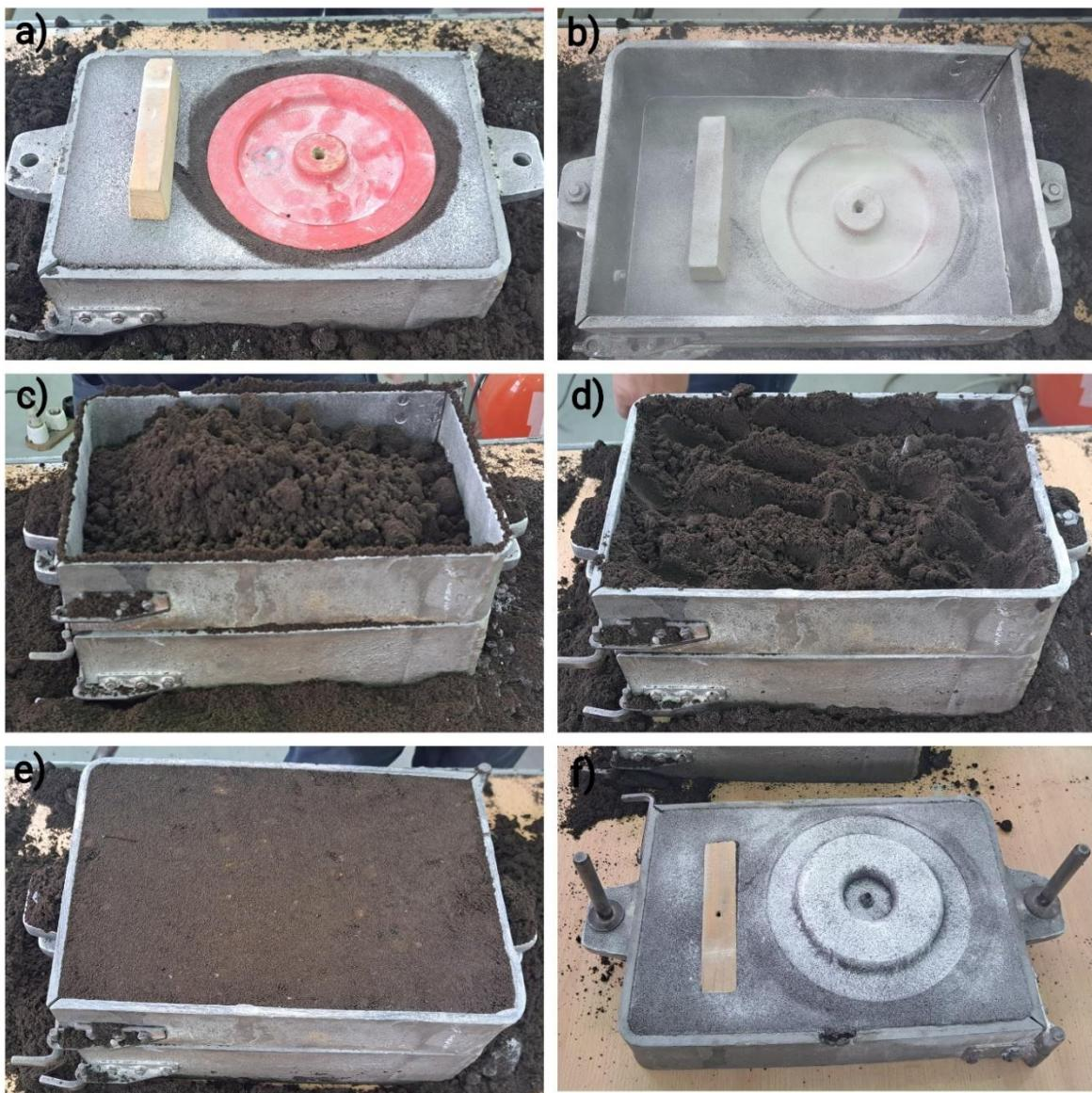
**Slika 67. Donjak:** a) postavljanje razvodnika, b) postavljanje kalupnika i posipavanje likapodijem, c) punjenje donjaka kalupnom mješavinom, d) sabijanje kalupne mješavine, e) poravnjanje kalupne mješavine, f) okretanje donjaka
