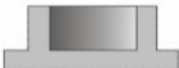
Slika 16. Netočnost mjera i oblika odljevka [8]
