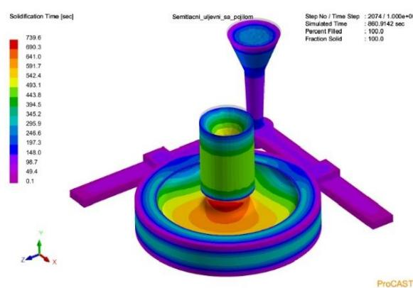
**Slika 63. Vrijeme potrebno za skrućivanje dijelova modela semitlačnog uljevnog sustava s pojilom**
