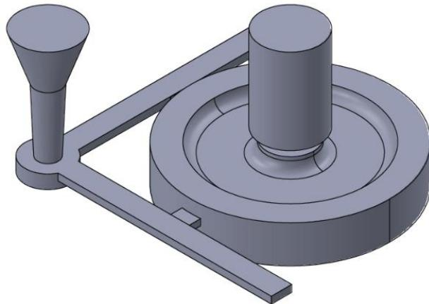
**Slika 52.** Tlačni uljevni sustav s pojilom
