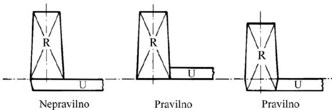
**Slika 39.** Nepravilan i pravilni načini konstruiranja razvodnika i ušća kod tlačnog uljevnog sustava (U – ušće, R – razvodnik) [2]
