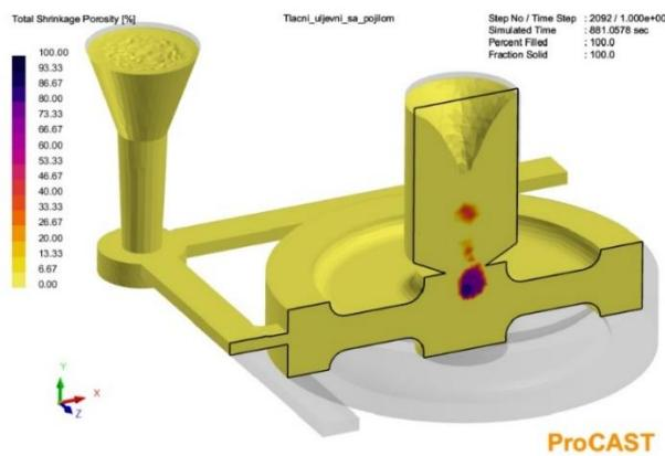
**Slika 56.** Presjek najveće pojave poroznosti u modelu tlačnog uljevnog sustava s pojilom
