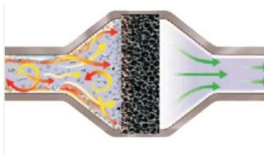
Slika 34. Keramički filter [14]
