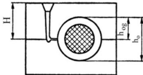
Slika 44. Shema za lijevanje sa strane [2]
