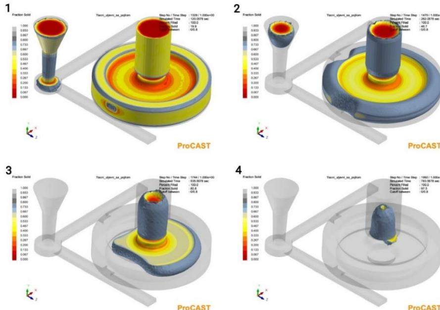
Slika 54. Simulacija skrućivanja kod tlačnog uljevnog sustava s pojilom u koracima
