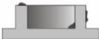
Slika 11. Metalne izrasline na odljevku [8]
