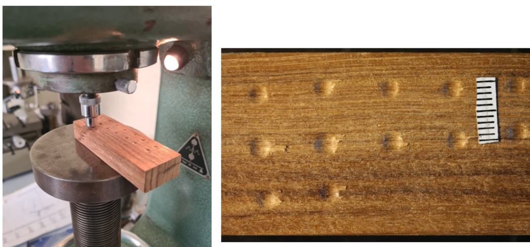
Slika 7.25. Mjerenje tvrdoće i otisci kuglice na ispitnom uzorku tikovine
