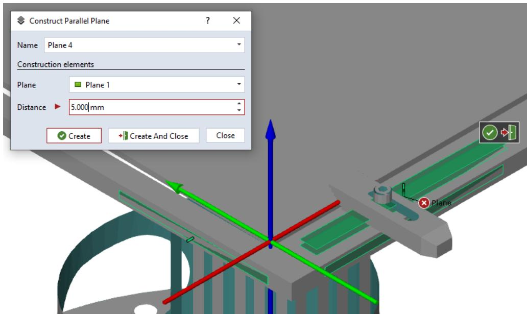
Slika 30. Konstruiranje ravnine naredbom *Construct Parallel Plane*
