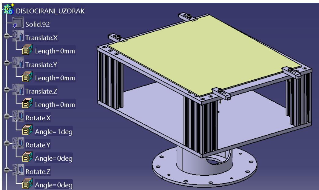
Slika 14. Naredbe za translaciju i rotaciju ispitnog uzorka
