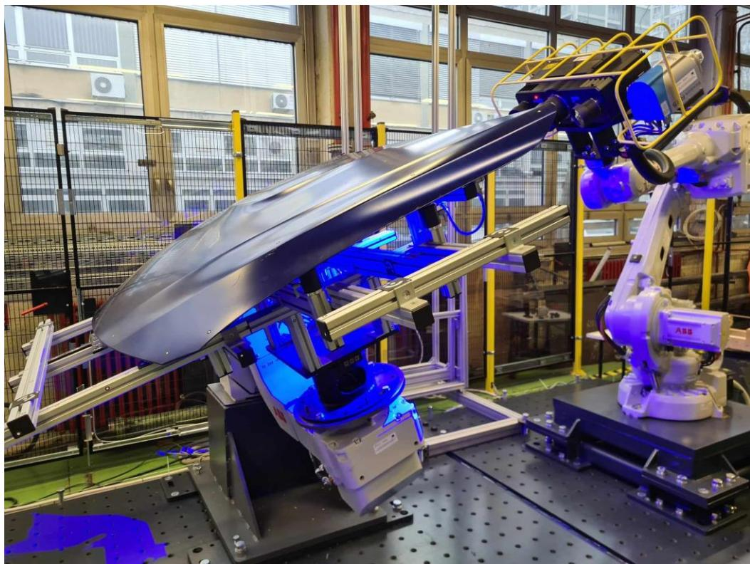
Slika 6. Optički mjerni uređaj ATOS 5X montiran na industrijskom robotu
