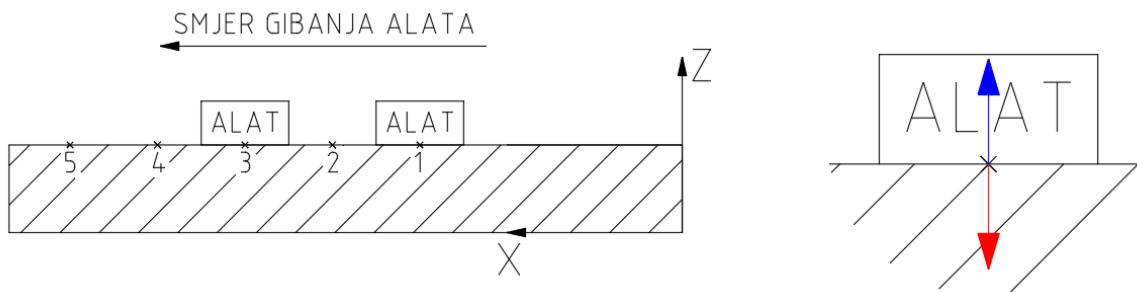
**Slika 2. Brušenje pravilno pozicioniranog i orijentiranog obratka**
