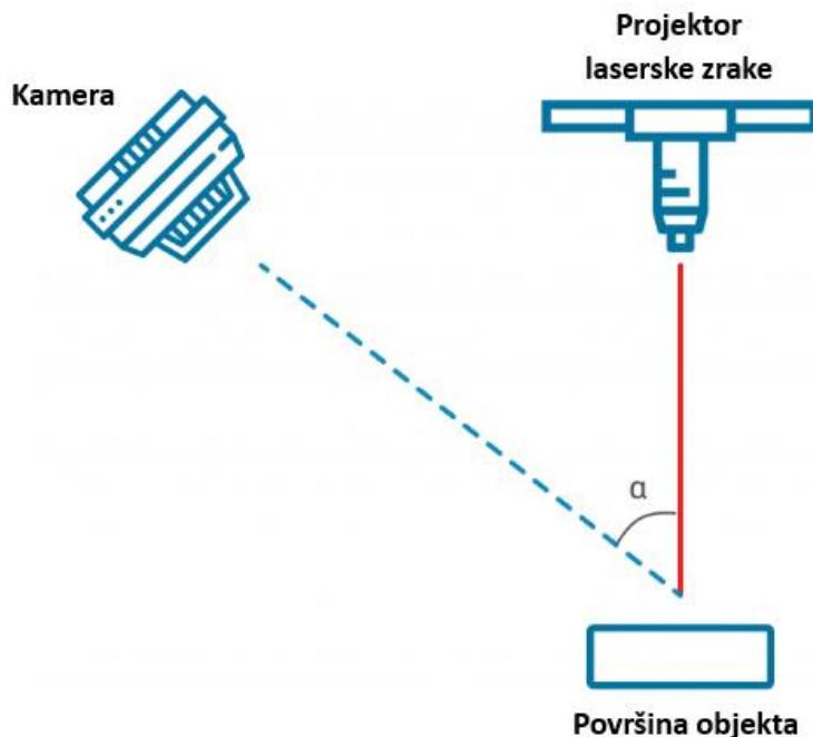
**Slika 4. Lasersko 3D skeniranje bazirano na principu triangulacije [5]**
