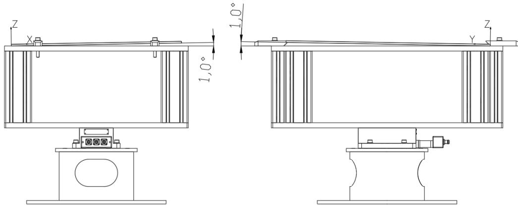
**Slika 15. Ispitni uzorak zakrenut oko a) Y osi i b) X osi koordinatnog sustava predviđenog za obradu**
