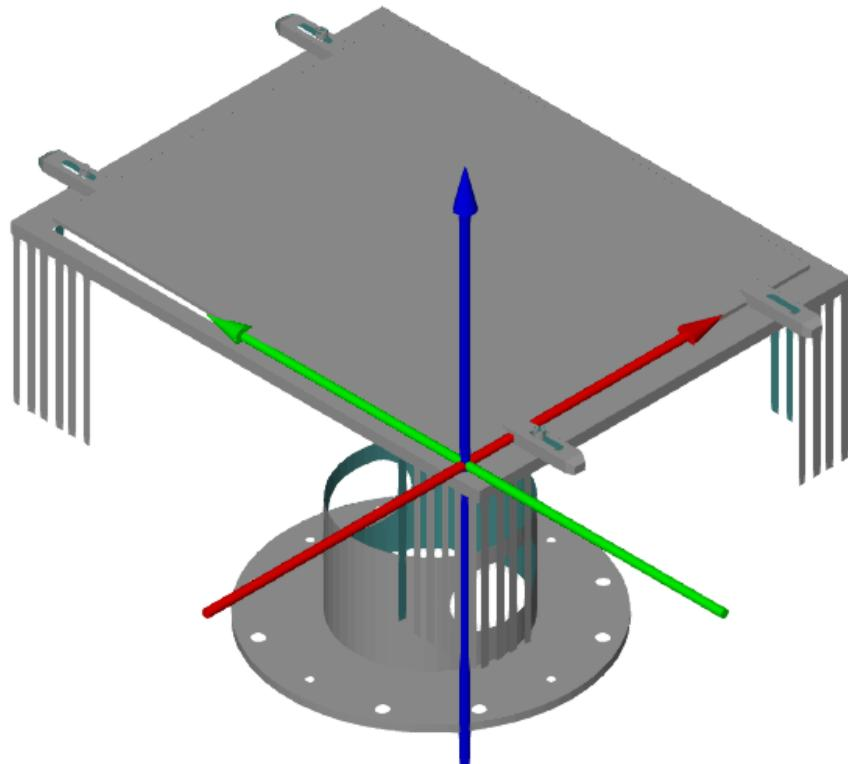
Slika 28. Simulacija skena pogrešno stegnutog ispitnog uzorka
