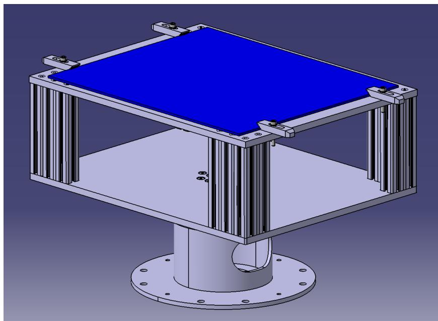
Slika 13. Referentni sklop ispitnog uzorka i stezne naprave
