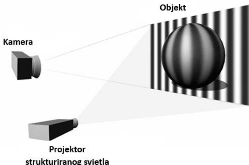
Slika 5. Metoda 3D skeniranja strukturiranim svjetlom [7]
