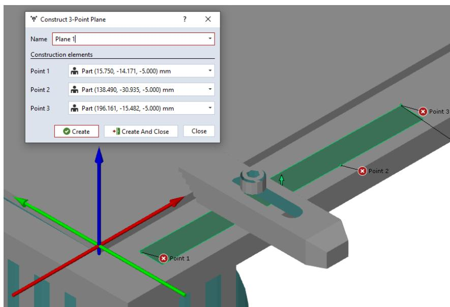
Slika 29. Konstruiranje ravnine naredbom *Construct 3-Point Plane*
