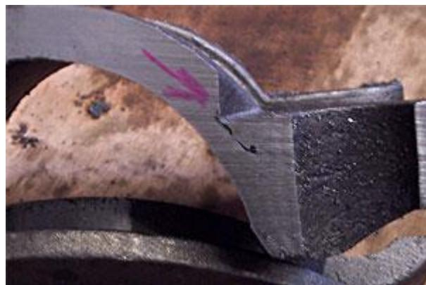
Slika 26. Presjek odljevka s poroznosti [17]
