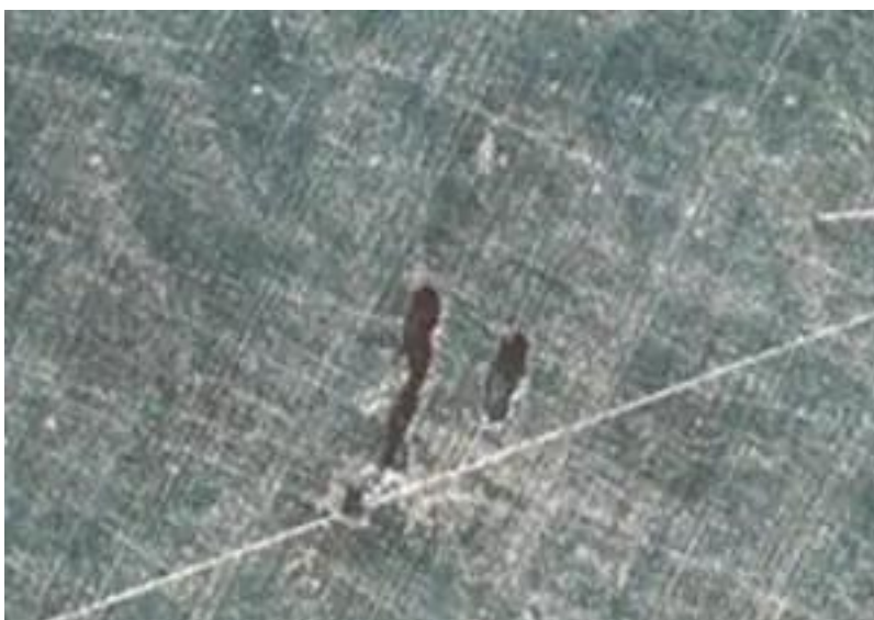
Slika 25. Proznost nastala tijekom skrućivanja [16]
