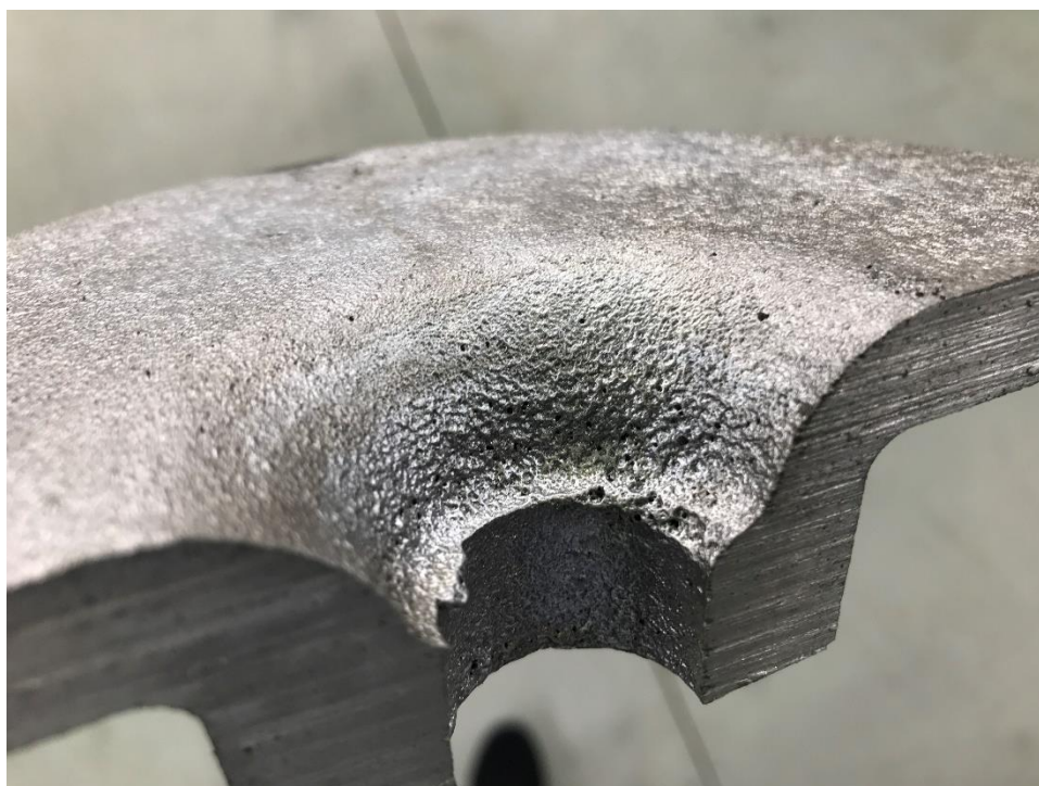
Slika 49. Poroznost na donjem radijusu odljevka
