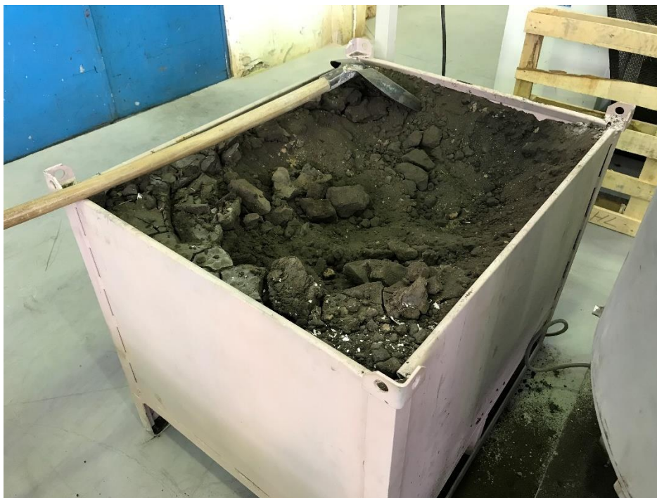
Slika 38. Sanduk s kalupnom mješavinom
