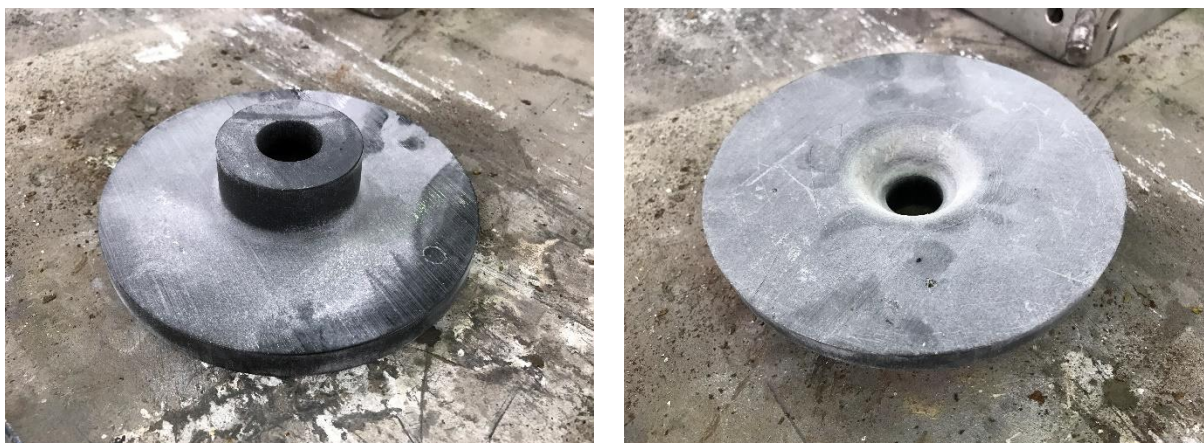
Slika 16. 3D isprintani model prirubnice
