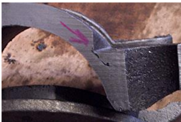
Slika 26. Presjek odljevka s poroznosti [17]
