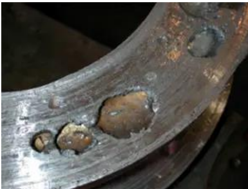
Slika 24. Poroznost uzrokovana zarobljenim plinom [16]
