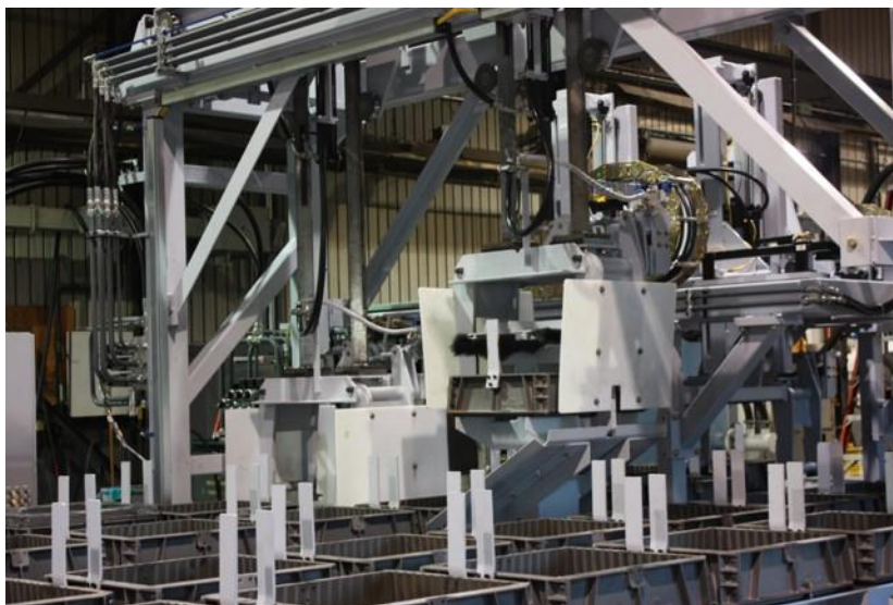
Slika 7. Automatizirana proizvodnja odljevaka u jednokratnim kalupima [4]
