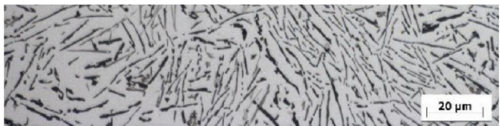
Slika 14. Mikrostruktura legure AlSi12 [14]
