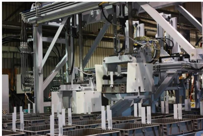
**Slika 7. Automatizirana proizvodnja odljevaka u jednokratnim kalupima [4]**
