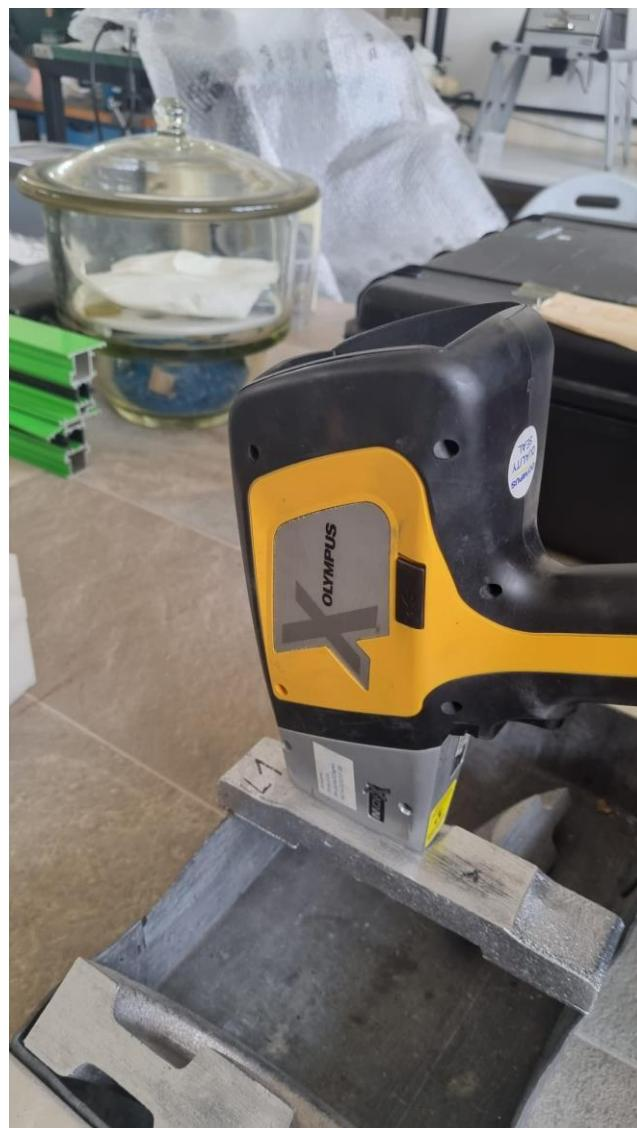
Slika 52. Određivanje kemijskog sastava odljevka XRF metodom
