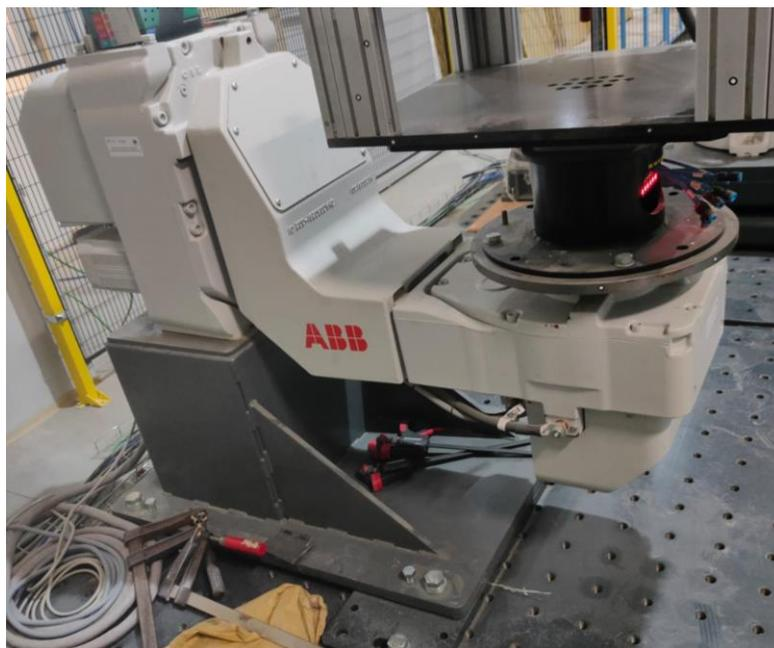
**Slika 7.** ABB-IRBP-A-500-1000 postavljen u robotskoj obradnoj ćeliji
