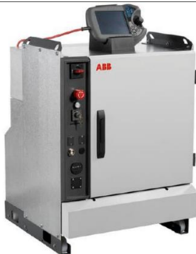
Slika 9. Upravljački sustav robota s operaterskim panelom [8]
