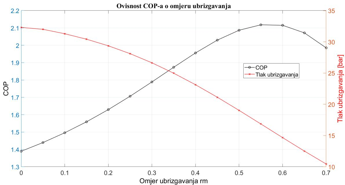
Slika 47. Ovisnost COP-a kružnog procesa o omjeru ubrizgavanja
