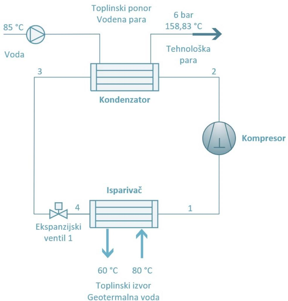
**Slika 42. Shematski prikaz visokotemperaturne dizalice topline – jednostupanjska kompresija**
