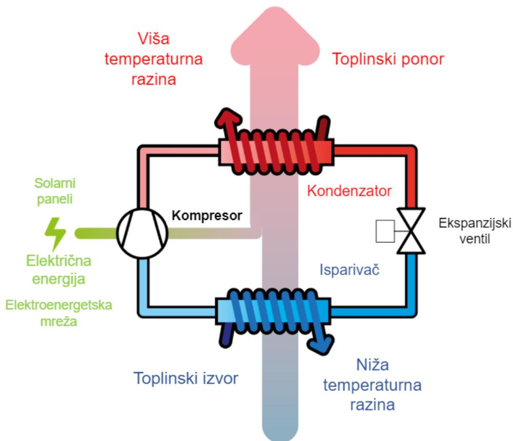
Slika 18. Shematski prikaz rada dizalice topline [29]
