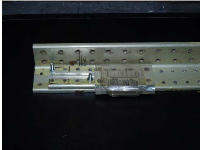
Slika 38. Uzorak 2 u sklopu s L-profilom + indikator
