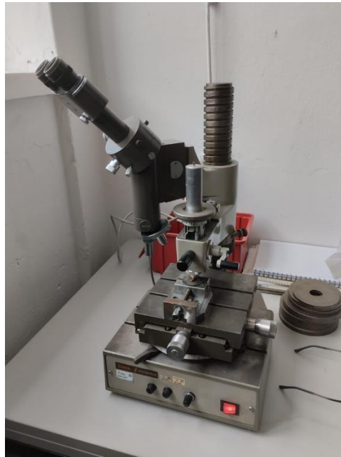
Slika 26. Tvrdomjer tvrtke „Zwick“ za ispitivanje tvrdoće metodom Vickers
