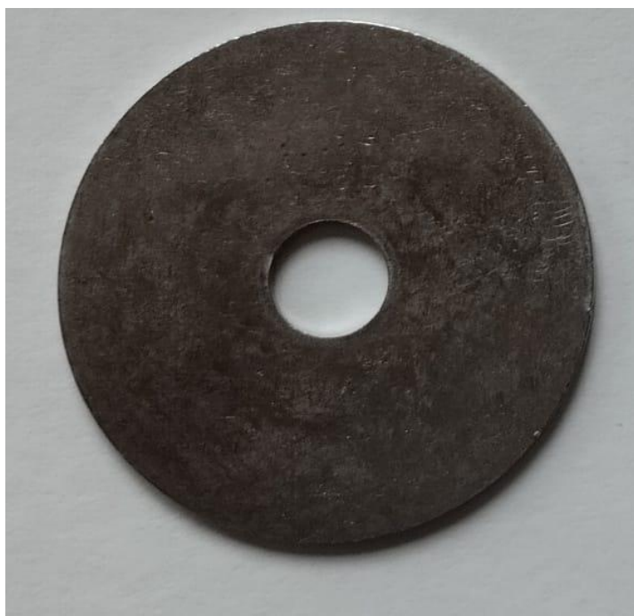
Slika 21. Polazni oblik pločice od čelika X5CrNiMo17-12-2
