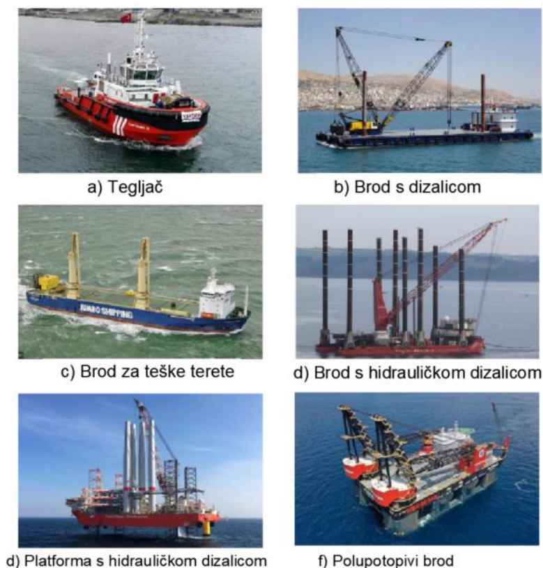
Slika 41. Različite vrste plovila kada se koriste pri instalaciji odobalnih vjetroturbina [22]
