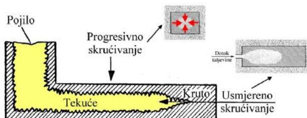
Slika 19. Usmjereno i progresivno skrućivanje u odljevku s pojilom [1]
