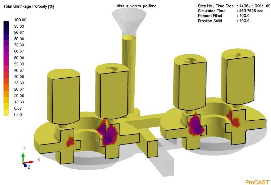
**Slika 50. Dvodimenzionalni prikaz poroznosti – veća pojila**
