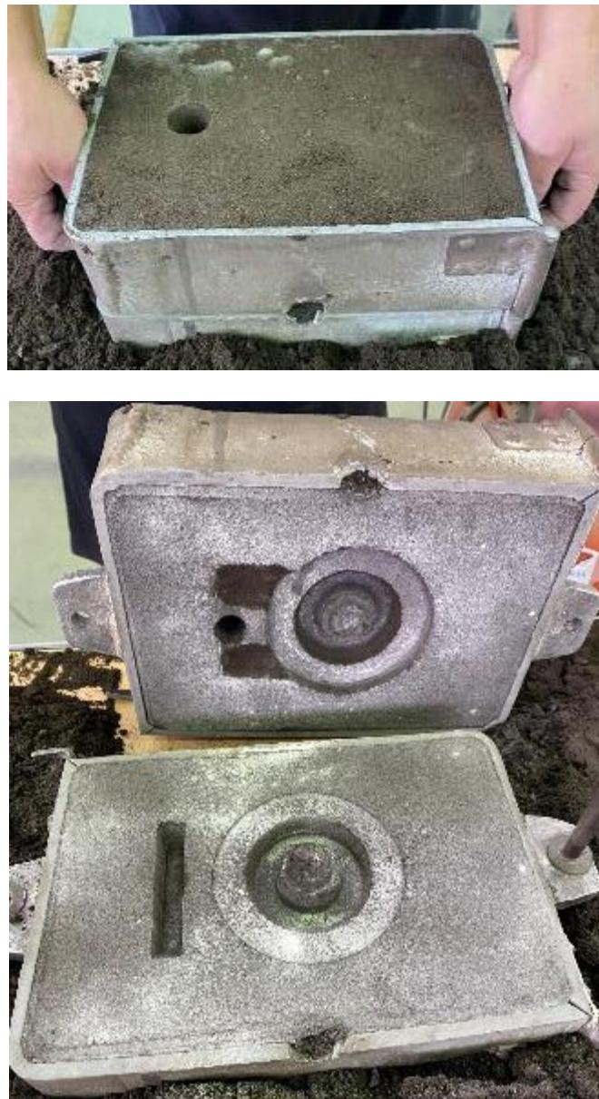
**Slika 64. Okretanje, razdvajanje i vadenje modela i komponenti uljevnog sustava**
