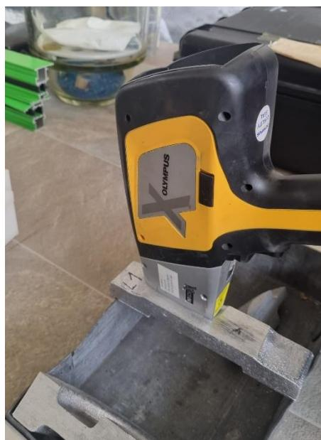
**Slika 75. Određivanje kemijskog sastava odljevka XRF metodom**
