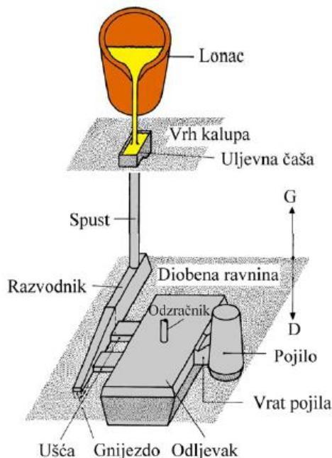
Slika 7. Osnovne komponente uljevnog sustava [1]
