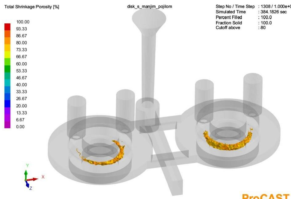
**Slika 45. Trodimenzionalni prikaz poroznosti – manja pojila**
