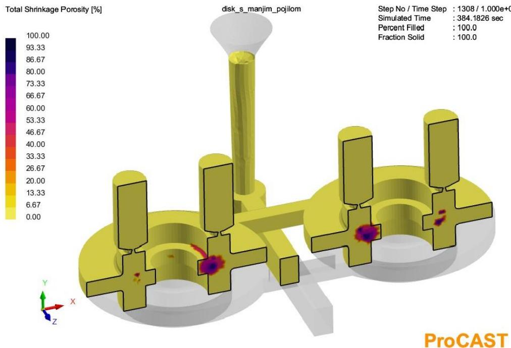
**Slika 46 Dvodimenzionalni prikaz poroznosti – manja pojila**
