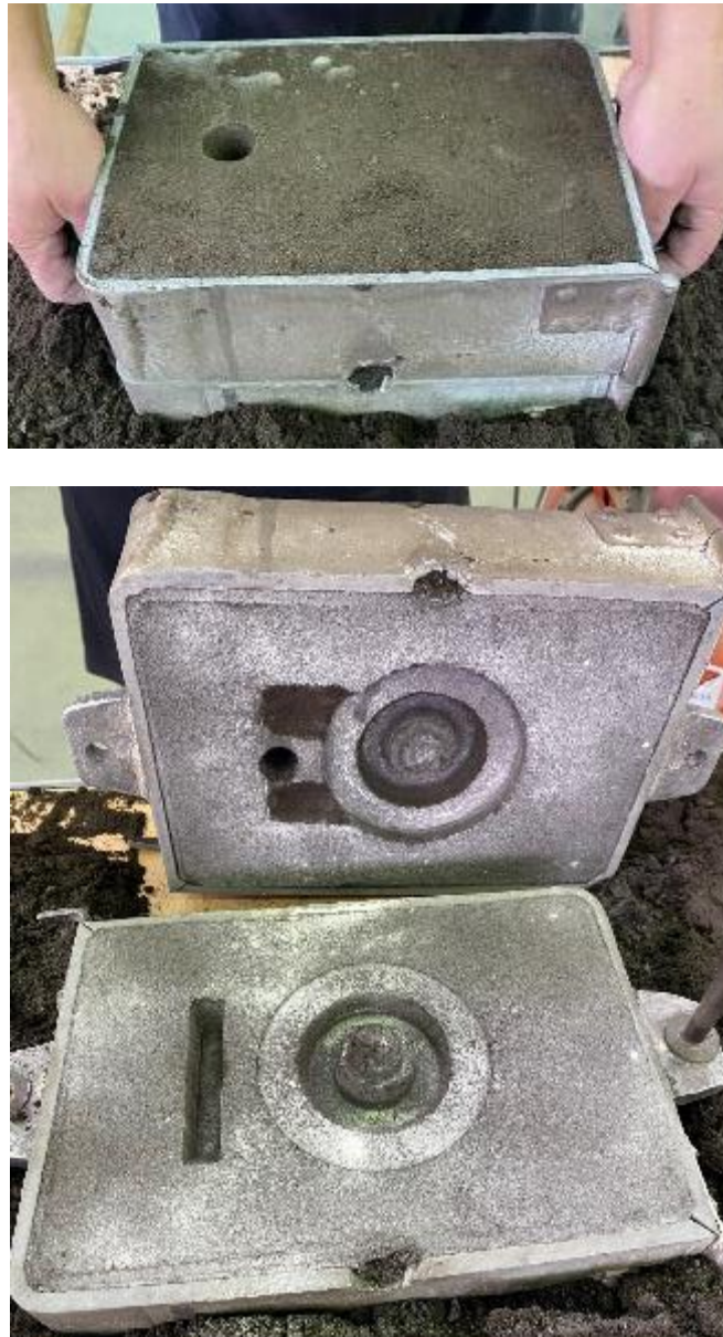
Slika 64. Okretanje, razdvajanje i vađenje modela i komponenti uljavnog sustava
