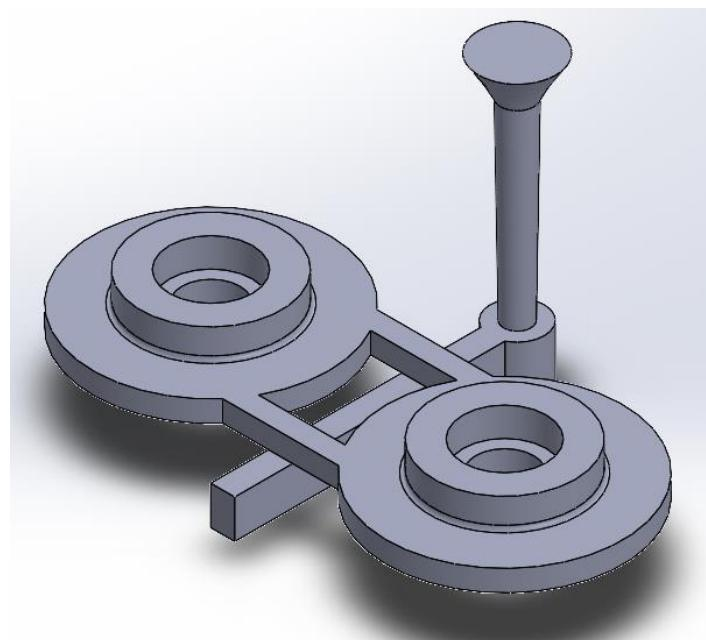
Slika 35. Model dva odljevka s uljevnim sustavom
