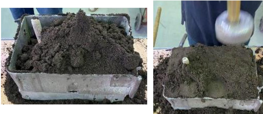
Slika 59. Nasipavanje kalupne mješavine i sabijanje
