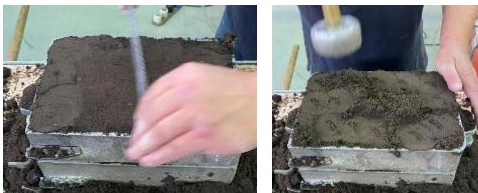
**Slika 63. Sabijanje i uklanjanje viška kalupne mješavine**
