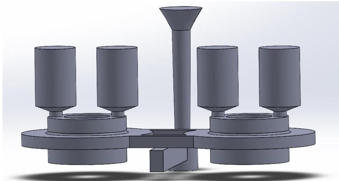
**Slika 38. Uljevni sustav s većim pojilima**
