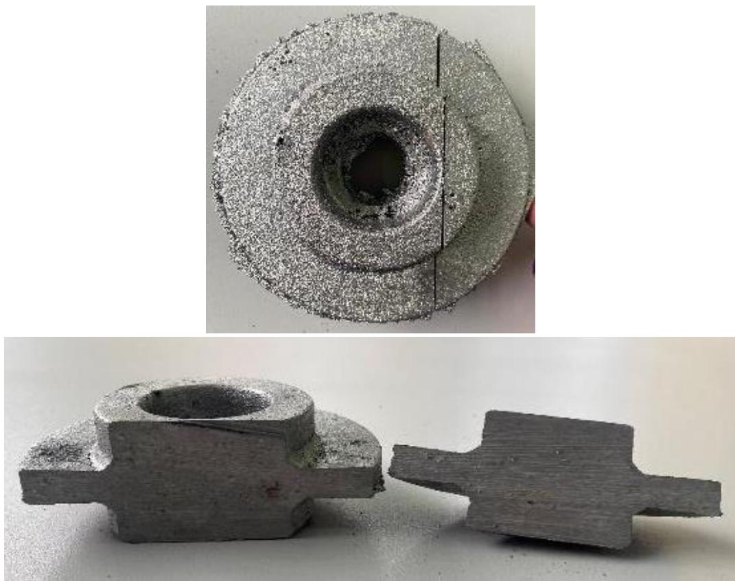
Slika 72. Presjek odljevka
