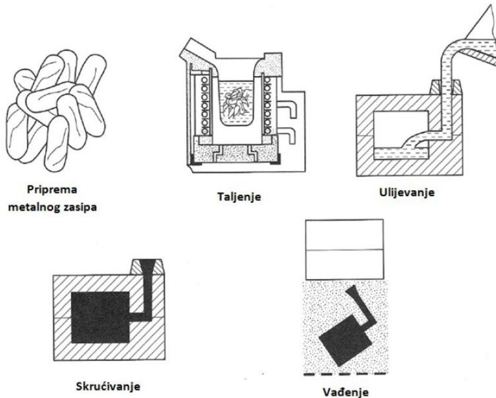
**Slika 3. Proizvodni koraci postupka lijevanja [2]**
