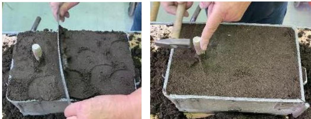
Slika 60. Uklanjanje viška kalupne mješavine i vađenje spusta
