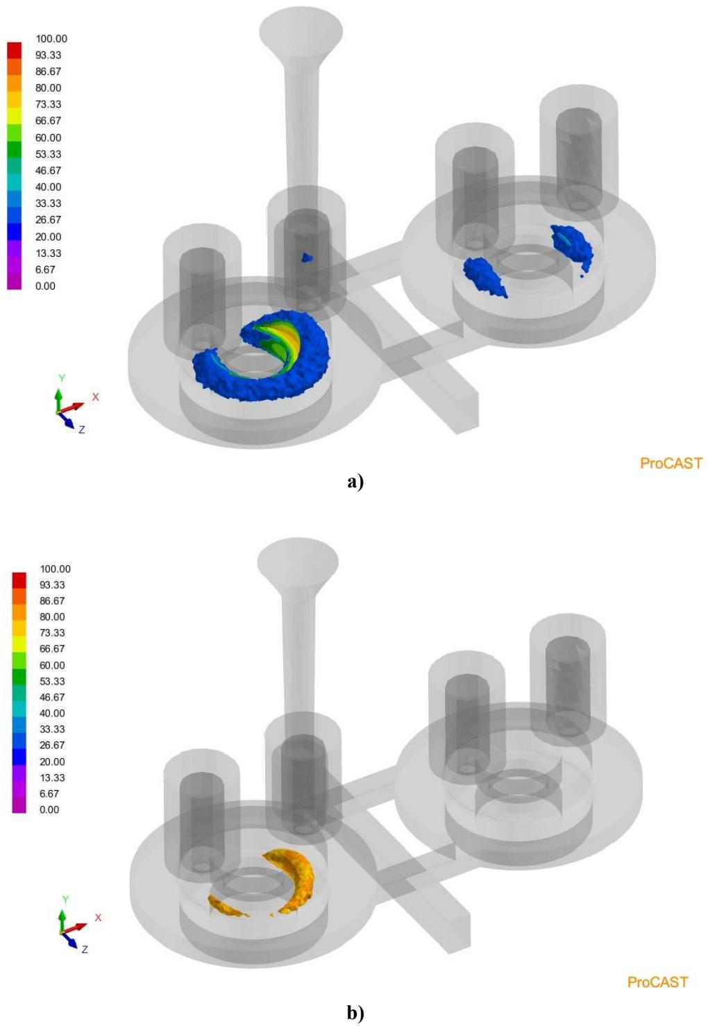
**Slika 53. Trodimenzionalni prikaz poroznosti – manja pojila s egzotermnim oblogama**
