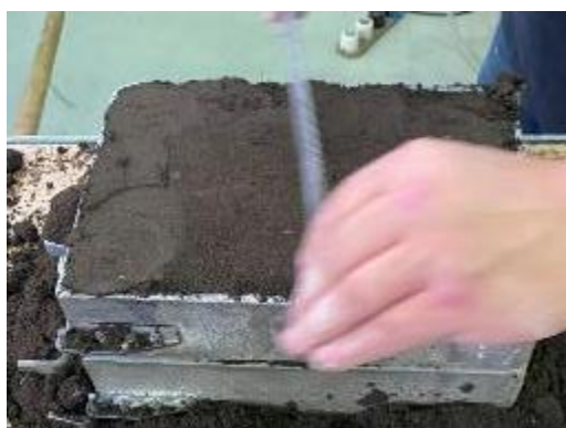
Slika 63. Sabijanje i uklanjanje viška kalupne mješavine
