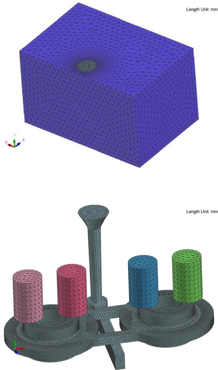
**Slika 41. Mreža kalupa i odljevka s uljevnim sustavom**
