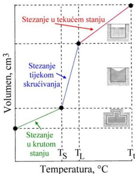
Slika 15. Prikaz tipične krivulje volumnih promjena.  $T_t$  – temperaturna taljevine u kalupu nakon završetka ulijevanja,  $T_L$  – likvidus temperatura,  $T_S$  – solidus temperatura [1]
