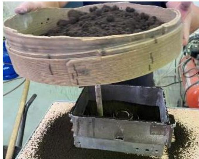
**Slika 57. Nasipavanje modelnog pijeska**
