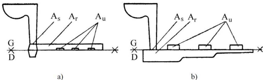
**Slika 13. a) tlačni uljevni sustav b) semitlačni uljevni sustav [1]**
