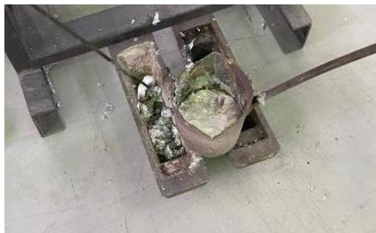
**Slika 68. Uklanjanje sloja oksida sa površine taljevine**
