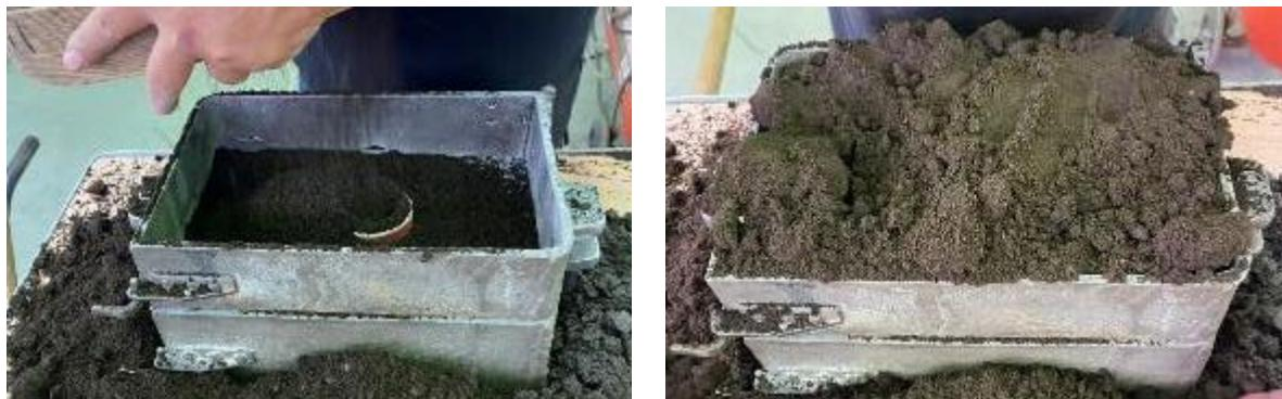
**Slika 62. Nasipavanje modelne i punidbene kalupne mješavine**
