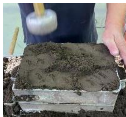
Slika 63. Sabijanje i uklanjanje viška kalupne mješavine
