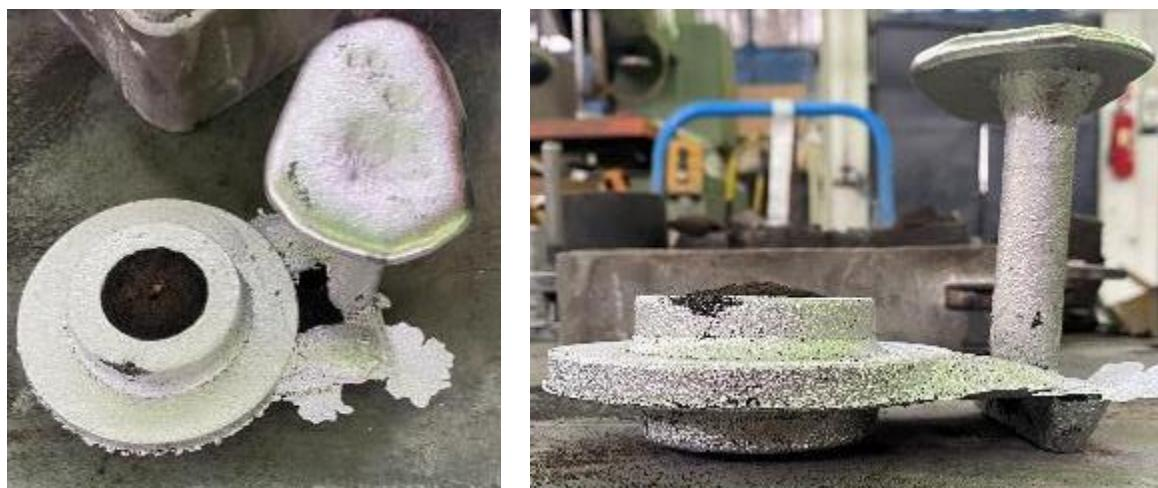
Slika 71. Odljevak s uljevnim sustavom
