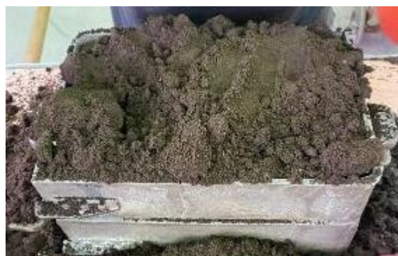
Slika 62. Nasipavanje modelne i punidbene kalupne mješavine
