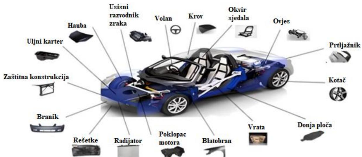
Slika 4. Kompozitni dijelovi automobila [6]
