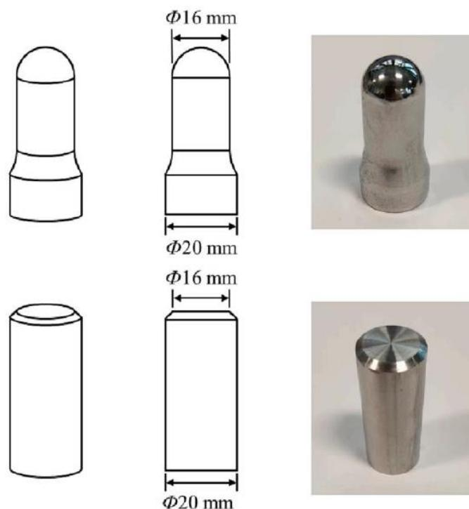
**Slika 12. Geometrija udarnih tijela [15]**
