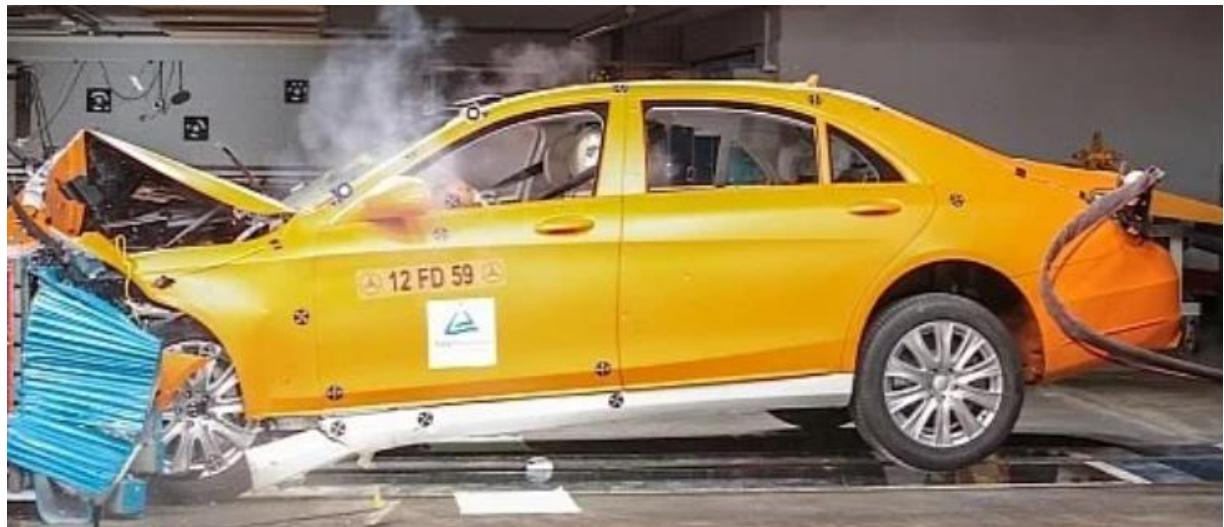
Slika 30. Frontalni sudar i oštećenje prednjeg dijela vozila [18]
