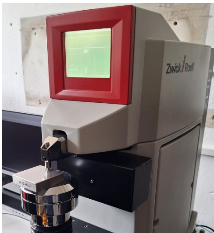
Slika 21. Mjerenje tvrdoće na tvrdomjeru
