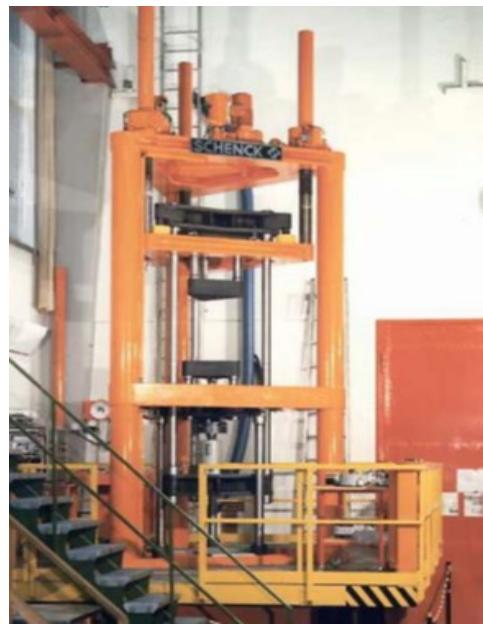
**Slika 13. Primarni nacionalni etalon sile u PTB-u, Njemačka [2]**
