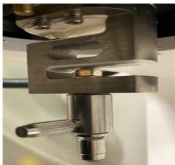
Slika 9. Senzor sile instaliran iznad indentora [18]
