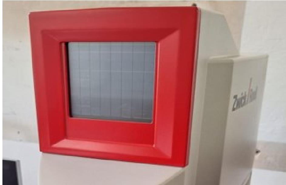
**Slika 16. Digitalni pokazivač tvrdomjera**
