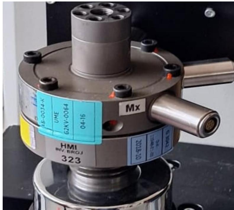
Slika 17. Prijenosni etalon sile KTN-D-Z 5 kN
