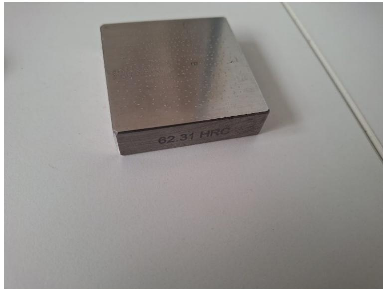
**Slika 20. Etalonska pločica 62,31 HRC**
