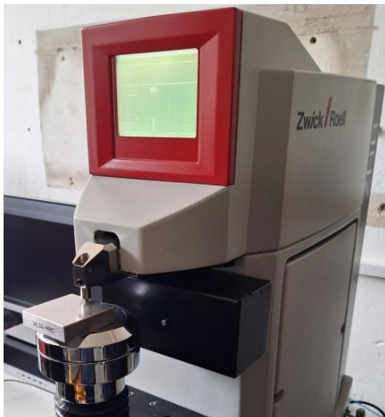
**Slika 21. Mjerenje tvrdoće na tvrdomjeru**
