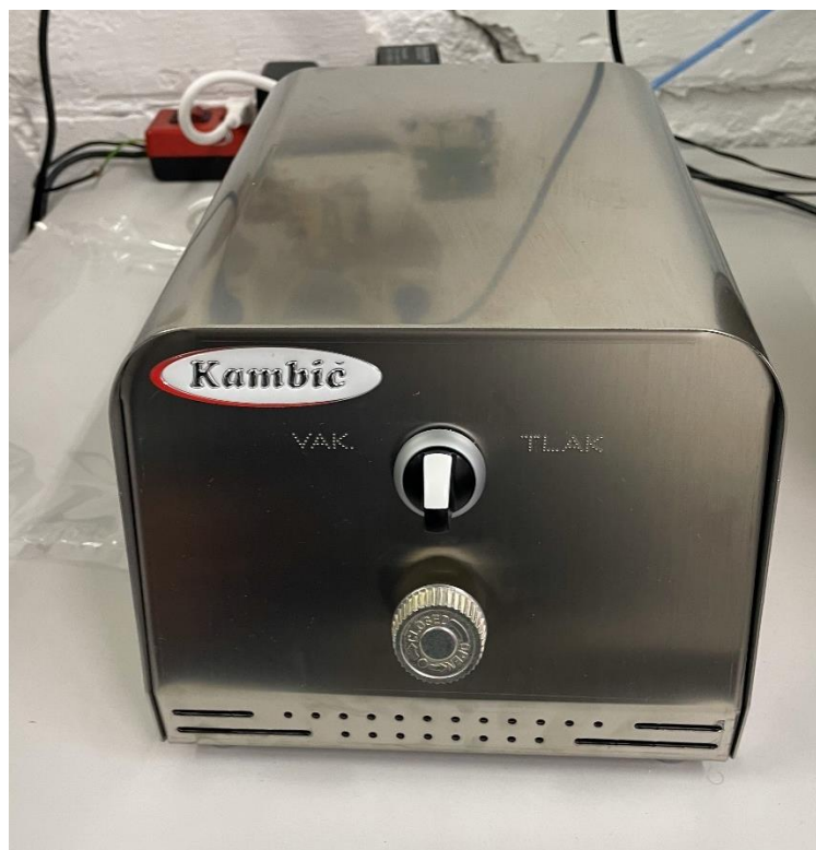
Slika 23. Pumpa koja dolazi uz komoru
