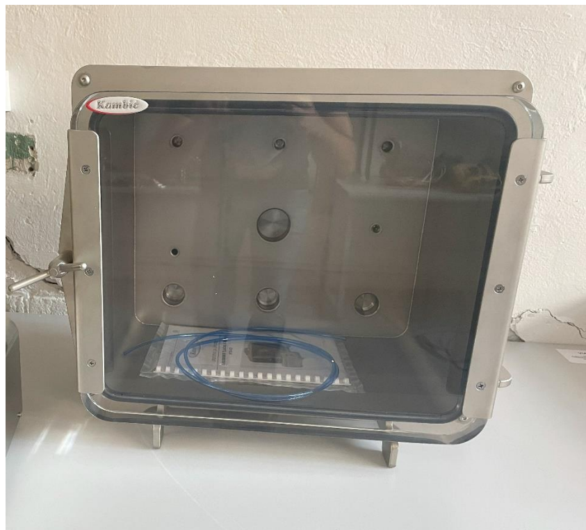
Slika 22. Vakuumska tlačna komora slovenskog proizvođača Kambič
