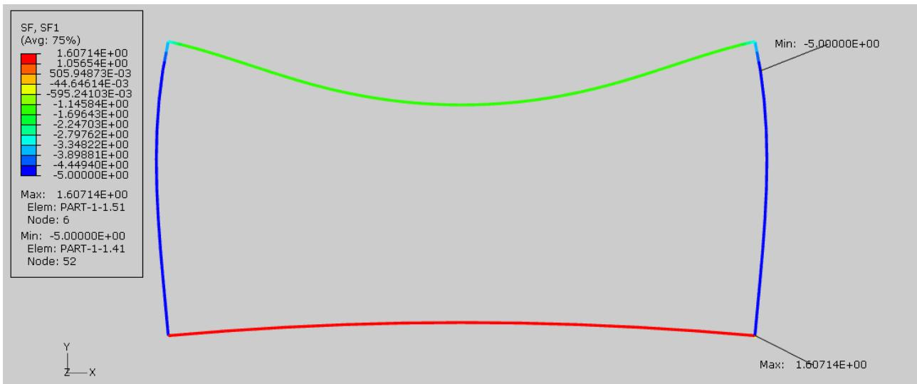
Slika 2.7 Raspodjela osne sile na deformiranom obliku
