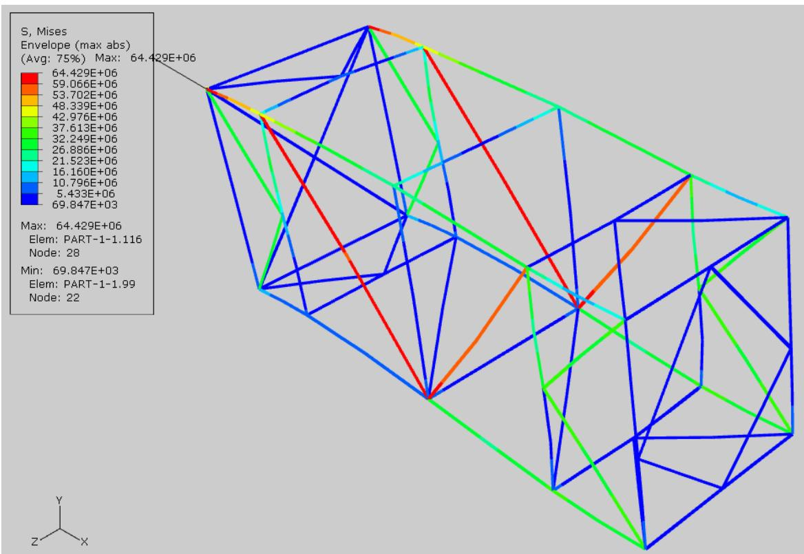
**Slika 4.8 Rekonstruirana rešetka - prikaz maksimalnih ekvivalentnih naprezanja – djelovanje horizontalne vlačne sile  $F=75$  kN na lijevom kraju**
