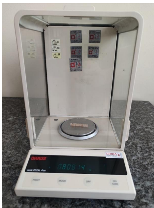
Slika 21. Određivanje mase ispitnih uzoraka na analitičkoj vazi Ohaus Analytical Plus
