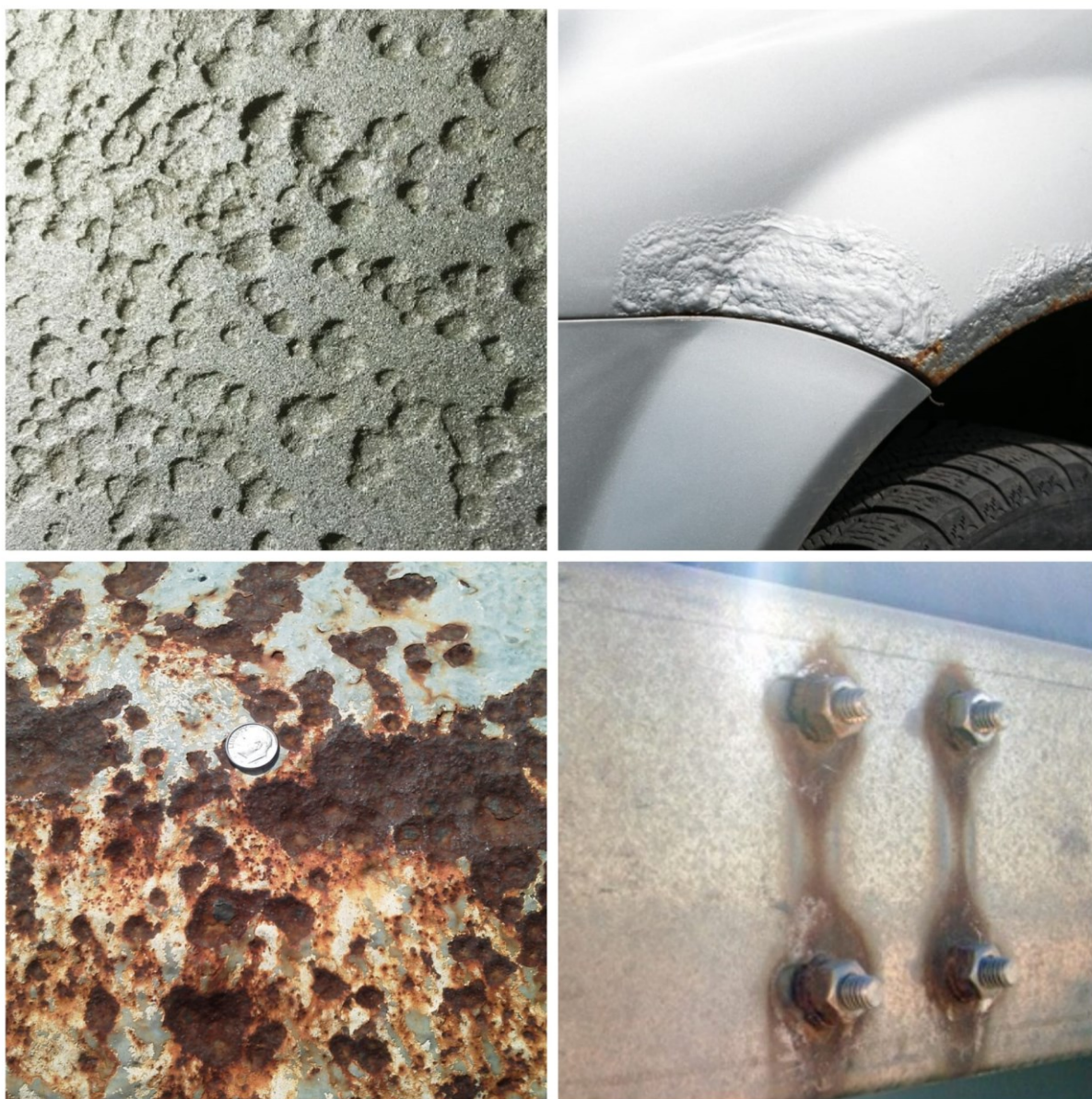
Slika 23. Vrste lokalne korozije (rupičasta, potpovršinska, pjegasta, kontaktna) [48,49,50,51]
