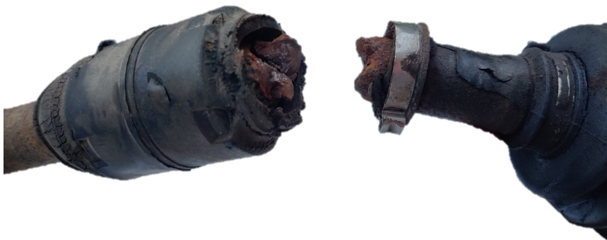
Slika 27. Mjesto loma pogonskog vratila s homokinetičkim zglobom
