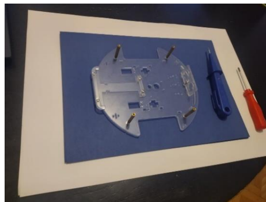
Slika 25. Montiranje nosača ultrazvučnog senzora i nosača baterije
