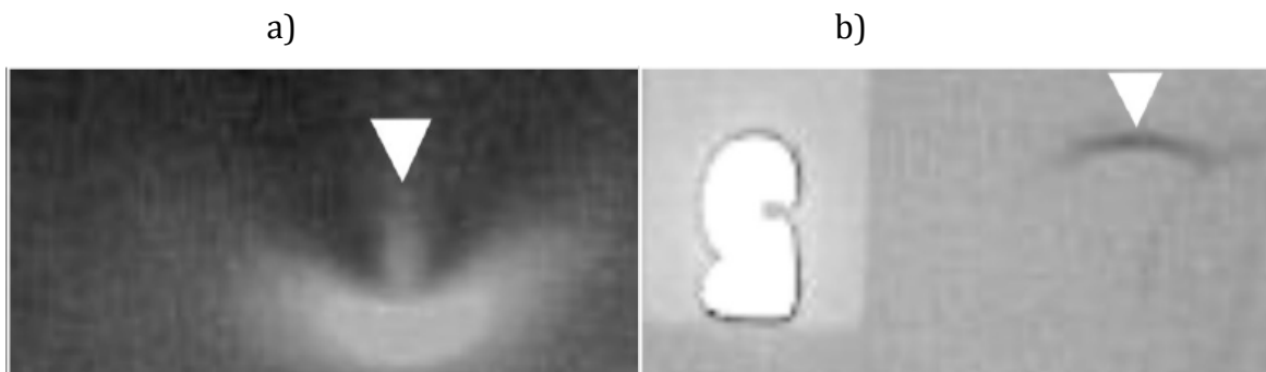
Slika 15: Greška uzrokovana savijanjem filma a) prije i b) nakon eksponiranja
