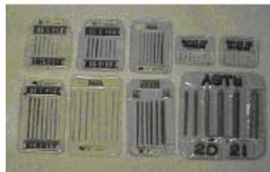
Slika 7: Indikatori kvalitete radiograma
