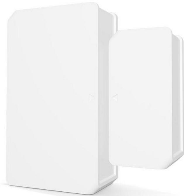
*Slika 8 Sonoff SNZB-04, senzor za vrata i prozore*
