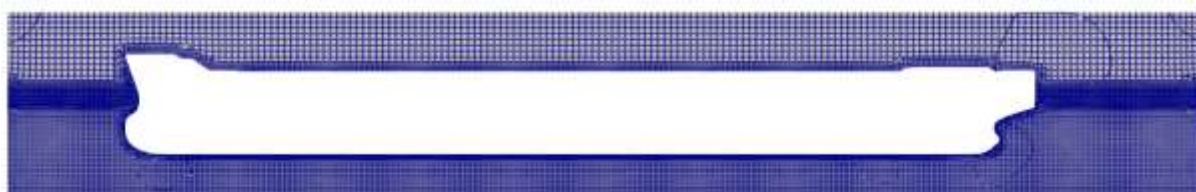
Slika 7. Diskretizirana domena, uzdužni presjek broda.
