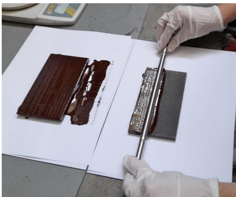
Slika 16. Postupak nanošenja premaza pomoću aplikatora.
