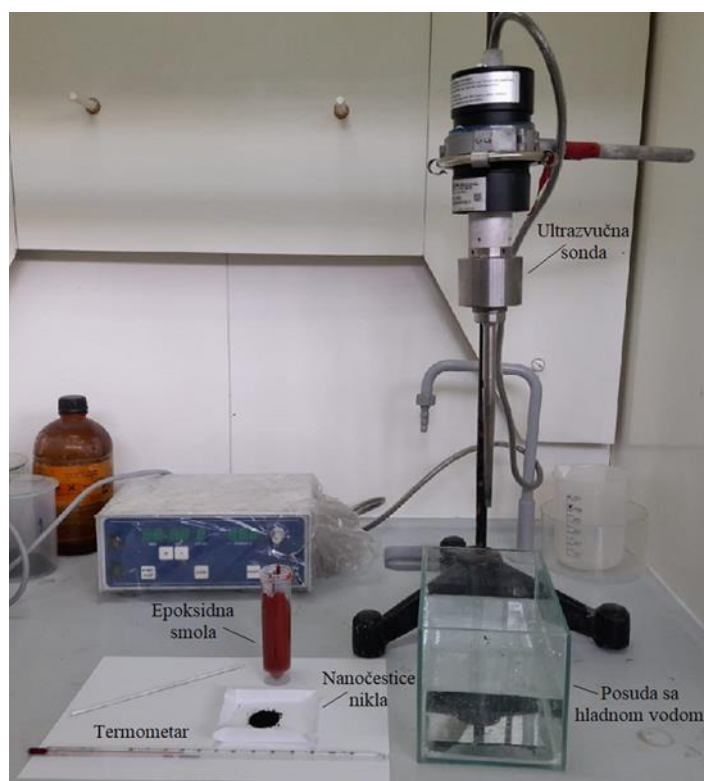
Slika 14. Prikaz aparature korištene za pripravu epoksidne prevlake s nanočesticama nikla.
