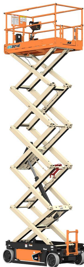
Slika 4. Škarasta podizna platforma ES1932 [5]
