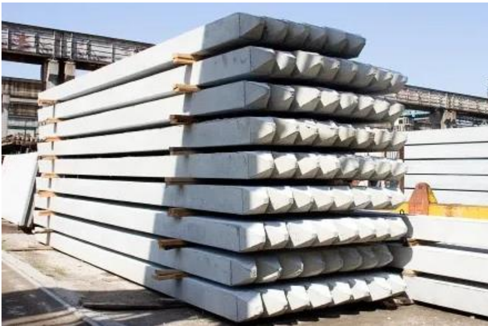
Slika 3. Gotovi betonski piloti [5]
