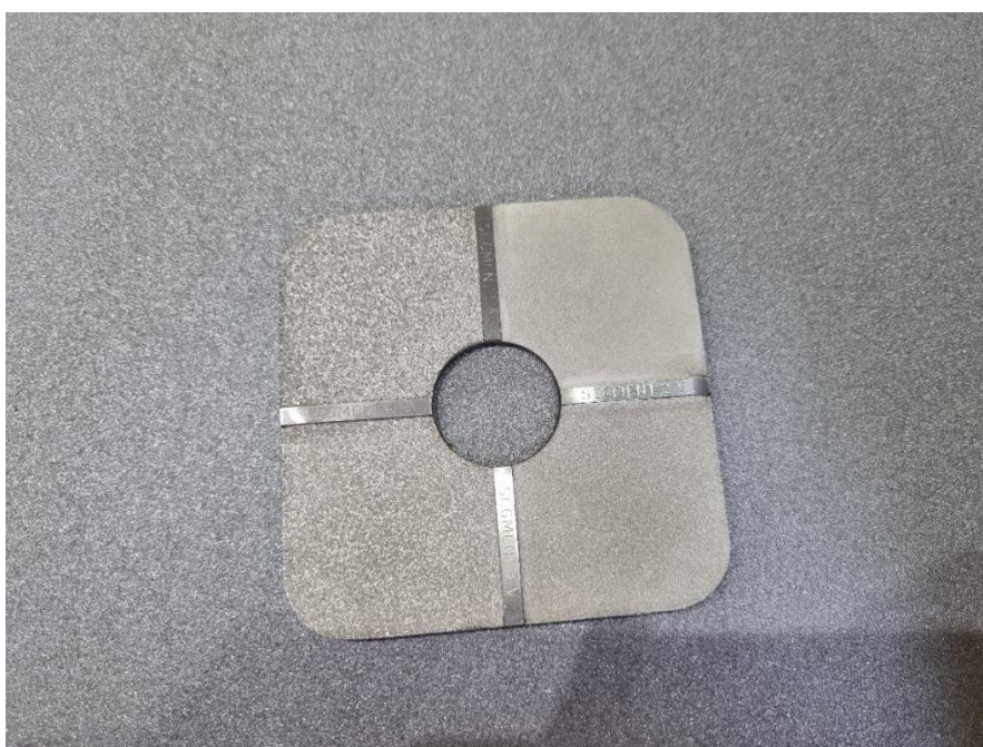
Slika 18 Ispitna pločica za procjenu kvalitete čišćenja sačmom
