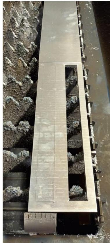
**Slika 27. Položaj pripremka lima s izrezanim uzorkom na radnom stolu lasera**
