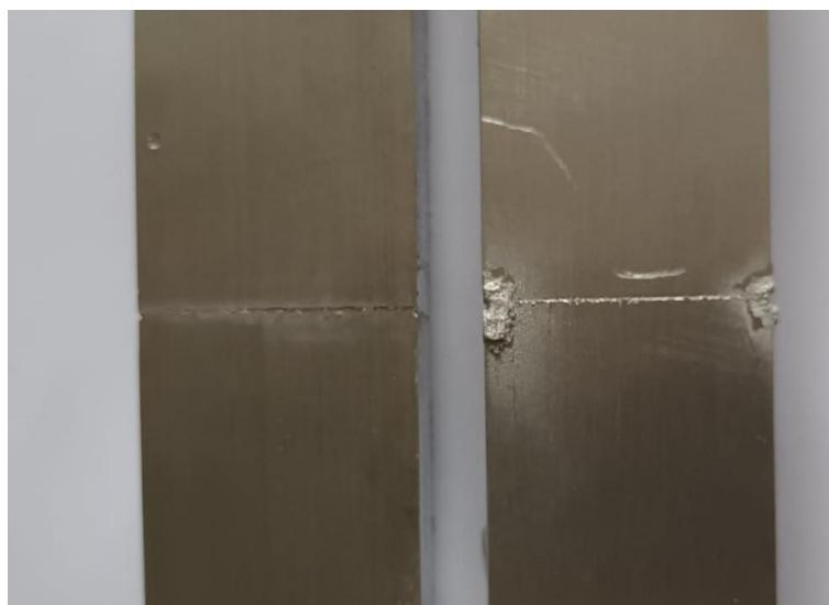
Slika 36. Tragovi probroja na gornjoj površini materijala debljine 8 mm (lijevo – fiber laser, desno – CO<sub>2</sub> laser)
