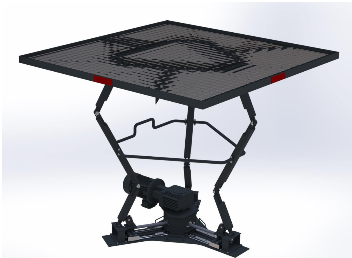
Slika 52. Podizna platforma gornji položaj – 3D render
