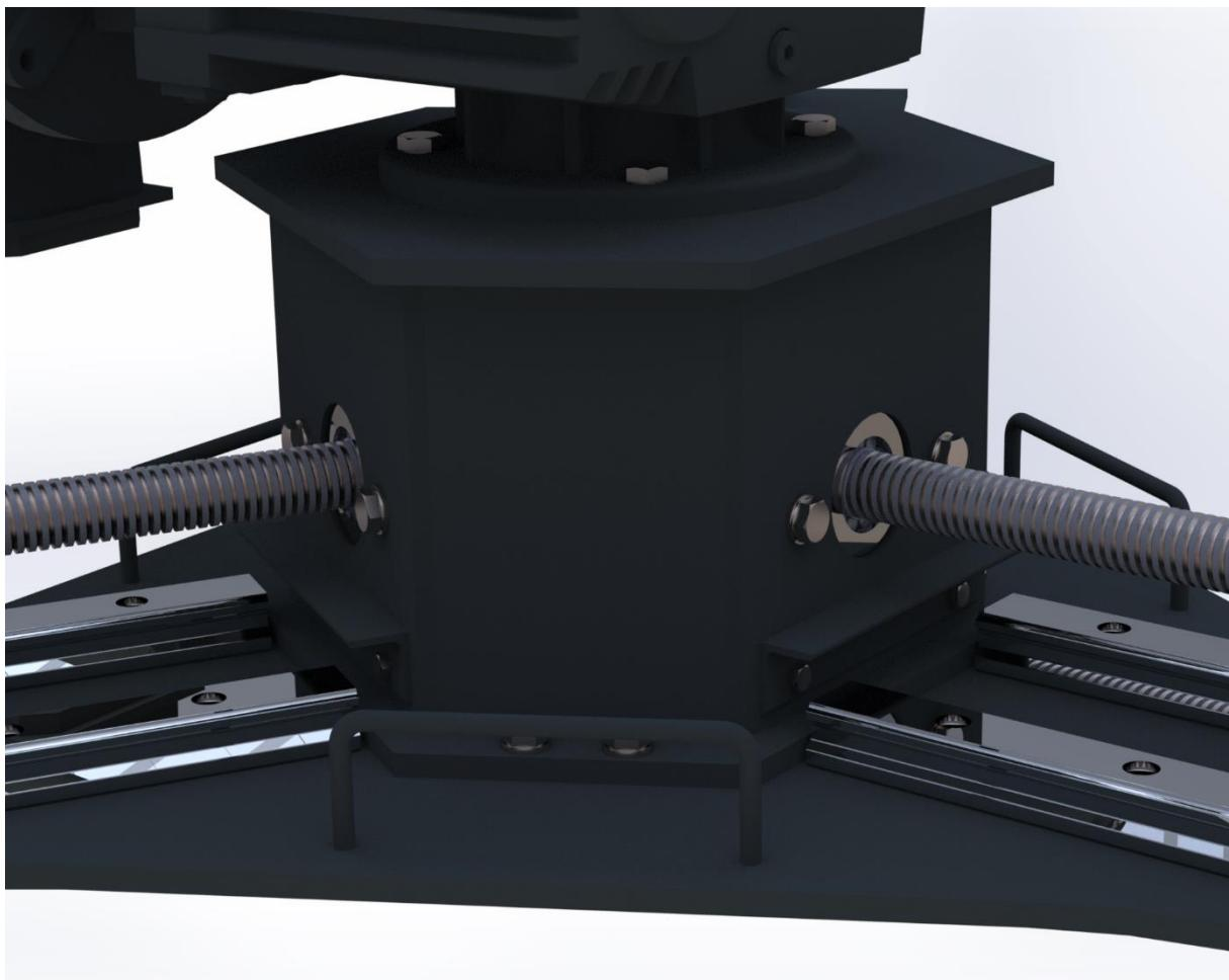
Slika 59. Nosač elektromotora
