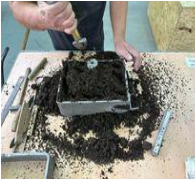
Slika 48 Sabijanje kalupne mješavine
