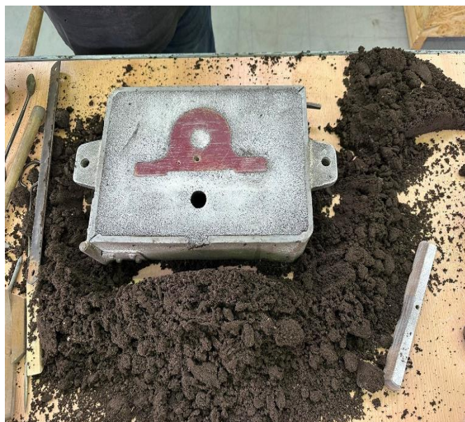
Slika 49 Model odljevka u gornjaku
