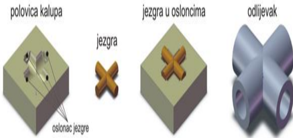
Slika 10 Jezgra, kalup i odljevak [8]
