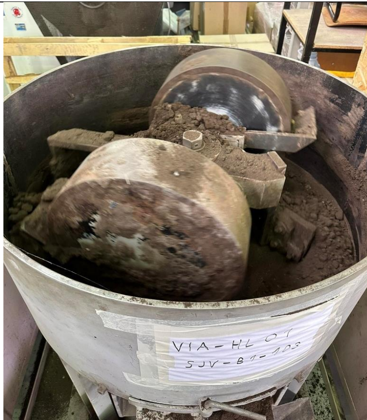
Slika 46 Miješanje kalupne mješavine
