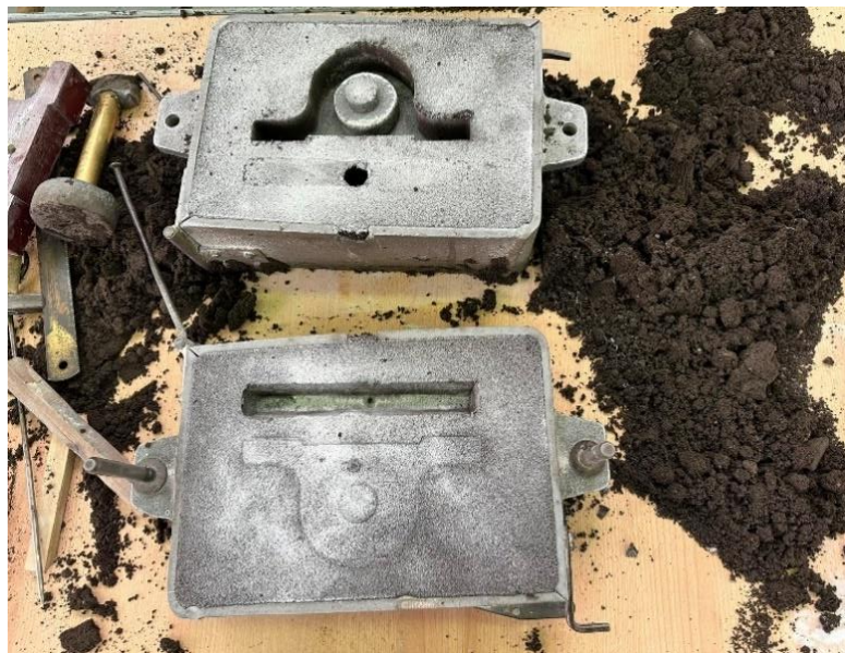
Slika 51 Donjak i gornjak prije zatvaranja kalupa
