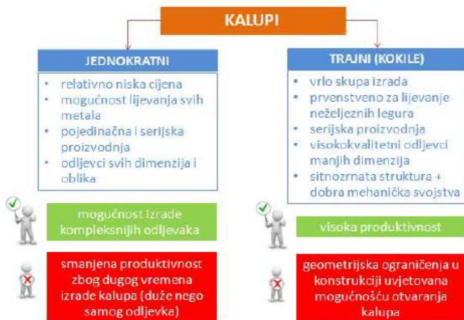
Slika 5 Značajke jednokratnih i trajnih kalupa [4]
