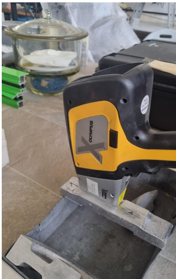
Slika 59 Određivanje kemijskog sastava odljevka XRF metodom
