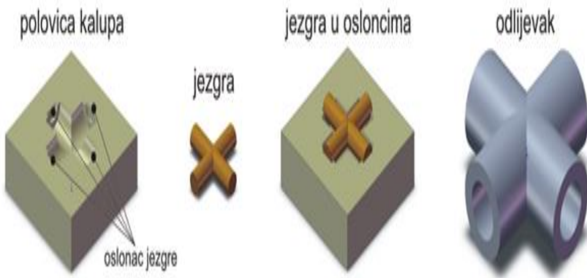
Slika 10 Jezgra, kalup i odljevak [8]
