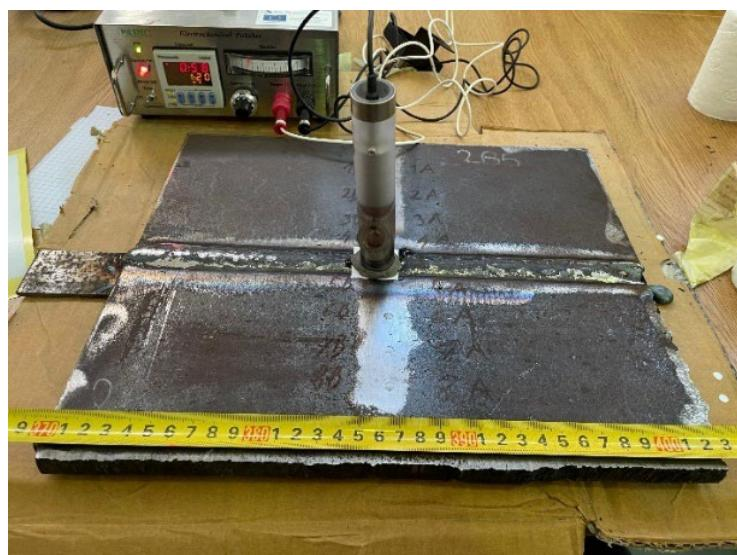
Slika 57. Elektropoliranje nadvišenja zavara
