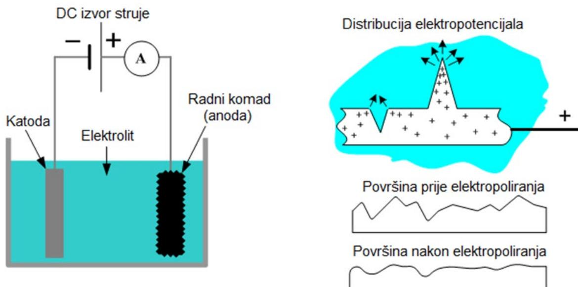
Slika 26. Shema elektropoliranja [30]
