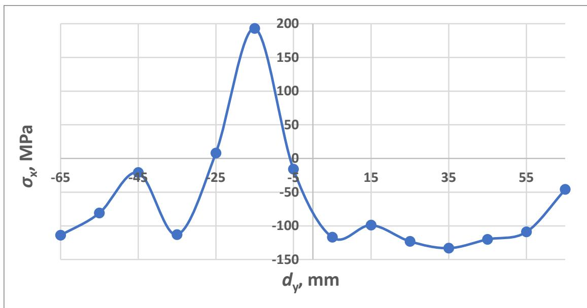
Slika 35. Raspodjela  $\sigma_x$  zaostalih naprezanja u uzorku kutnog spoja
