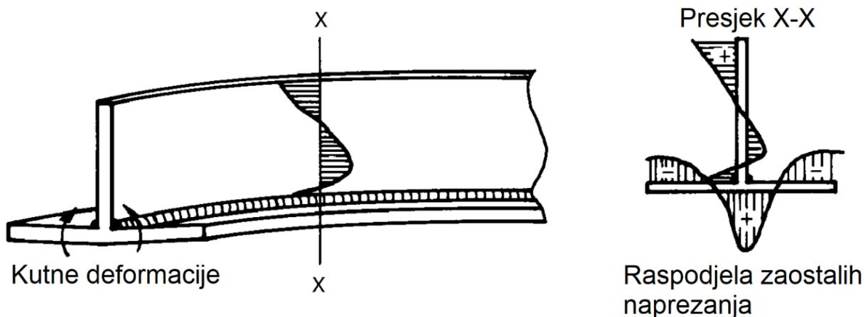
Slika 36. Raspodjela zaostalih naprezanja kod zavarenog kutnog T-spoja [7]
