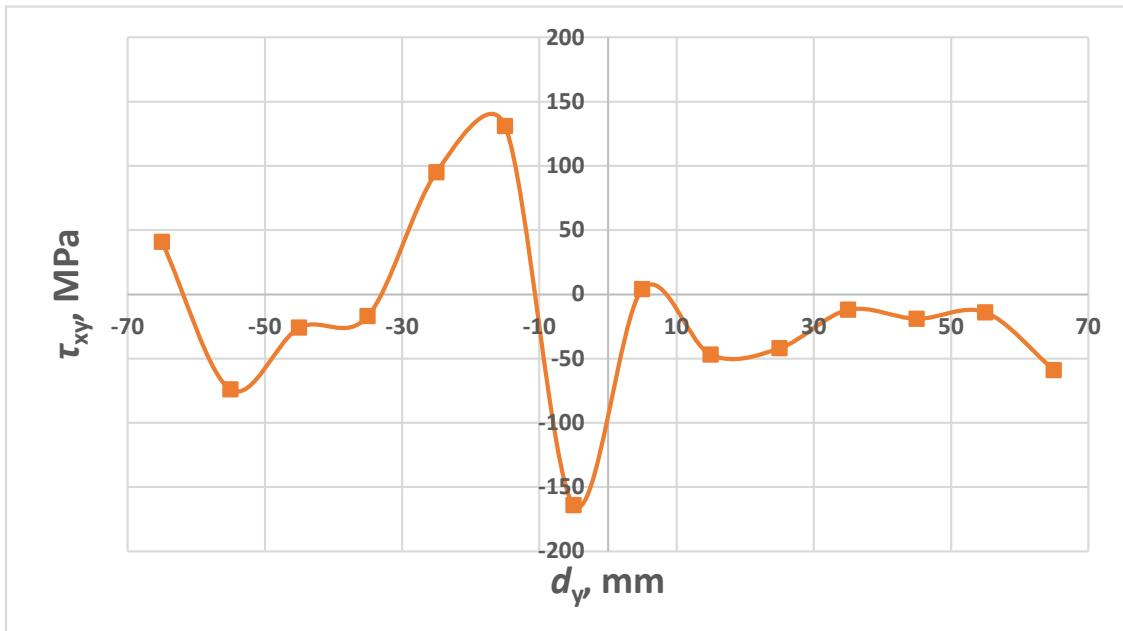
Slika 37. Raspodjela  $\tau_{xy}$  naprezanja u uzorku kutnog spoja
