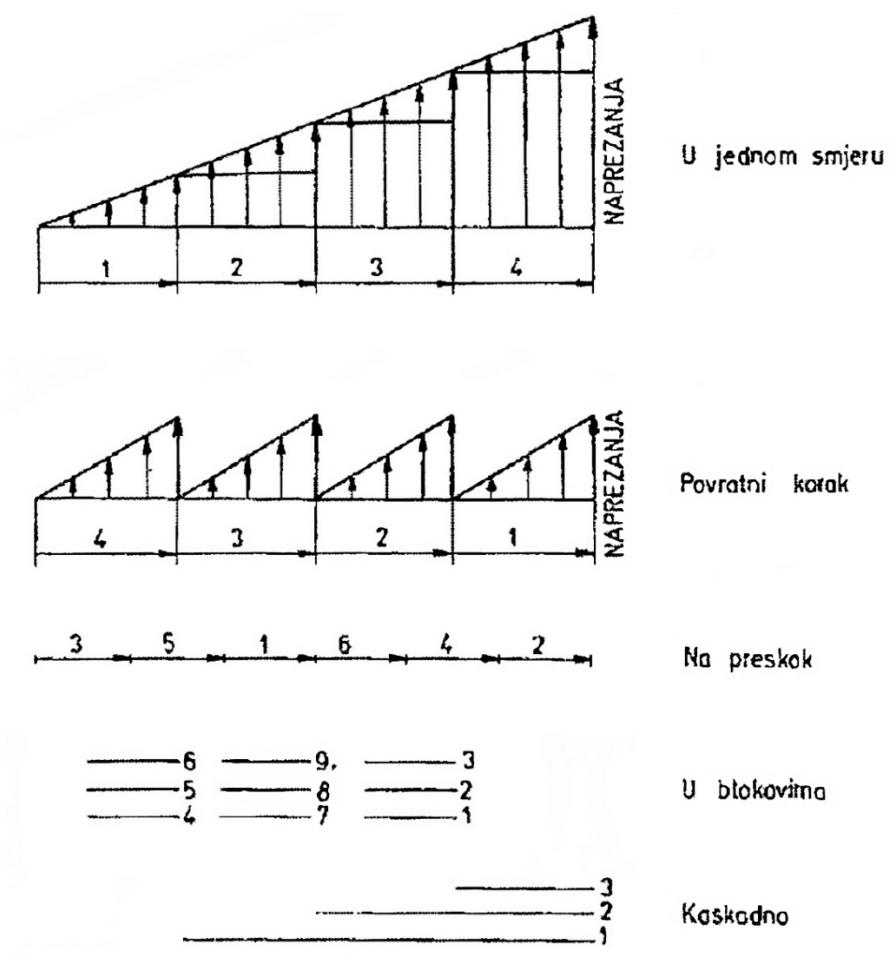
Slika 12. Prikaz različitih redoslijeda zavarivanja i njihov utjecaj na raspodjelu i intenzitet zaostalih naprezanja u zavaru [14]
