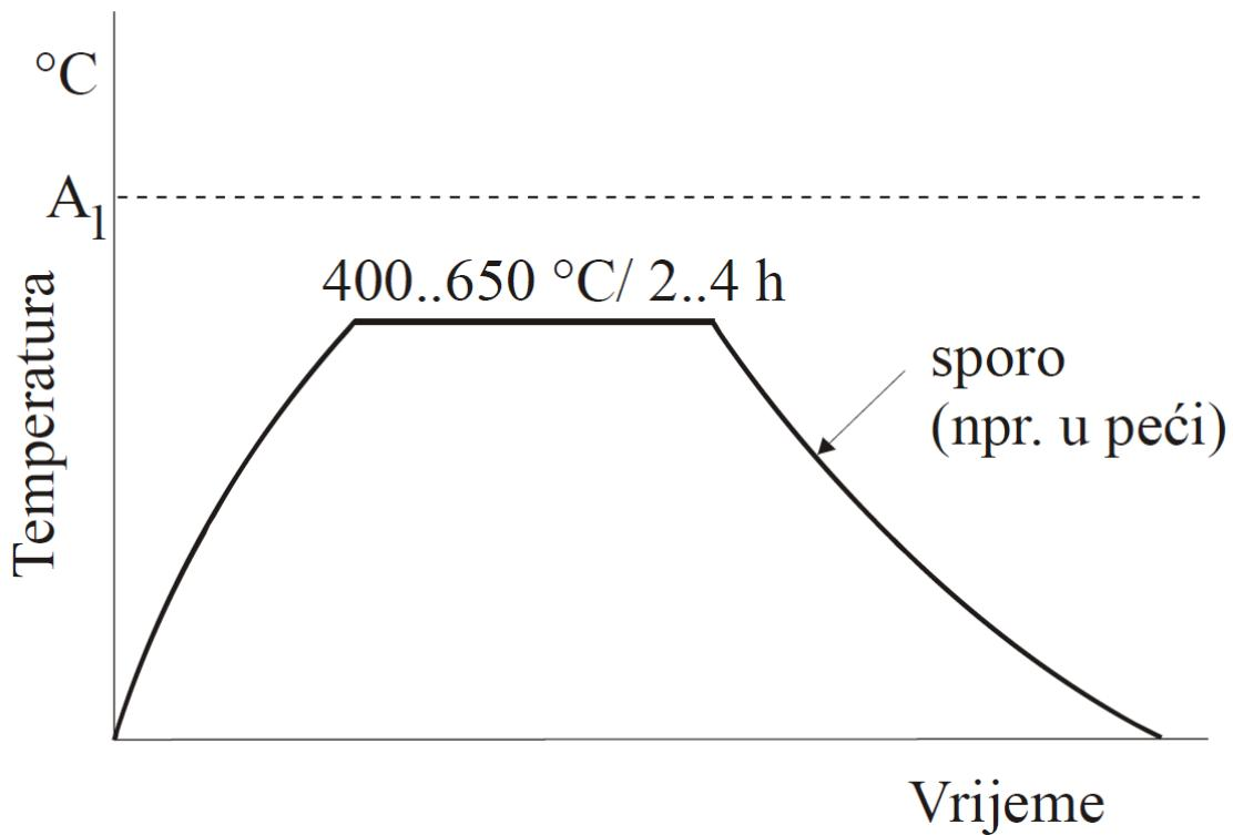
Slika 14.  $\theta$ -t dijagram žarenja za redukciju zaostalih naprezanja [17]
