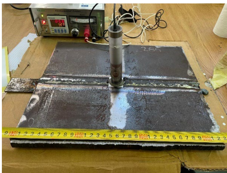
Slika 57. Elektropoliranje nadvišenja zavara
