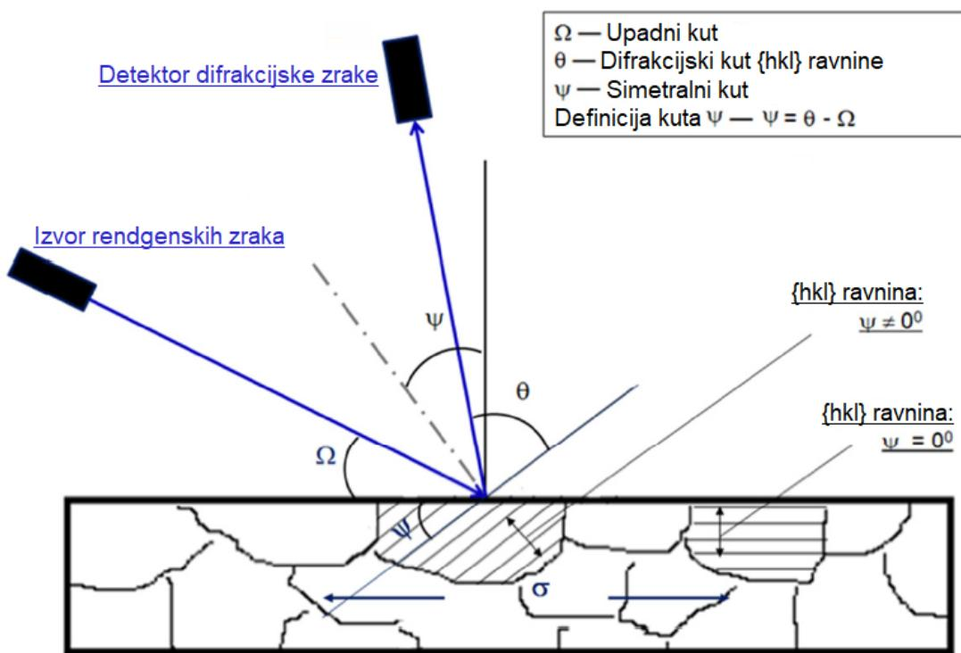
Slika 21. Shematski prikaz  $\sin^2 \psi$  metode [27]
