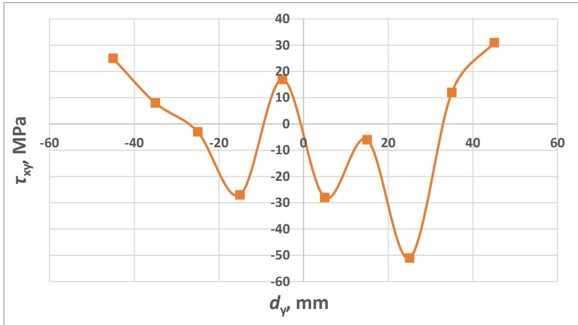
Slika 41. Raspodjela  $\tau_{xy}$  zaostalih naprezanja u uzorku kutnog spoja nakon elektropoliranja
