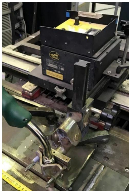
**Slika 29.** Traktor za zavarivanje Bug-O Systems MSD-1002
