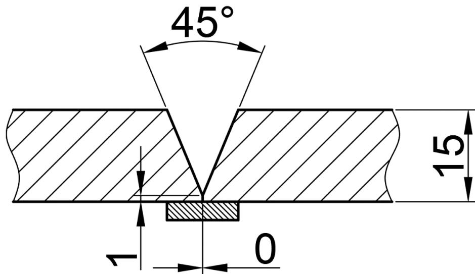
Slika 42. Priprema sučeljenog spoja s podlogom [37]
