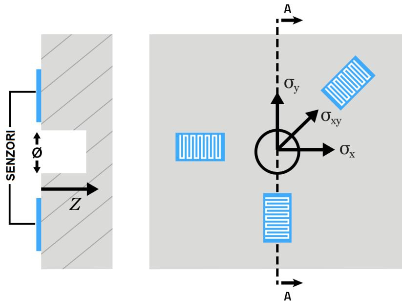
**Slika 16.** Shema metode mjerena zaostalih naprezanja bušenjem prvrta [20]
