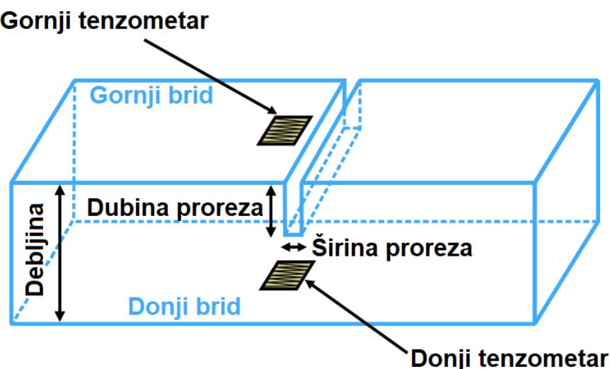
Slika 18. Shema metode mjerena zaostalih naprezanja izrezivanjem proze [20]
