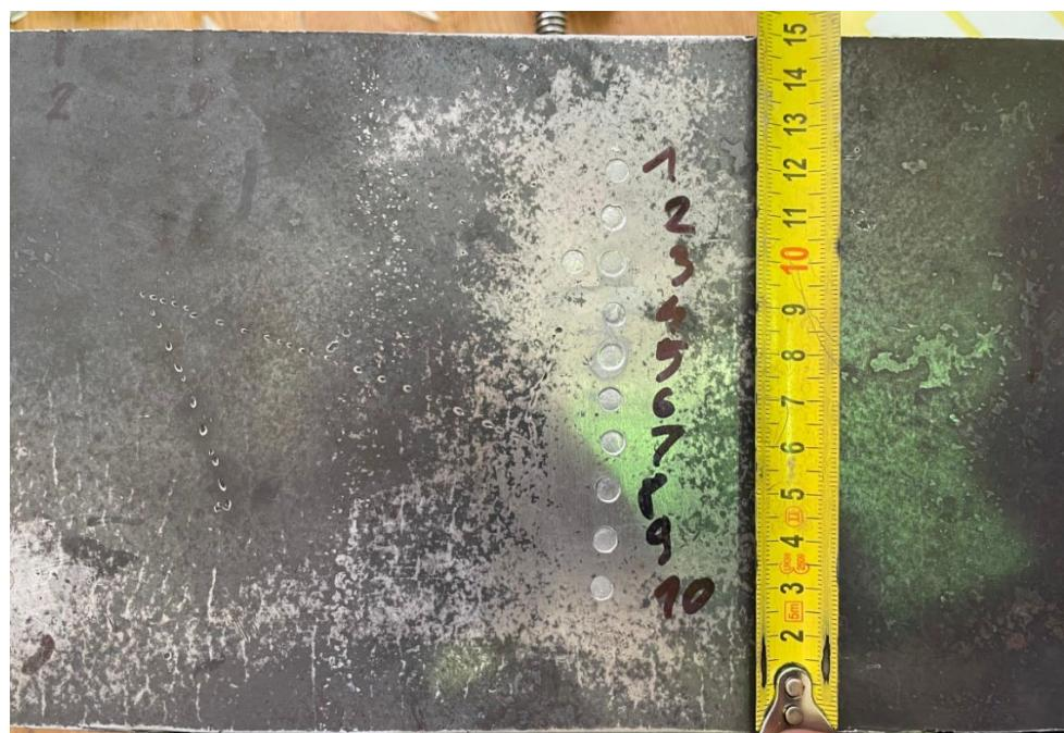
Slika 39. Elektropolirane točke mjerena na uzorku kutnog spoja
