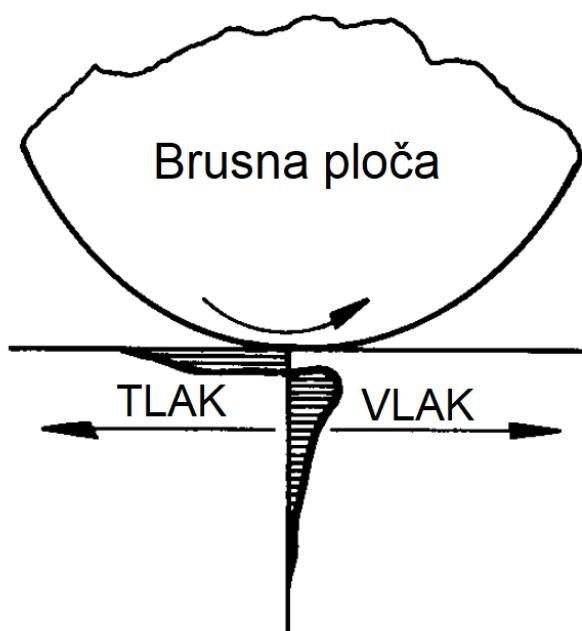
Slika 25. Raspodjela zaostalih naprezanja uslijed brušenja [7]
