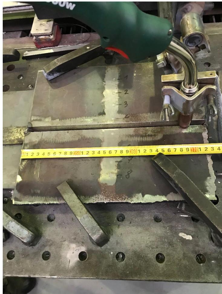
Slika 43. Stegnuti uzorak sučeljenog spoja prije zavarivanja
