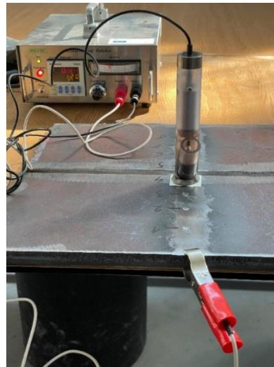
Slika 49. Elektropoliranje uzorka sučeljenog spoja prije zavarivanja
