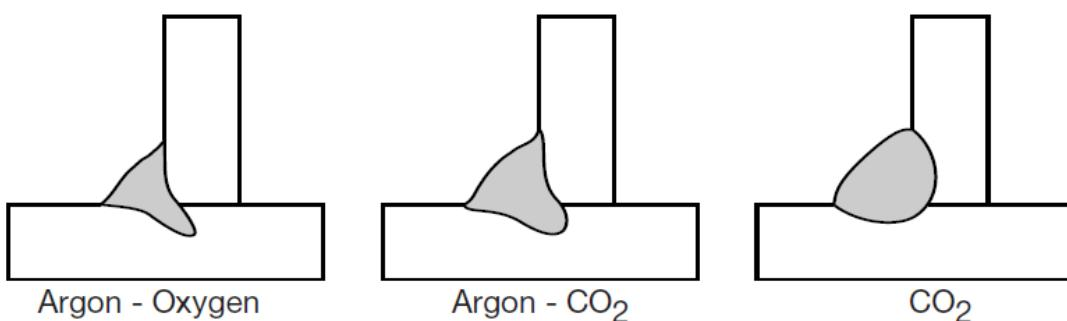
**Slika 4.** Utjecaj  $\text{CO}_2$  i  $\text{O}_2$  u mješavinama s Ar na profil penetracije kod zavarivanja kutnih spojeva [5]
