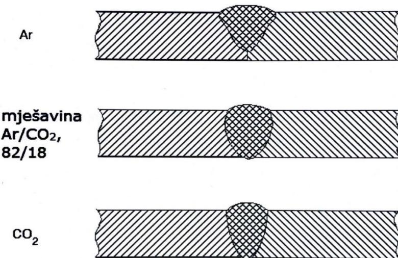
Slika 3. Profil penetracije zavarenog spoja za Ar, CO<sub>2</sub> i mješavinu Ar/CO<sub>2</sub> 82/18 [4]
