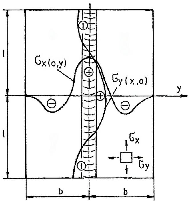
Slika 7. Longitudinalna i transverzalna naprezanja u sučeljenom zavarenom spoju [14]
