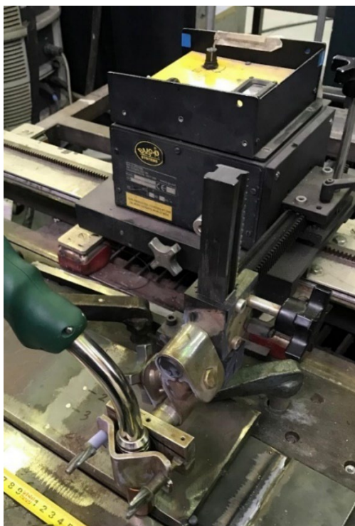
Slika 29. Traktor za zavarivanje Bug-O Systems MSD-1002
