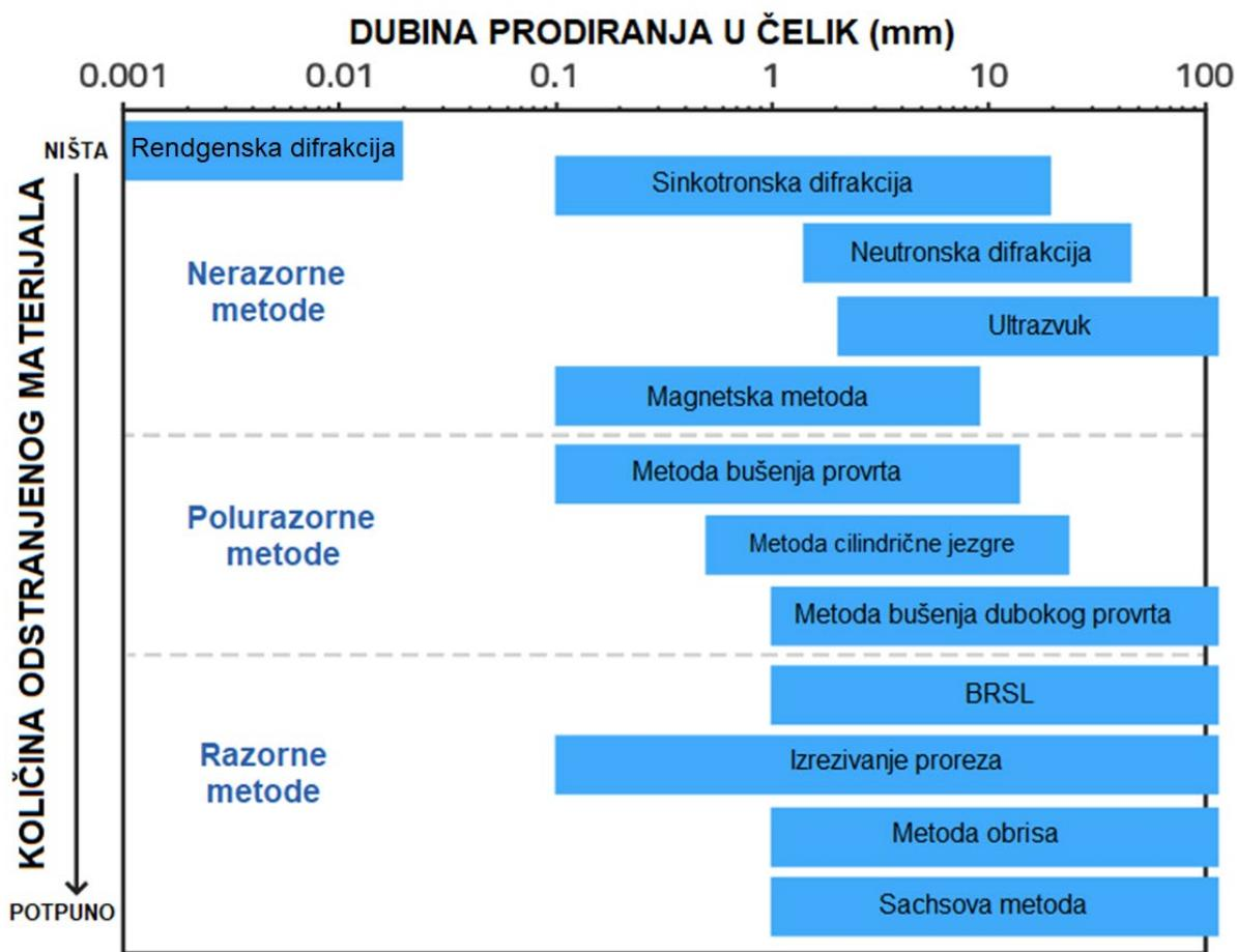
Slika 15. Podjela metoda mjerena zaostalih naprezanja po razornosti i dubini prodiranja [20]
