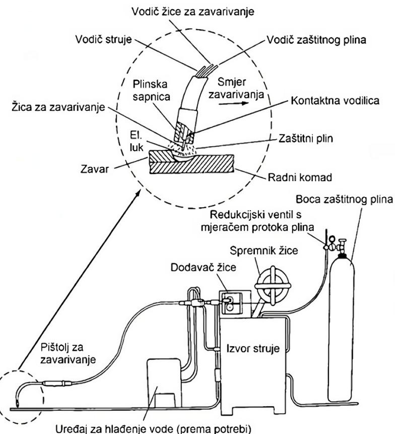
Slika 1. Shema opreme za MIG/MAG zavarivanje [3]
