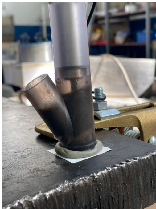
Slika 38. Elektropoliranje uzorka kutnog spoja
