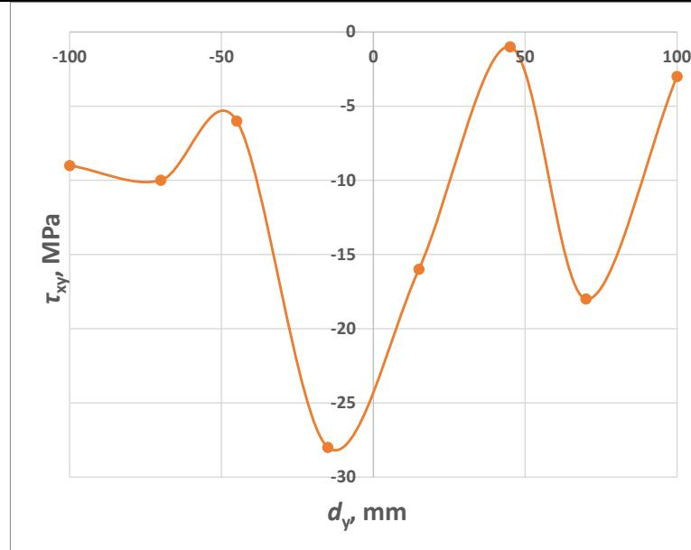
Slika 48. Raspodjela  $\tau_{xy}$  naprezanja u brušenom uzorku sučeljenog spoja prije zavarivanja
