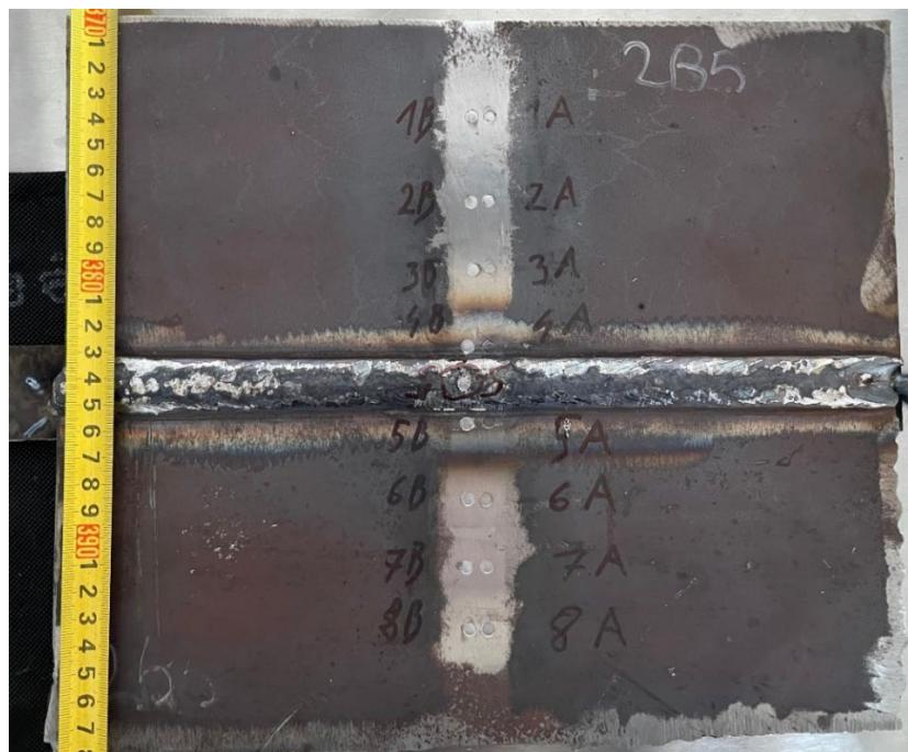
**Slika 58. Točke mjerena zaostalih naprezanja na elektropoliranom uzorku sučeljenog spoja nakon zavarivanja**
