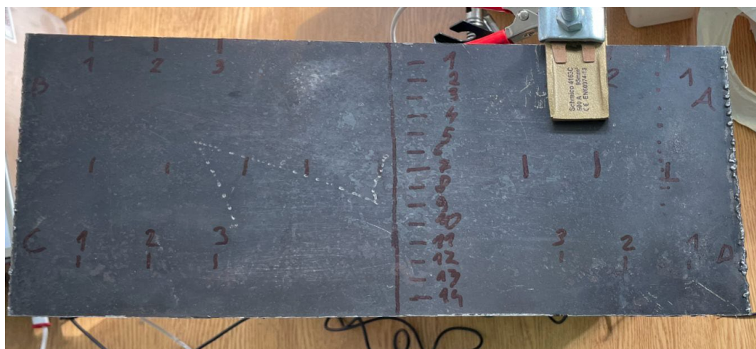
Slika 34. Prikaz označenih točaka mjerenja u transverzalnoj ravni
