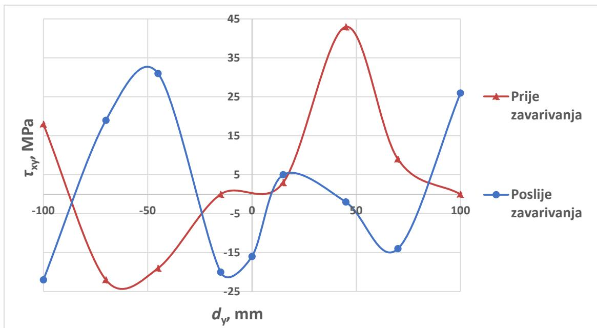
Slika 60. Usporedba  $\tau_{xy}$  naprezanja na elektropoliranom uzorku sučeljenog spoja nakon zavarivanja
