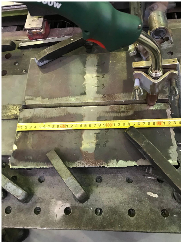
Slika 43. Stegnuti uzorak sučeljenog spoja prije zavarivanja
