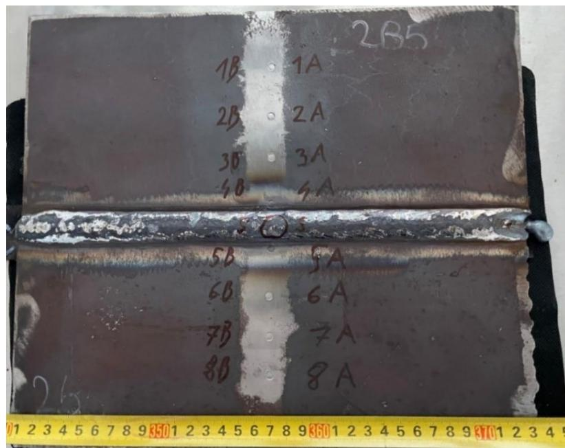
**Slika 54.** Točke mjerena zaostalih naprezanja na brušenom uzorku sučeljenog spoja nakon zavarivanja
