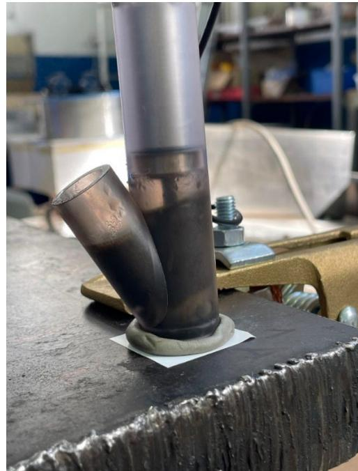
Slika 38. Elektropoliranje uzorka kutnog spoja
