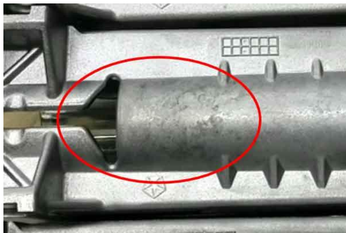
Slika 25. Primjer tragova protoka na odljevku [9]
