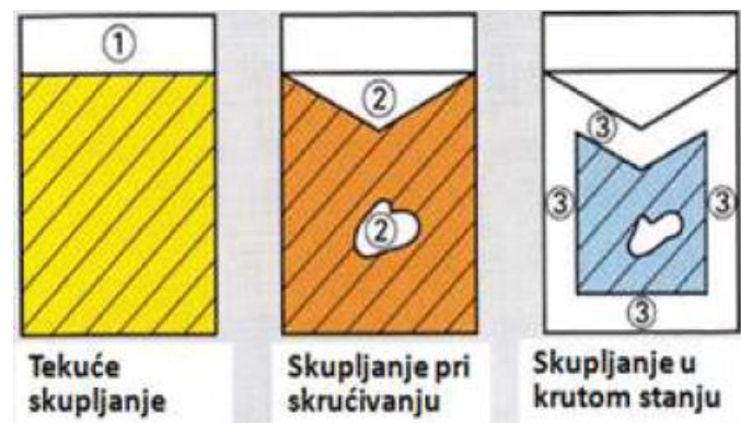
Slika 19. Skupljanje metala prilikom hlađenja taljevine, skrućivanja te hlađenja skrutnutog odljevka [1]
