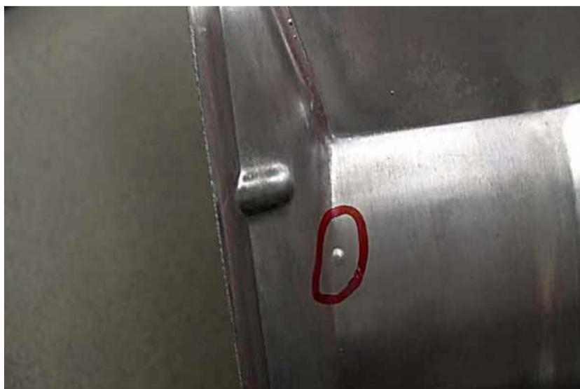
Slika 22. Primjer mjehuravosti površine [9]
