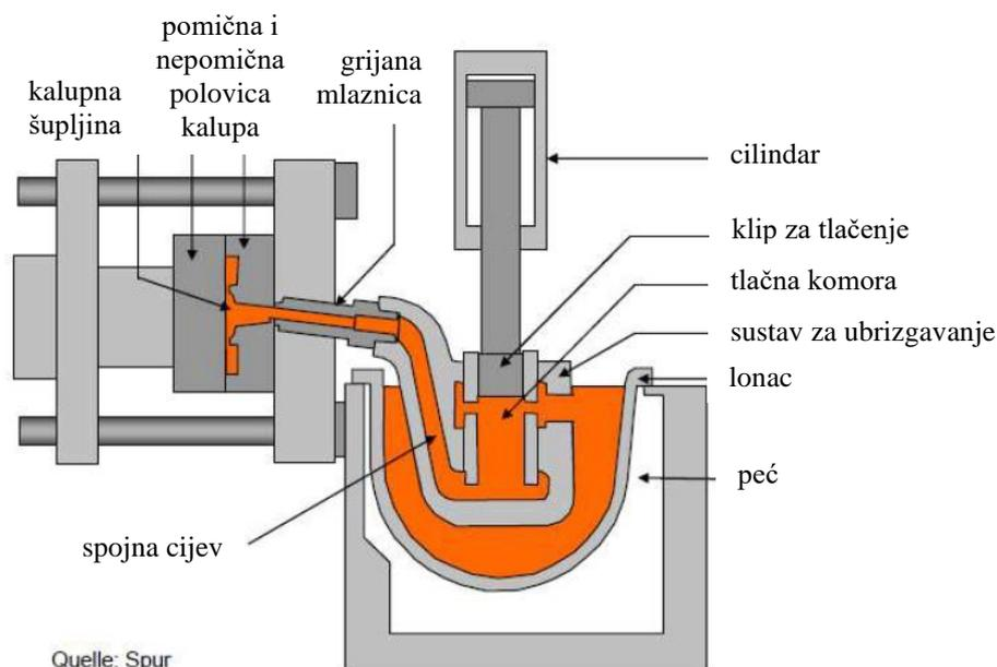
Slika 3. Dijelovi tlačnog stroja s toplom komorom [1].
