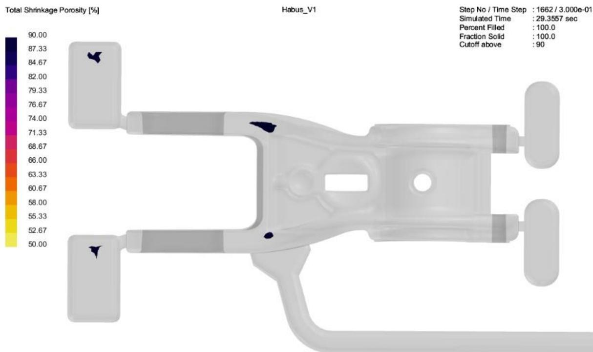
Slika 49. Poroznost na odljevku – pogled na cijeli odljevak
