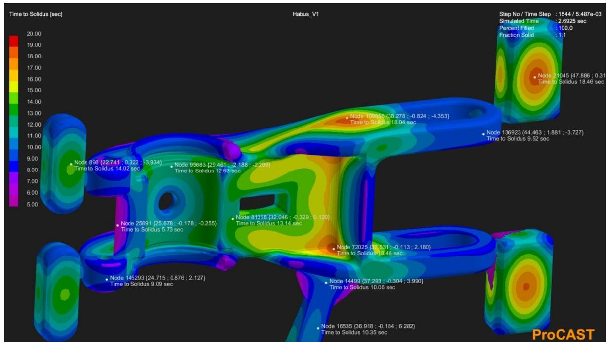
Slika 51. Vrijeme do solidus temperature pojedinih dijelova odljevka
