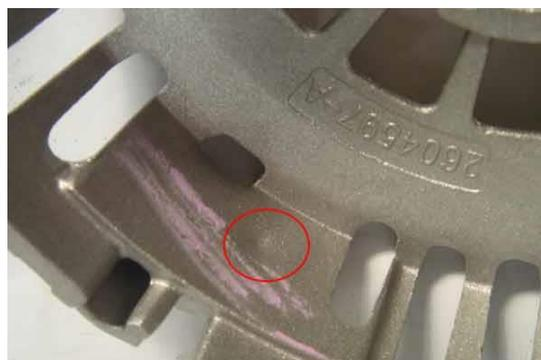
Slika 28. Primjer udubine na površini odljevka [9]
