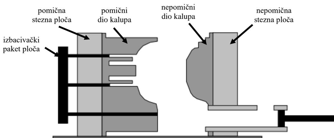
Slika 8. Skica kalupa za tlačni lijev [1]
