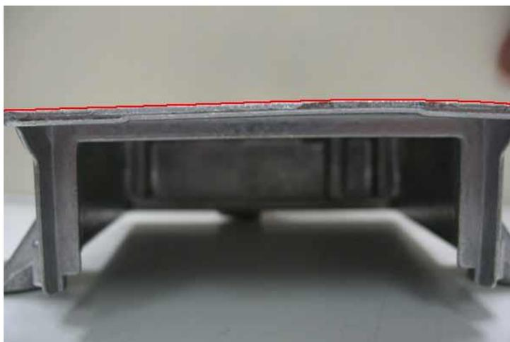
**Slika 23. Primjer deformacije odljevka [9]**
