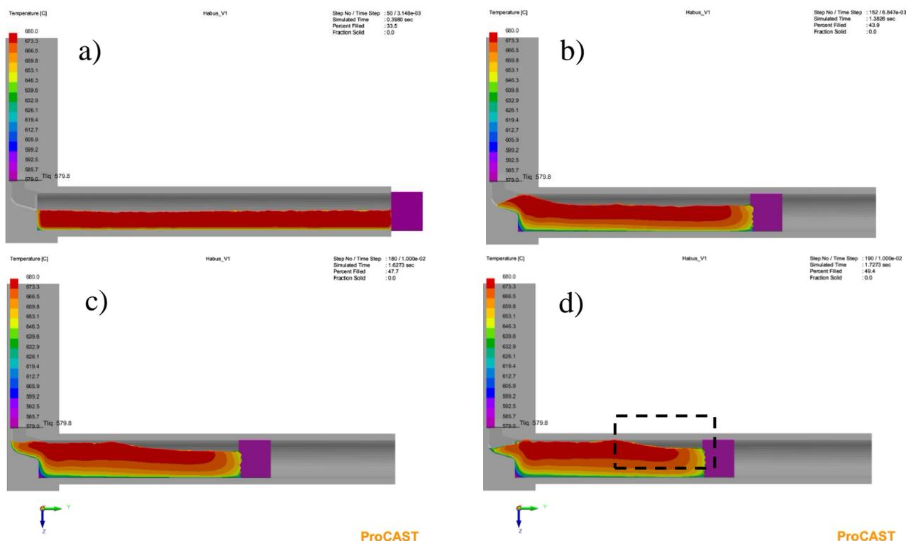
Slika 35. Brzina klipa u prvoj fazi  $v_1=0,2$  m/s
