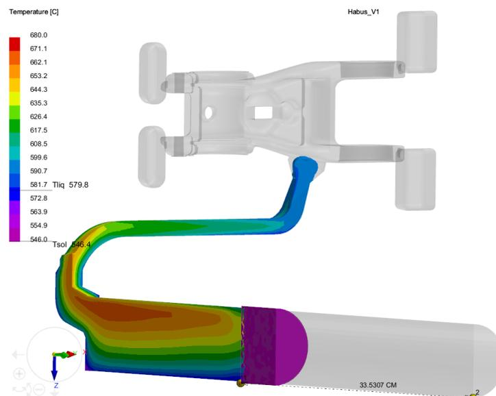
Slika 38. Trenutak naglog ubrzanja klipa tlačne komore
