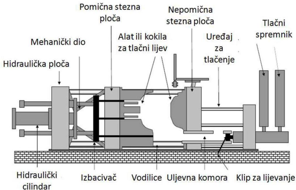
Slika 4. Stroj za tlačno lijevanje s hladnom komorom [1]
