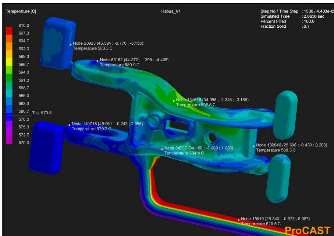
Slika 43. Temperatura pojedinog dijela odljevka pri kraju ulijevanja
