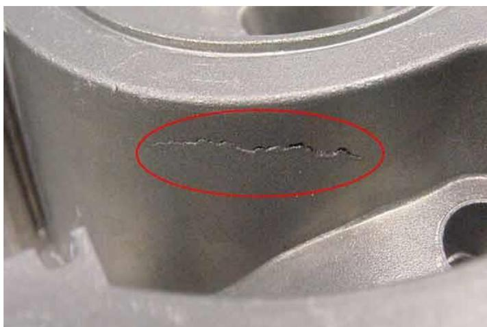
**Slika 20. Primjer pukotine na odljevku [9]**
