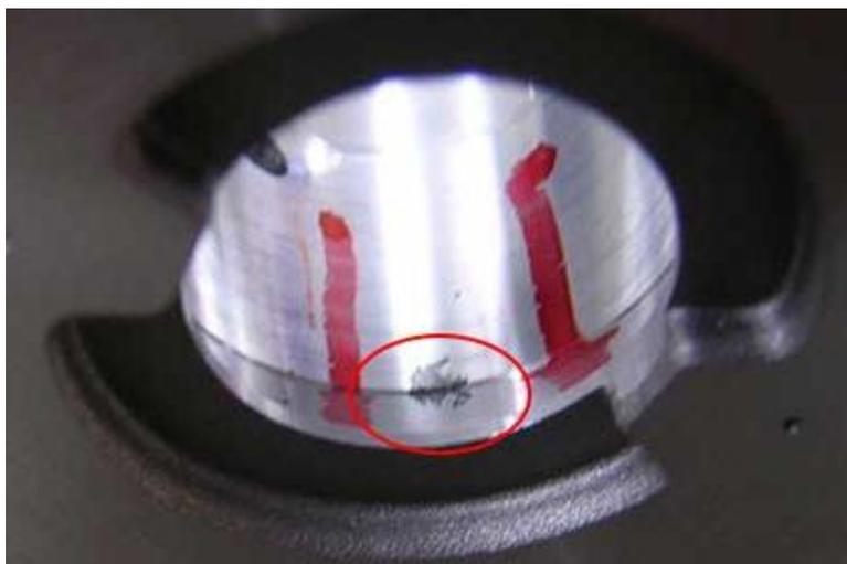
Slika 21. Primjer uključka na površini odljevka [12]
