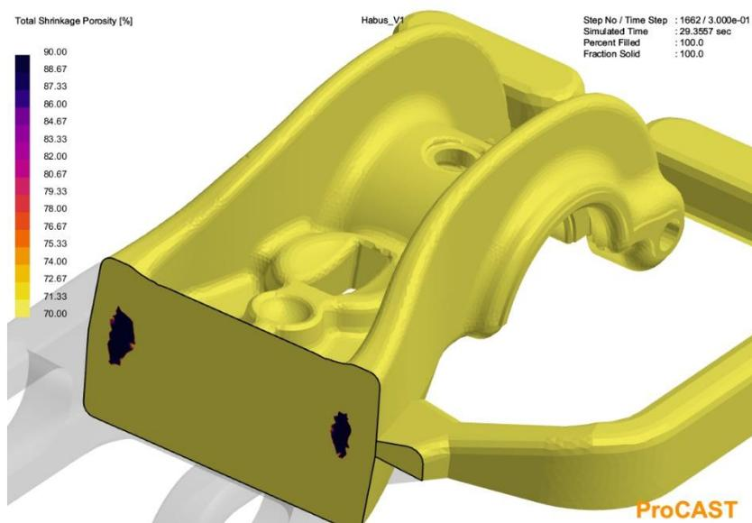
**Slika 50. Poroznost na odljevku – presjek odljevka**
