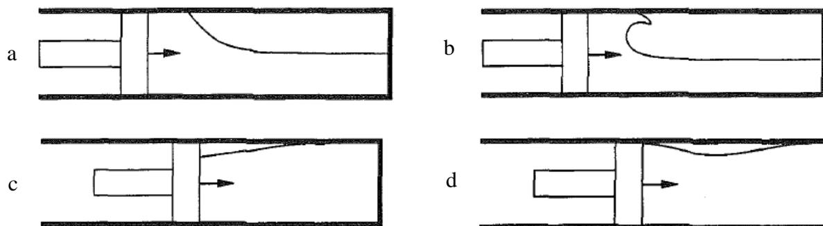
**Slika 9. Mogući profili valova unutar komore ljevačkog stroja [4]**
