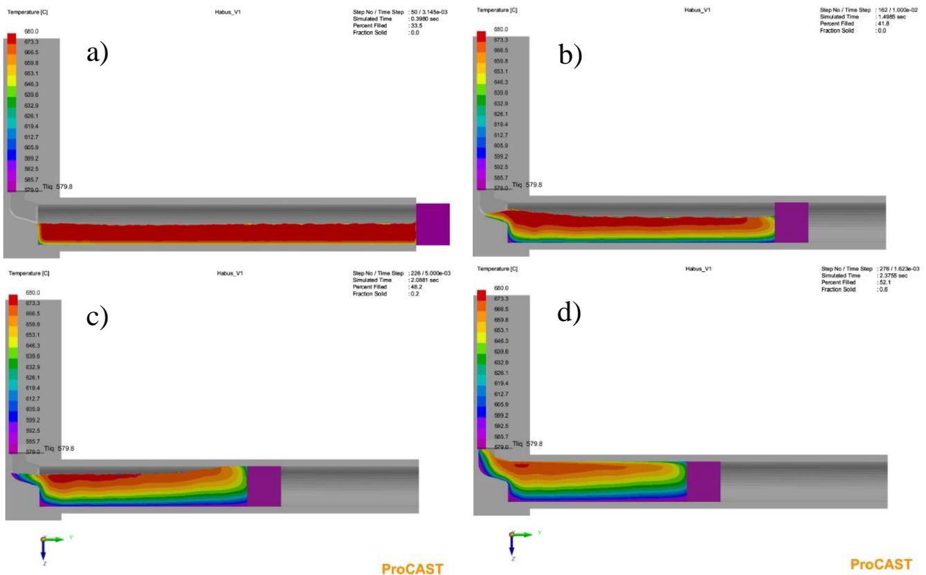
Slika 36. Brzina klipa u prvoj fazi  $v_1=0,15$  m/s
