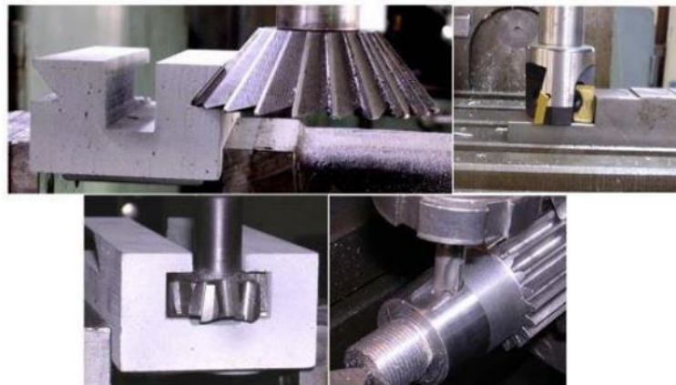
Slika 17. Postupci glodanja vertikalnom glodalicom
