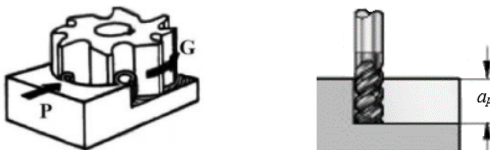
Slika 22. Čeono glodanje: a) glavno i posmično gibanje; b) dubina rezanja a_p
