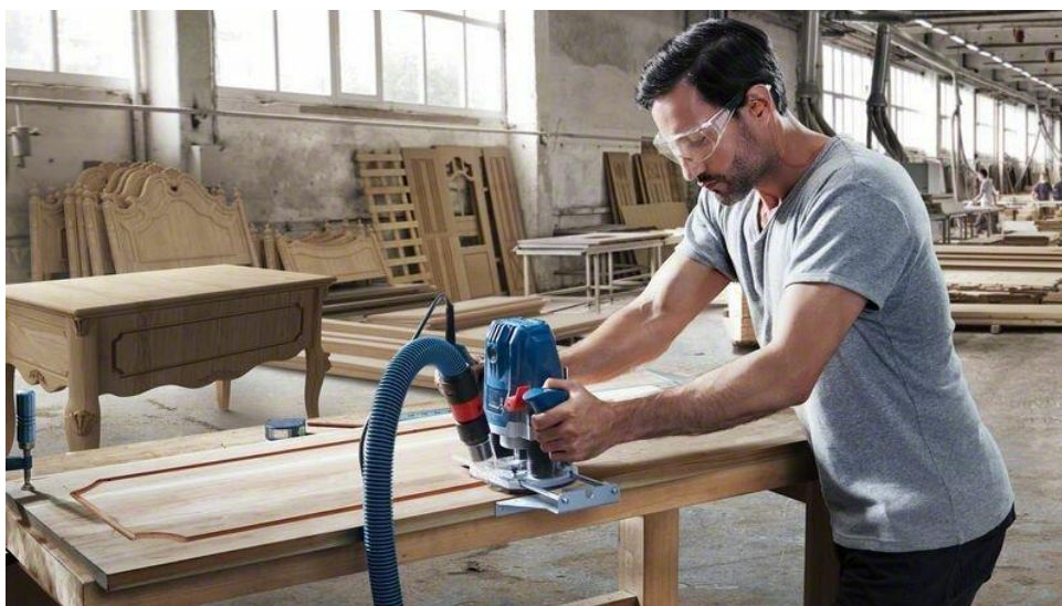
Slika 24. Primjena vertikalne glodalice u obradi drvenih komada [30]
