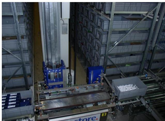
**Slika 42.** Utovar/istovar spremnika s dizalice na konvejere
