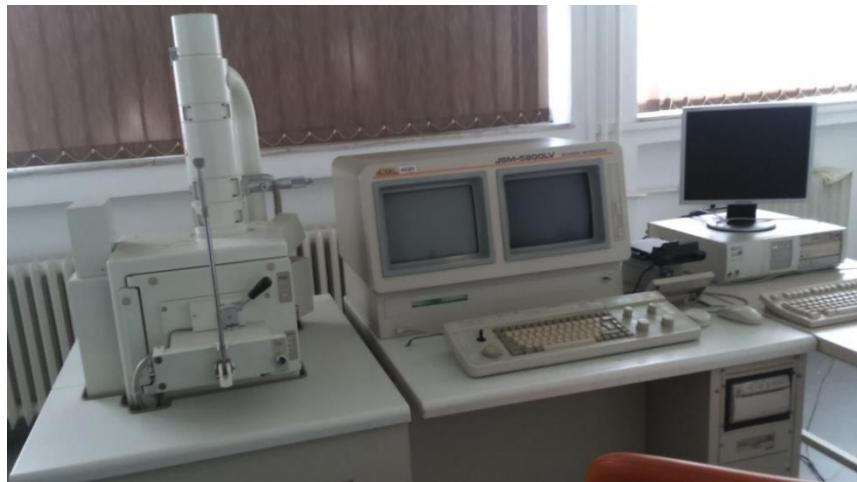
**Slika 5.4** Elektronski mikroskop SEM JOEL JSM-5800 LV
