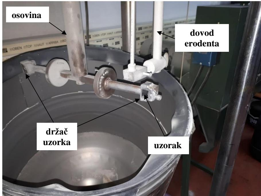
Slika 5.17 Uređaj za ispitivanje erozijom krutim česticama
