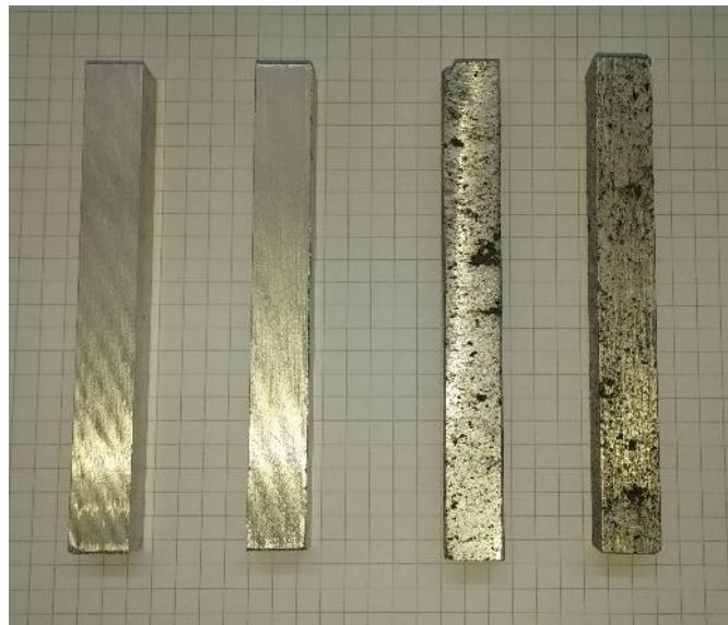
**Slika 5.9** Uzorci kompozita pripremljeni za kutno istiskivanje
