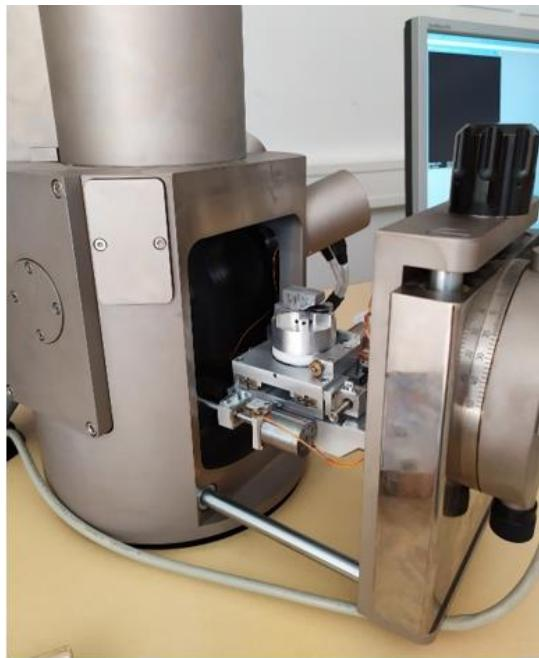
**Slika 5.13** Pretražni elektronski mikroskop SEM Tescan Vega TS5136MM
