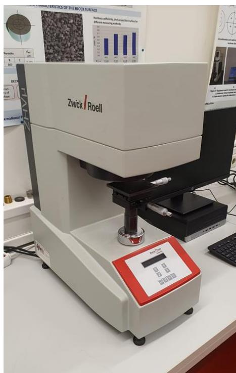
**Slika 5.15** Tvrdomjer ZHV $\mu$ -ST (Zwick/Roell/Indentec)
