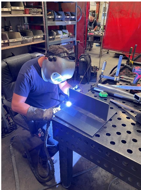
Slika 24. Priprema kutnog spoja i ukrućivanje ploča
