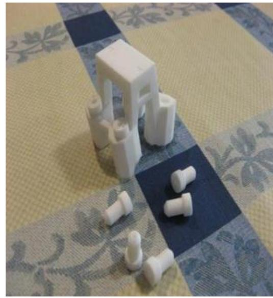
Slika 12. 3D ispisani predložak za vođenje svrdla [11]
