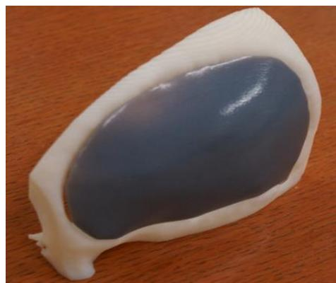
Slika 30. 3D ispisani model defekta i prototip implantata
