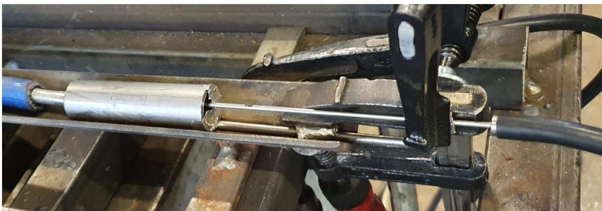
Slika 7. Mjerenje udjela kisika sapnicom oksimetra
