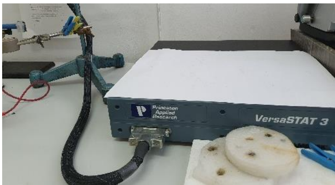
Slika 18. VersaSTAT potenciometar i galvanometar
