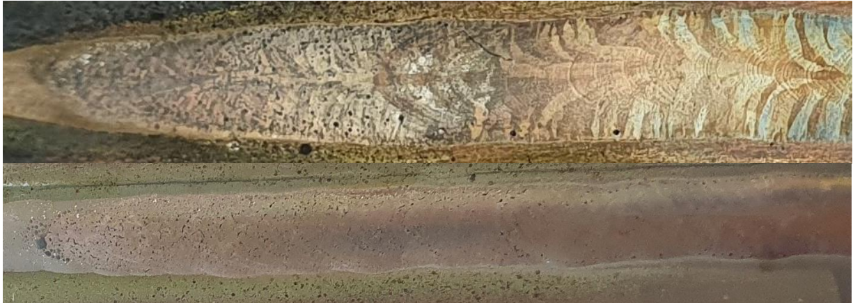
Slika 20. Točkaste formacije oksida
