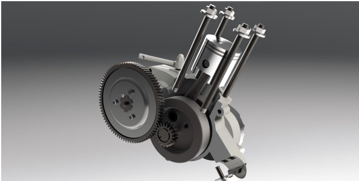
Slika 26. Redukcijski stupanj i klipni mehanizam
