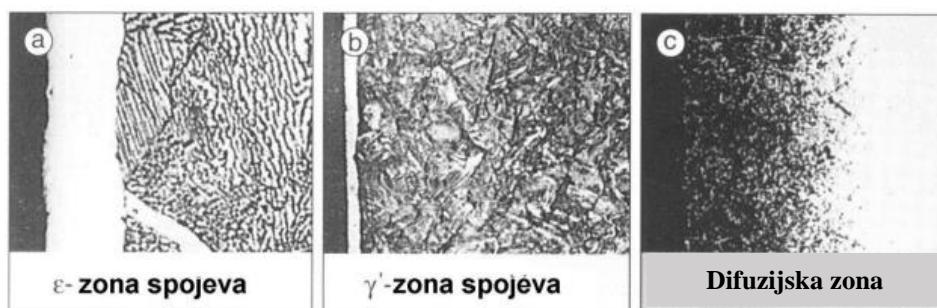
**Slika 11. Mikrostruktura plazma nitriranih slojeva [9]**
