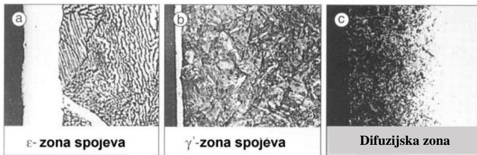
Slika 11. Mikrostruktura plazma nitriranih slojeva [9]
