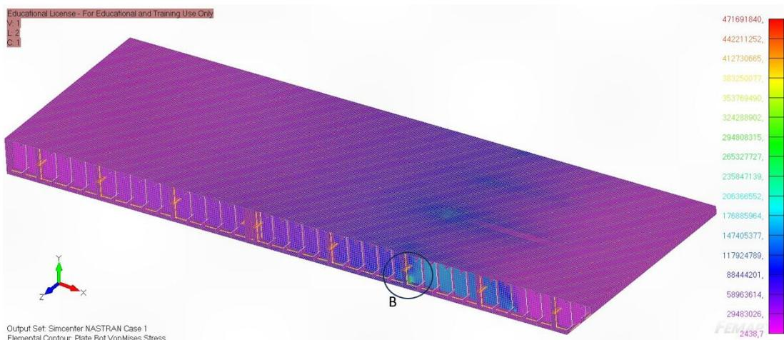
**Slika 32.** Naprezanja mreže za opterećenja nakon Analize 2
