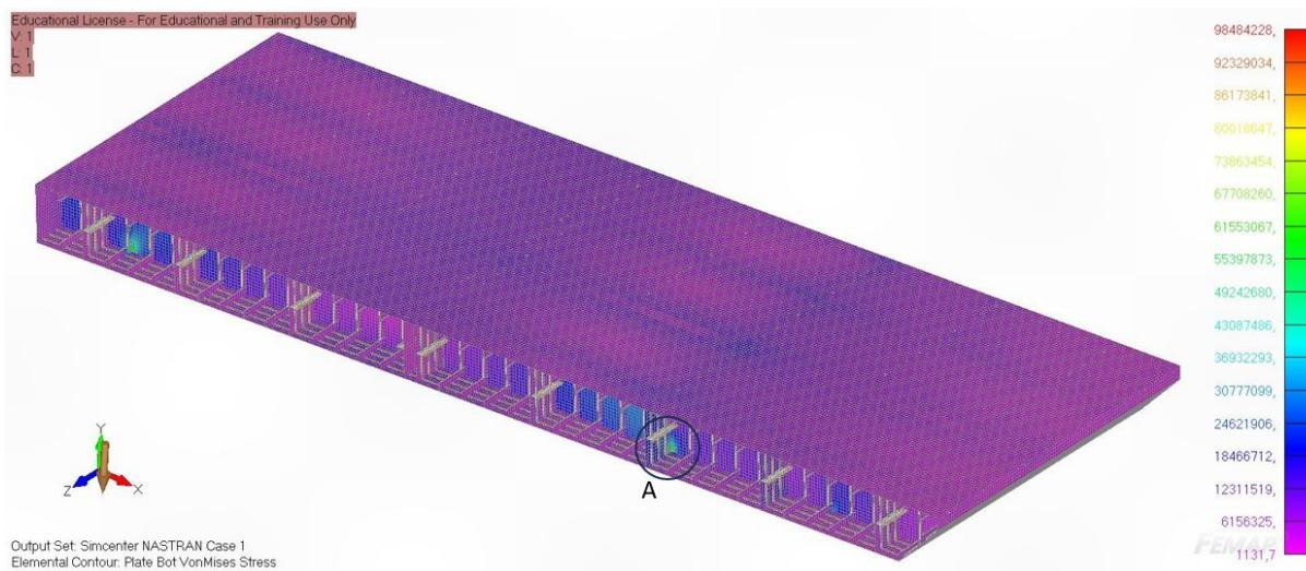
**Slika 23.** Naprezanja mreže za opterećenja nakon Analize 1
