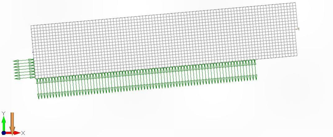
**Slika 31.** Prikaz raspodjele hidrostatskog tlaka po površini
