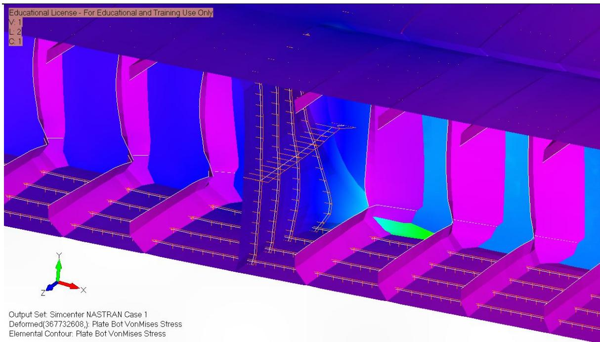
**Slika 35.** Jače skaliran detalj B raspodjele naprezanja mreže
