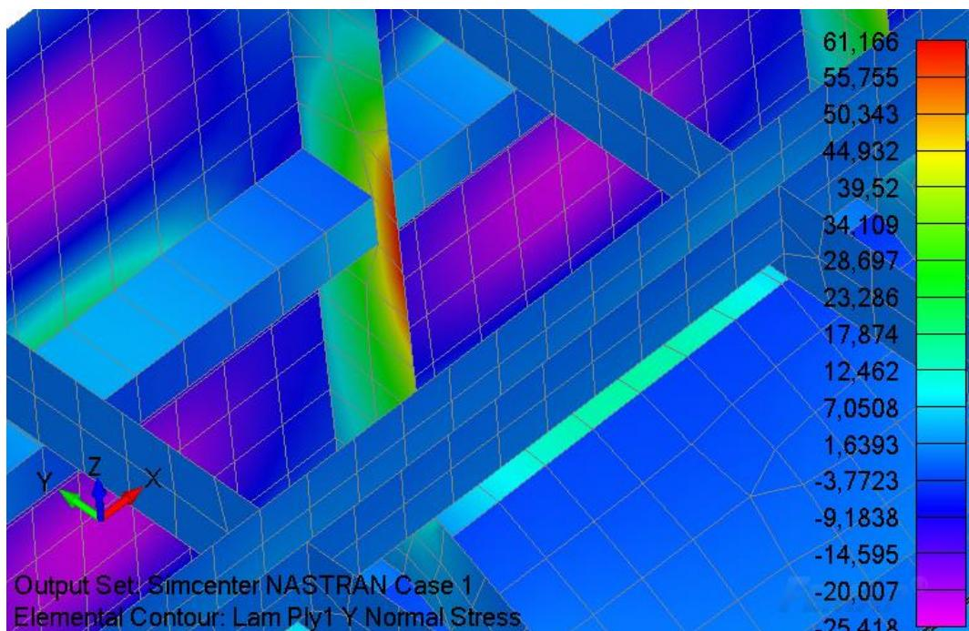
**Slika 8.9 Vlačno naprezanje u smjeru materijalne osi 2 nakon popunjavanja rupe u rebru**
