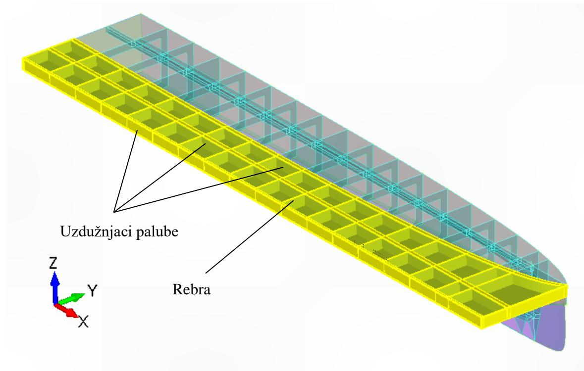
**Slika 2.3 Prikaz strukture palube bez gornje oplate**
