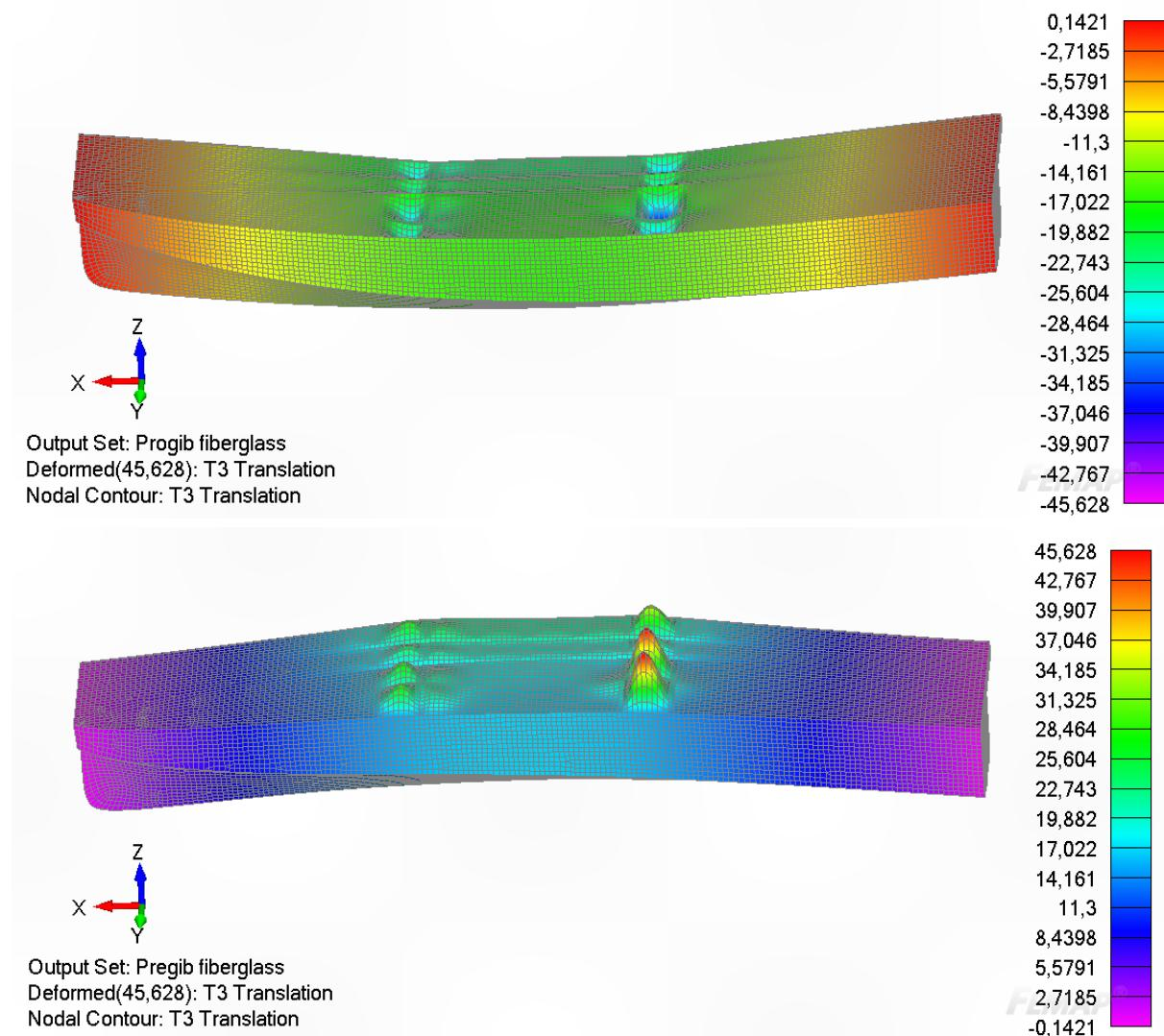
Slika 7.22 Polje progiba na deformiranom trupu od stakloplastike
