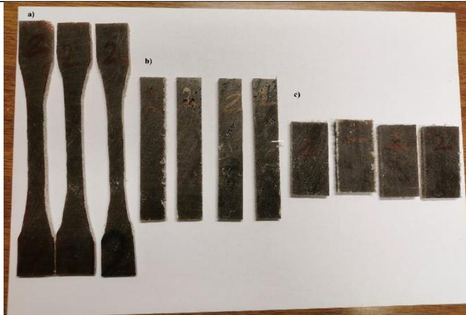
Slika 5.1 Ispitivani uzorci biokompozitnog laminata [24]
