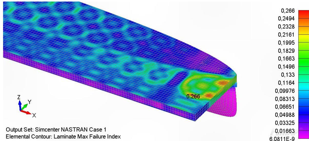
**Slika 7.32 Najveći indeks popuštanja za hidrostatsko opterećenje palube**
