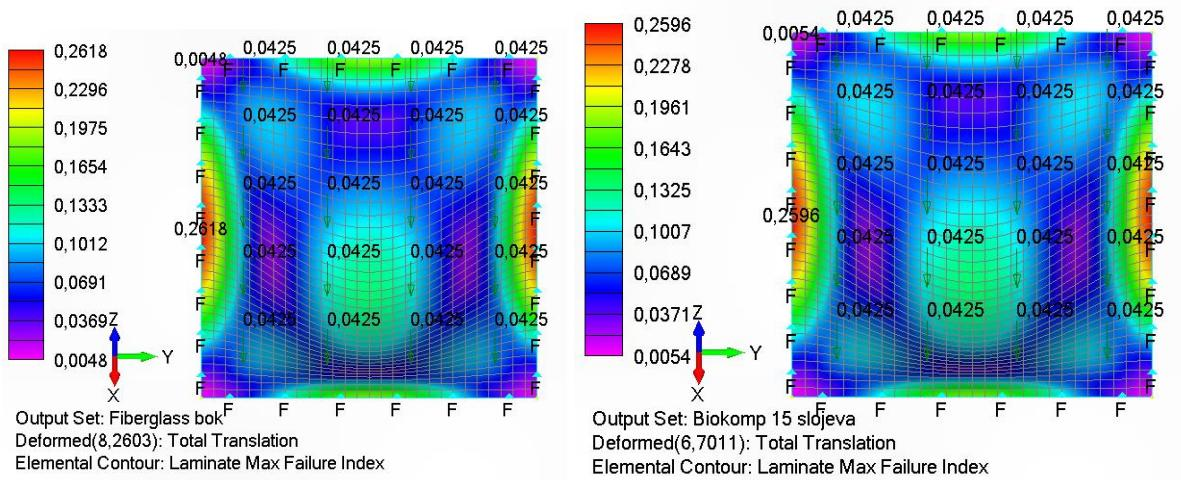
**Slika 6.4 Najveći indeksi popuštanja na panelu boka****Lijevo stakloplastika, desno biokompozit**
