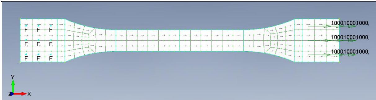
**Slika 5.5 MKE model vlačnog testa**
