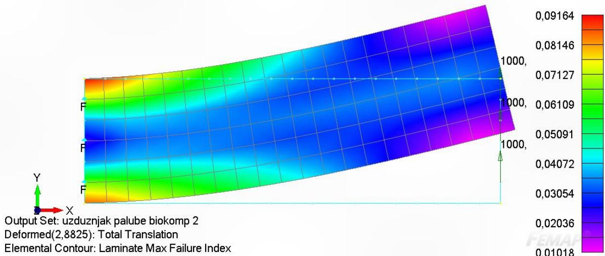
**Slika 6.12 Uzdužnjak palube: rubni uvjeti, diskretizacija i najveći indeksi popuštanja iznad stakloplastika, ispod biokompozit**
