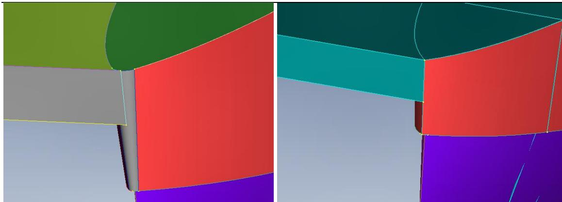
Slika 7.5 Pojednostavljenje geometrije vrha trupa
