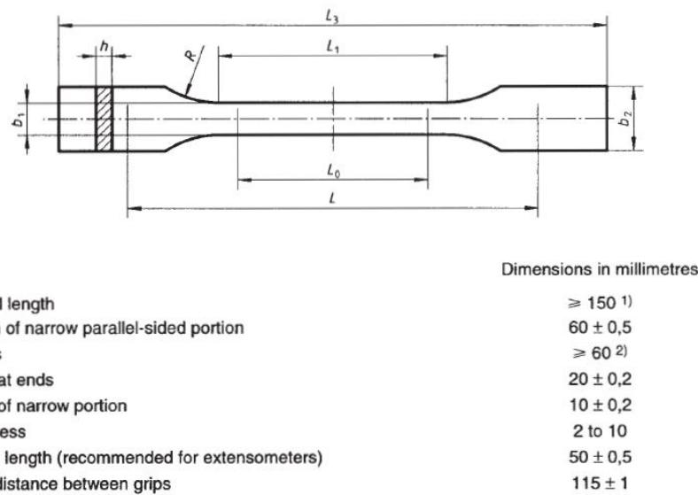
Slika 5.3 Dimenzije epruvete za vlačni test [27]
