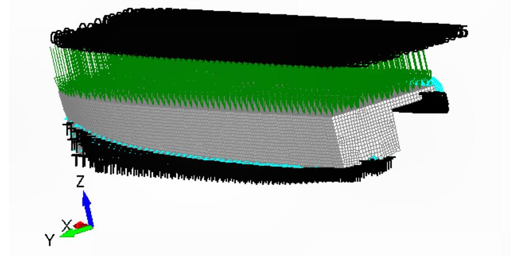
**Slika 7.31 Rubni uvjeti kod hidrostatskog opterećenja palube**
