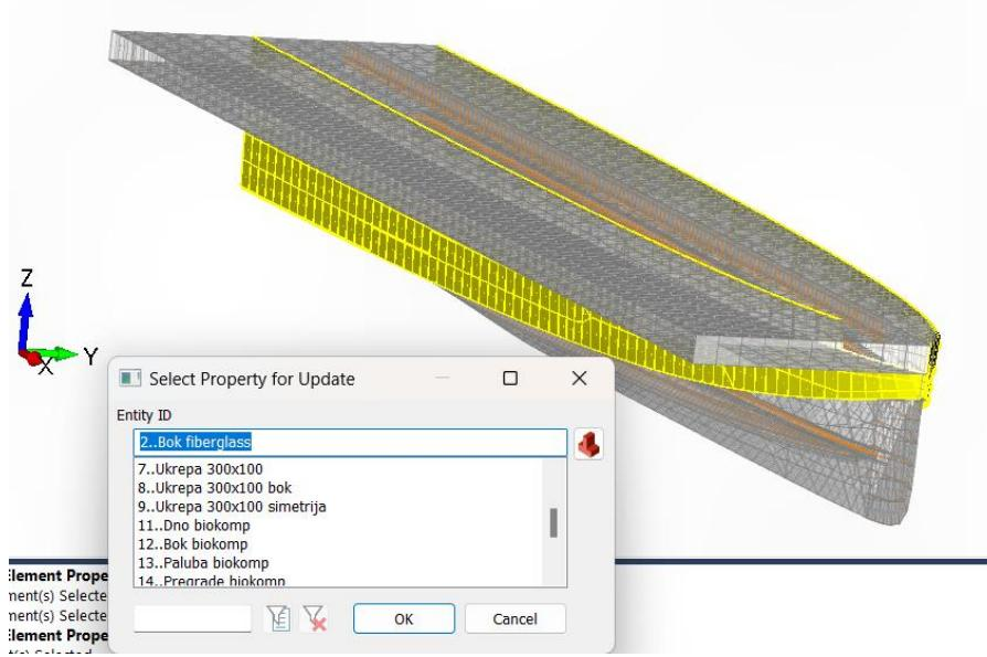
Slika 7.14 Zamjena laminata stakloplastike sa biokompozitom na boku
