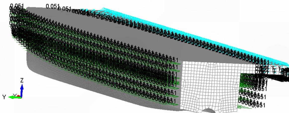
**Slika 7.29 Rubni uvjeti kod hidrostatskog opterećenja panela boka**
