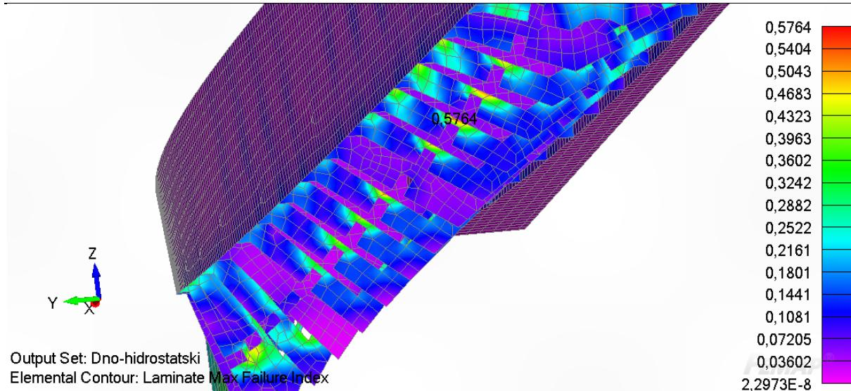
**Slika 7.27 Najveći indeks popuštanja u rebrima pri hidrostatskom tlaku dna**
