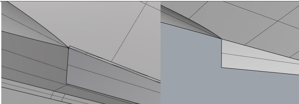
Slika 7.3 Uklanjanje otvora nastalog izrezivanjem oplate dna za kobilicu konačne debljine
