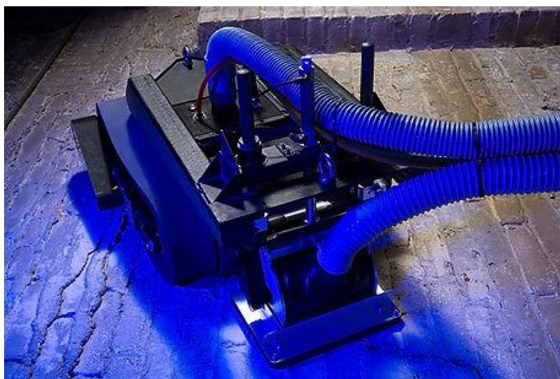
Slika 1. Primjer robota penjača – ICM Climber [1]
