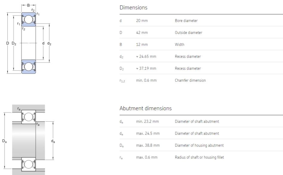
Slika 47. Dimenzije ležaja 6004-2RSH
