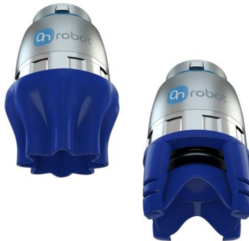
Slika 17. OnRobot hvataljke (lijevo je SG-a, desno je SG-bH) [10]
