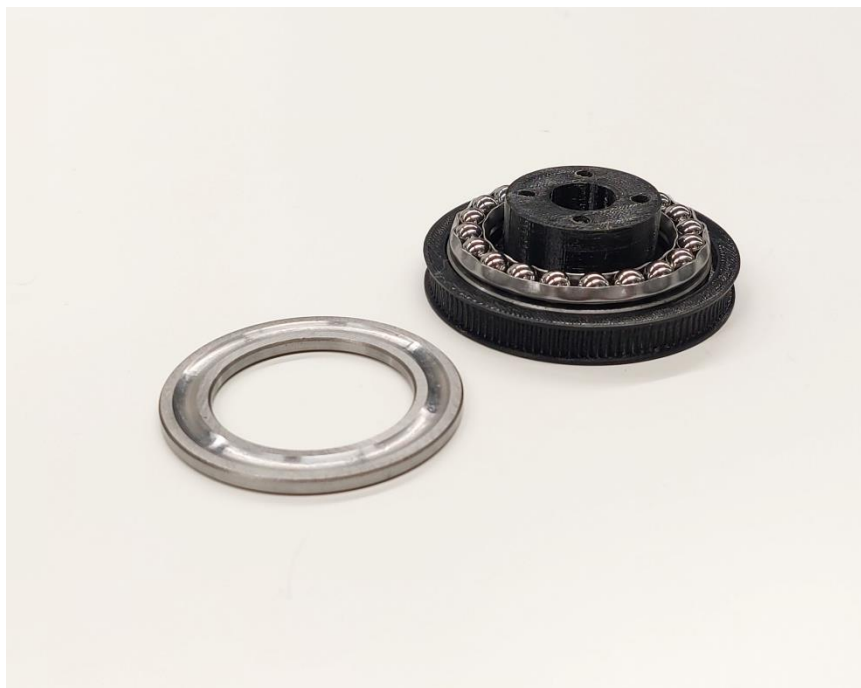
Slika 3.9. GT2 remenica s kugličnim ležajem
